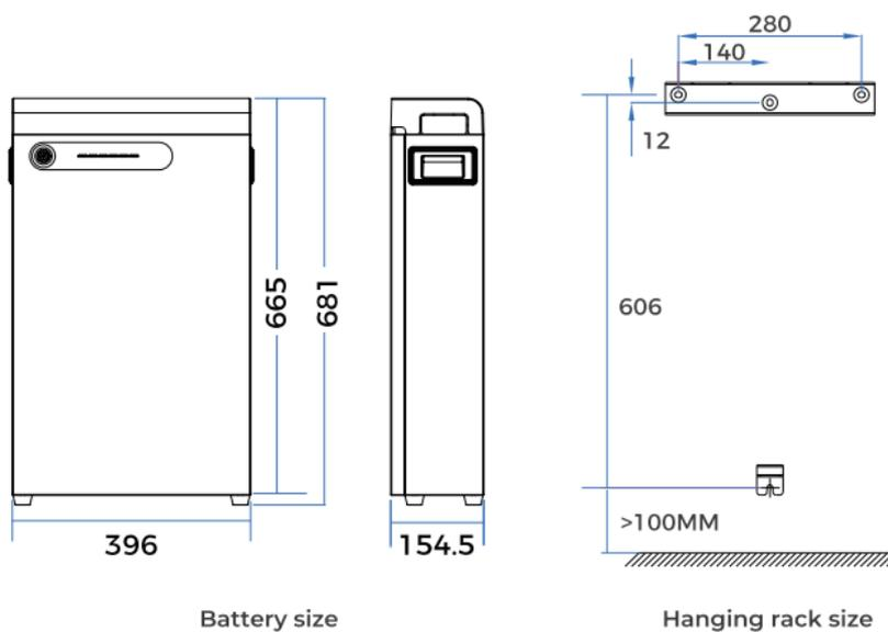
Distanza minima di montaggio tra il pacco batteria e altre apparecchiature:
