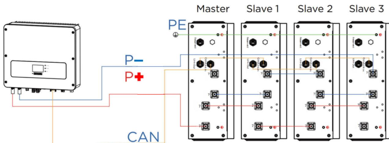
3. Premere a lungo il pulsante di avvio del Master PACK per avviare il sistema di batterie.
