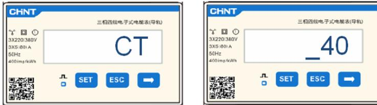
iii. Appuyer sur « ESC » pour confirmer, « → » pour passer au paramètre suivant.
