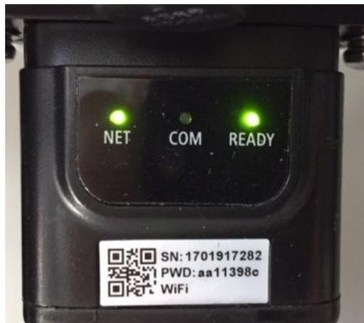
Figure 44 – État de communication irrégulière entre l'onduleur et l'adaptateur
