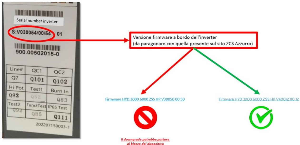
**ATTENTION !!! La rétrogradation de la version du microprogramme de l'onduleur pourrait causer un fonctionnement défectueux.**
