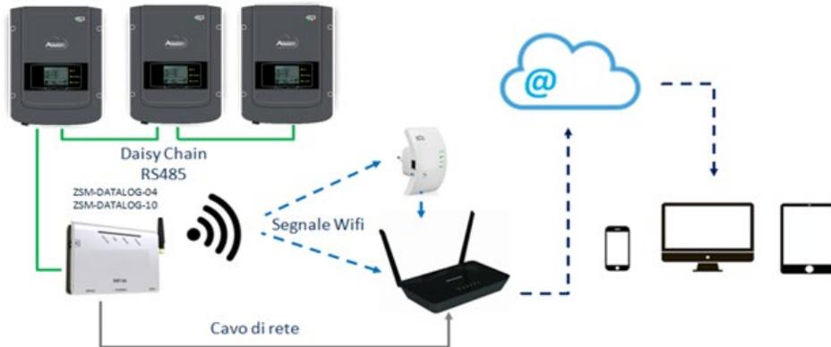
Figure 52 – Schéma de connexion de l'enregistreur de données ZSM-DATALOG-04/ZSM-DATALOG-10
