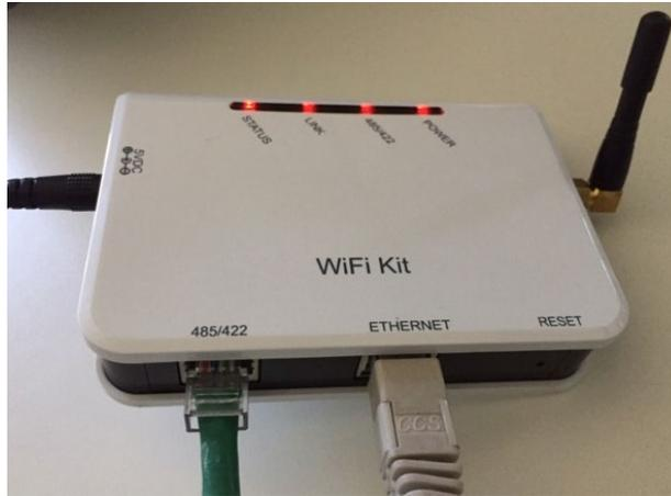
Figure 92 – Câble Ethernet connecté à l'enregistreur de données
