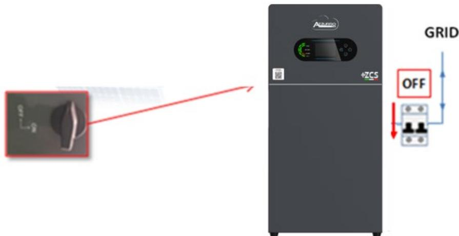
1. Allumer l'onduleur en soulevant l'interrupteur CA.
