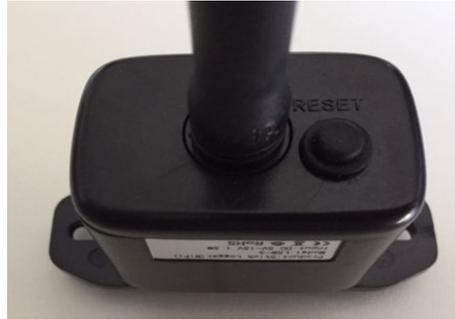
Figure 32 – Bouton de réinitialisation sur l'adaptateur Wi-Fi
