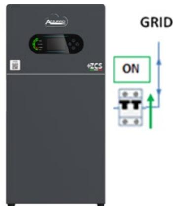
2. Après avoir soulevé l'interrupteur CA, le compte à rebours démarrera en fonction des paramètres du code pays (pour CEI021 – Interne sera de 300 s) pour reconnecter le réseau. Pendant cet intervalle de temps, vérifier que les charges domestiques sont uniquement alimentées par le réseau et qu'il n'y a pas d'autres flux de puissance provenant du système photovoltaïque ou de la batterie.
