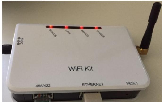
Figure 75 – LED indiquant la configuration correcte de l'enregistreur de données
