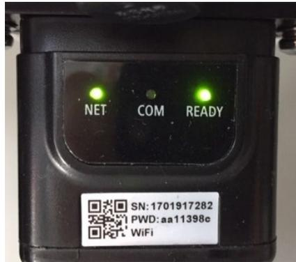
Figure 50 – État de communication irrégulière entre l'onduleur et l'adaptateur
