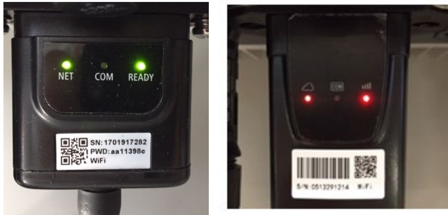
Figure 33 – État de communication irrégulière entre l'onduleur et le Wi-Fi
