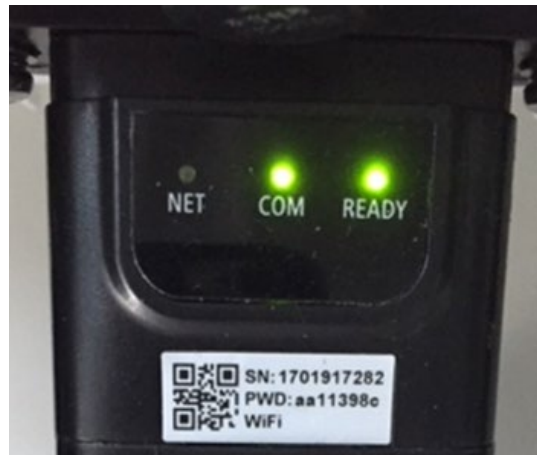
Figure 45 – État de communication irrégulière entre l'adaptateur et le serveur distant
