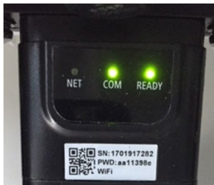
Figure 51 – État de communication irrégulière entre l'adaptateur et le serveur distant
