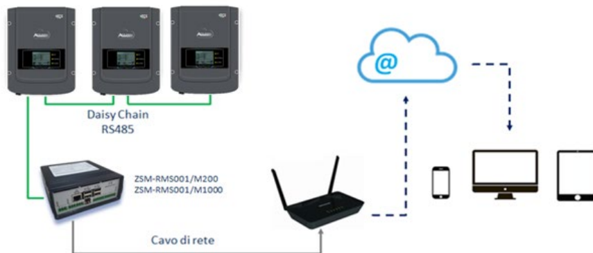
Figure 53 – Schéma illustrant le fonctionnement de l'enregistreur de données ZSM-RMS001/M200 / ZSM-RMS001/M1000
