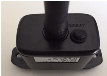
Abbildung 92 - Reset-Taste am WiFi-Adapter
