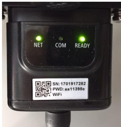
Abbildung 93 – Unregelmäßiger Kommunikationsstatus zwischen Wechselrichter und WiFi
