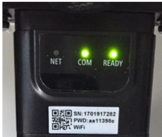
Abbildung 105 – Unregelmäßiger Kommunikationsstatus zwischen Adapter und Remote Server
