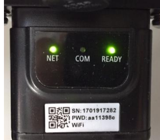
Abbildung 110 - Unregelmäßiger Kommunikationsstatus zwischen Wechselrichter und Adapter
