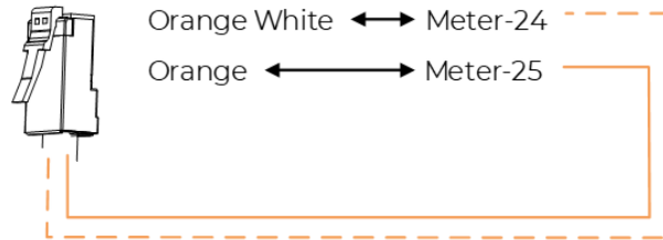
Abbildung 59 - Anschluss an den seriellen COM-Port mit mehr als einem DTSU-Zähler
