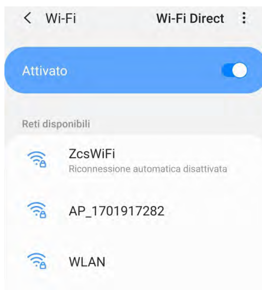
Figura 63 - Disabilitazione della riconnessione automatica a una rete
