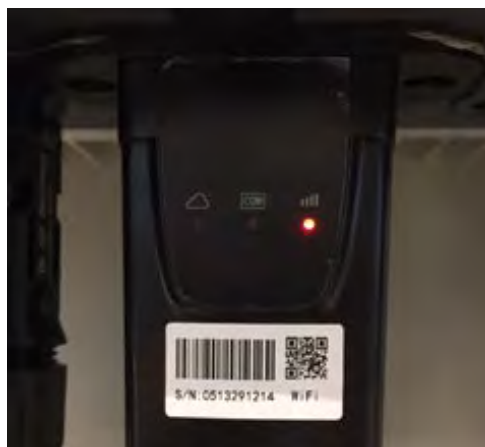
Figura 81 - Stato di comunicazione irregolare tra Wi-Fi e server remoto
