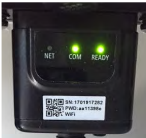
Figura 81 - Stato di comunicazione irregolare tra Wi-Fi e server remoto
