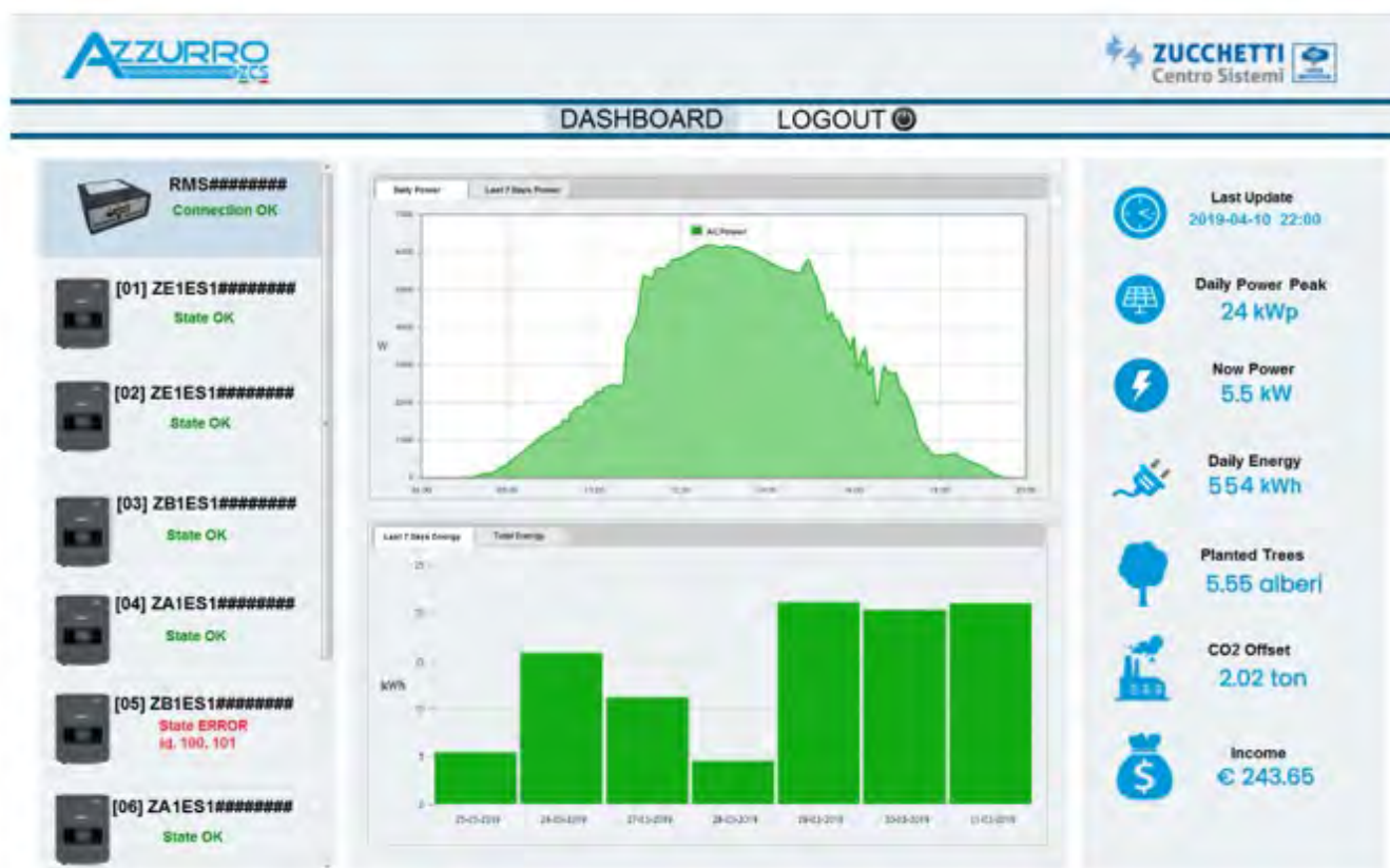
Figura 126: Esempio di pagina di monitoraggio locale
