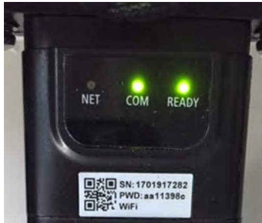
Figura 91 - Stato di comunicazione irregolare tra adattatore e server remoto
