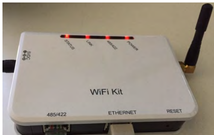
Figura 121 - LED che indica la corretta configurazione del datalogger
