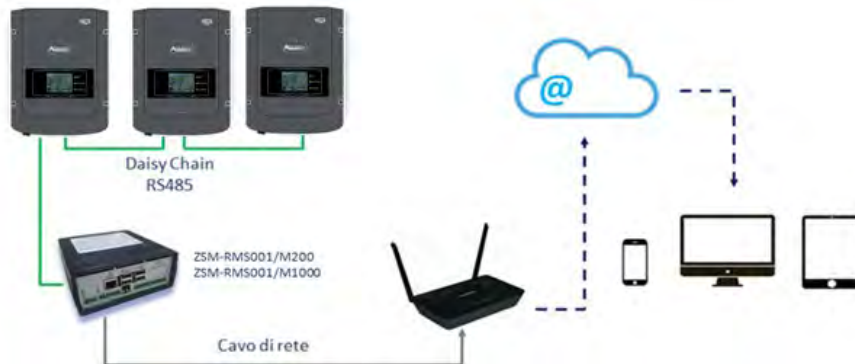
Figura 99 – Schema che mostra il funzionamento del datalogger ZSM-RMS001/M200 / ZSM-RMS001/M1000
