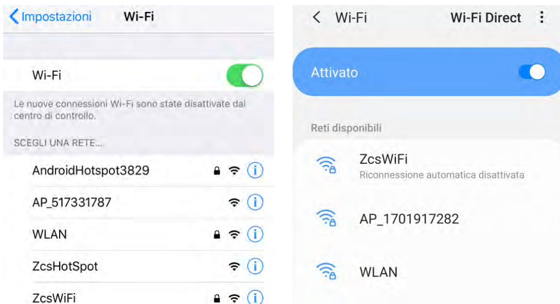
Figura 109 - Ricerca delle reti Wi-Fi su smartphone iOS (sinistra) e smartphone Android (destra)
