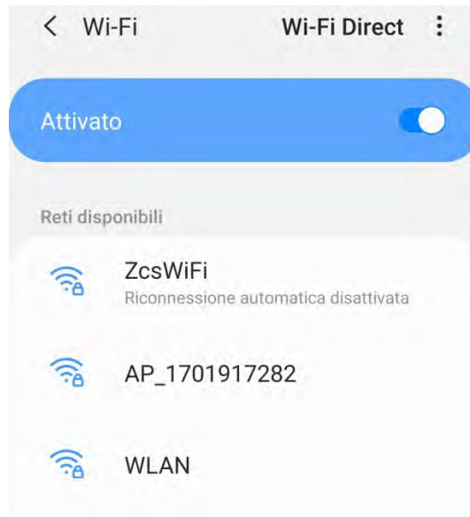
Figura 110 - Disabilitazione della riconnessione automatica a una rete
