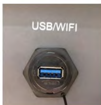
Figura 60- Porta per adattatore Wi-Fi esterno
