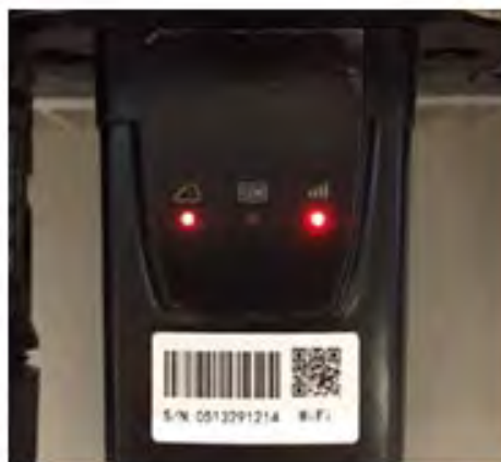
Figura 79 - Stato di comunicazione irregolare tra inverter e Wi-Fi
