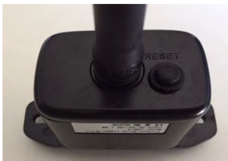
Figura 78 - Pulsante Reset sull'adattatore Wi-Fi
