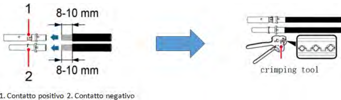
Figura 32 - Preparazione dei cavi fotovoltaici positivo e negativo
