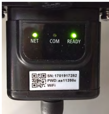
Figura 79 - Stato di comunicazione irregolare tra inverter e Wi-Fi
