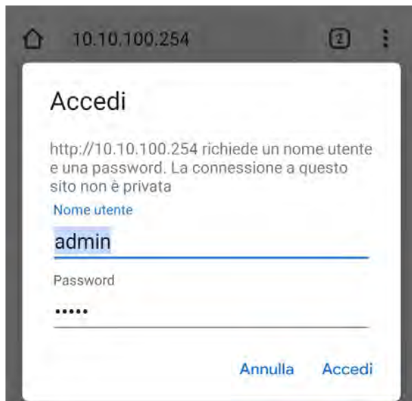
Figura 68 – Schermata di accesso al server Web per configurare l'adattatore Wi-Fi
