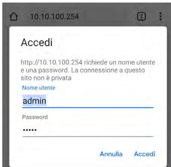
Figura 113 - Schermata di accesso al server Web per configurare il datalogger
