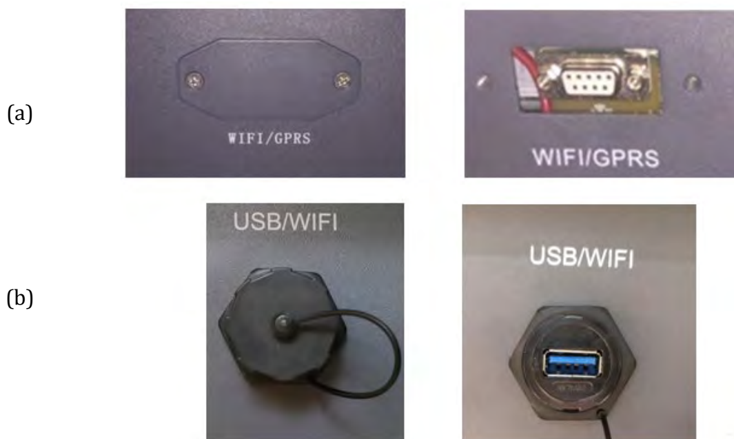
Figura 92 – Porta dell'adattatore 4G
