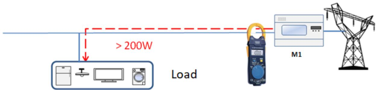
Figura 68 - Verifica assorbimento superiore a 200W
