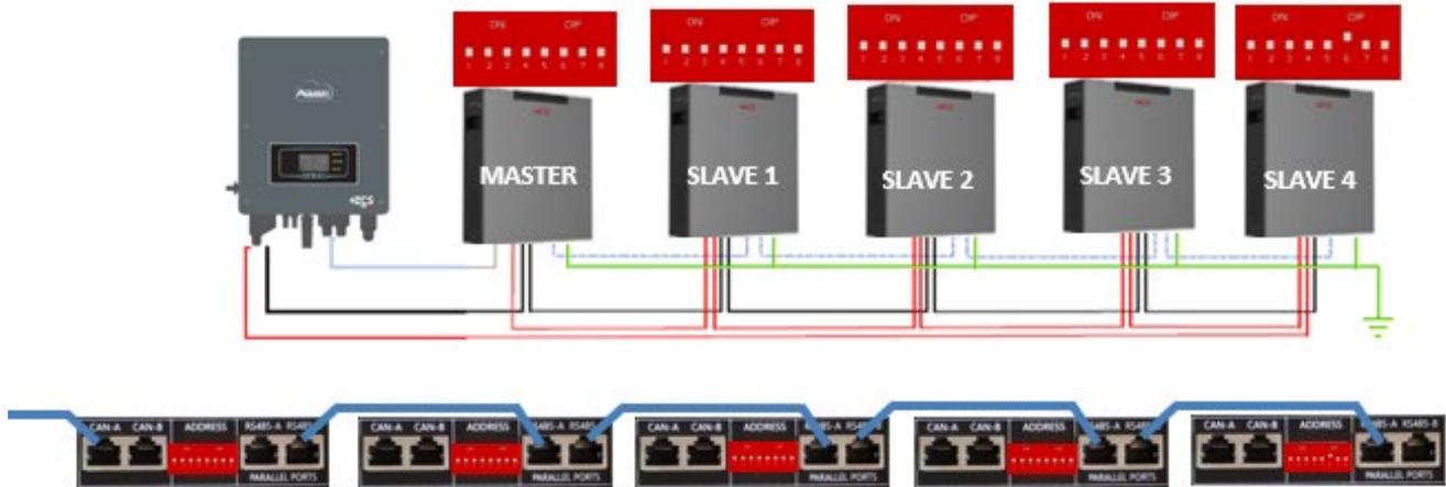
Figura 28 - Parallelo di cinque batterie WeCo 4k4-LT
