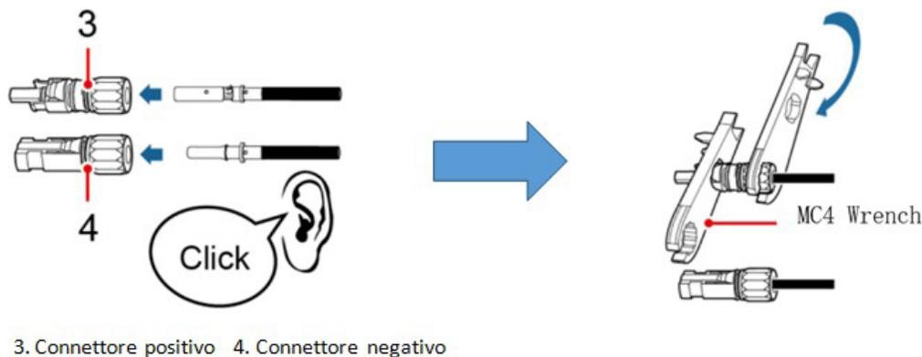
Figura 53 - Preparare i connettori fotovoltaici positivi e negativi
