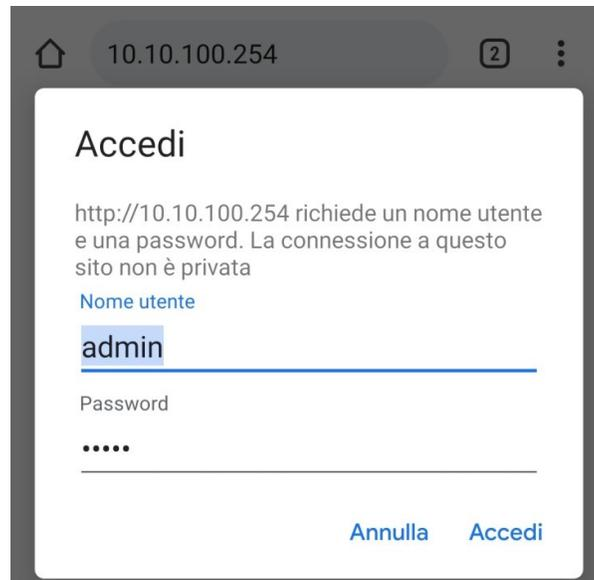
Figura 81 – Schermata di accesso al web server per la configurazione della scheda wifi
