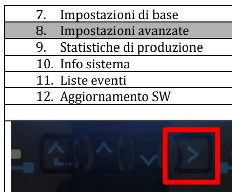
7. A questo punto premere l'ultima freccia a destra per accedere ai parametri batteria
