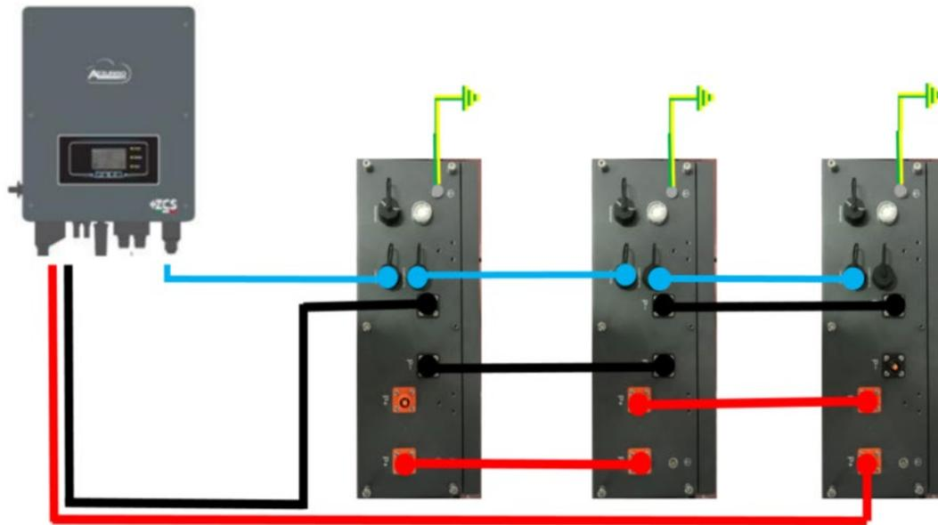
Figura 87 - Collegamento in parallelo di tre batterie AZZURRO 5000 S
