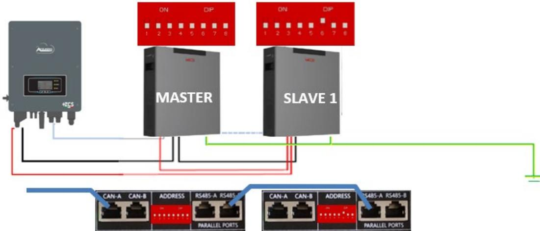
Figura 25 - Parallelo di due batterie WeCo 4k4-LT
