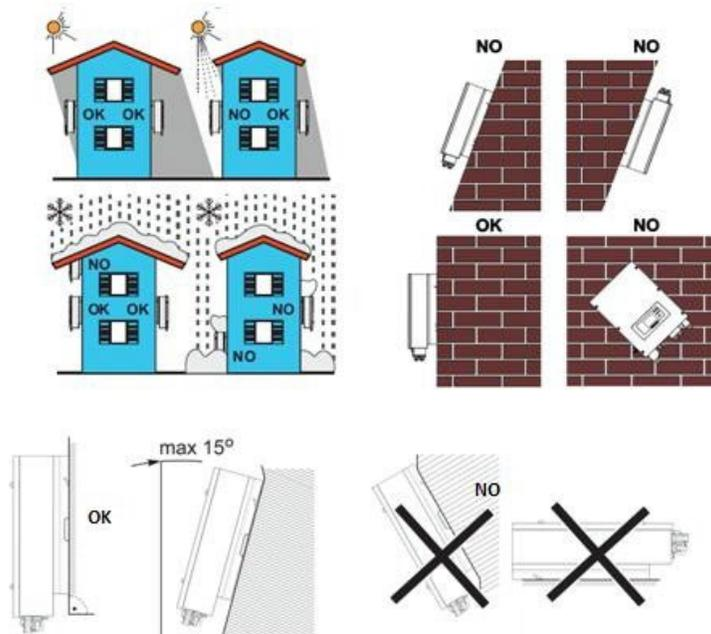
Figura 4 - Posizione di installazione dell'inverter 1PH HYD3000-HYD6000-ZSS
