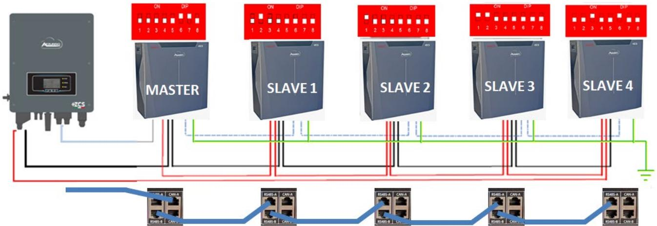
Figura 32 - Parallelo di cinque batterie WeCo 5k3
