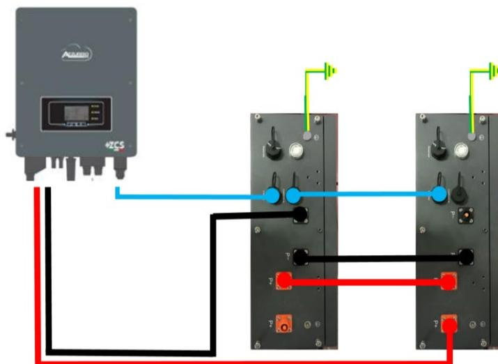
Figura 86 – Collegamento in parallelo di due batterie AZZURRO 5000 S
