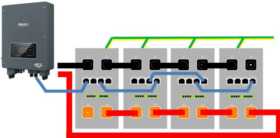
Figura 51 - Parallelo di quattro batterie AZZURRO 5000 PRO
