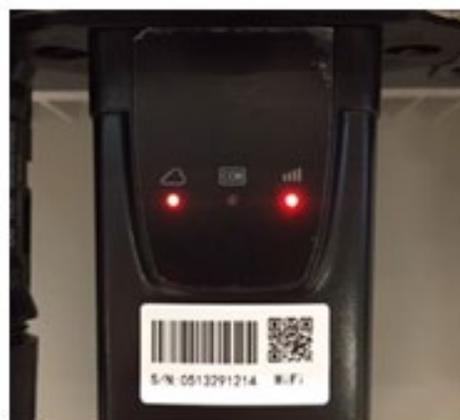
Figura 93 - Stato di comunicazione irregolare tra inverter e wifi
