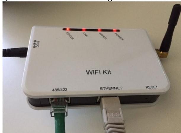
Figura 119 - Cavo ethernet connesso al datalogger
