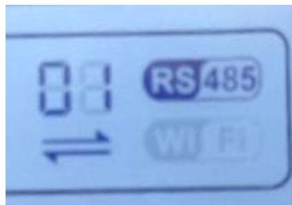
Figura 118 - Simbolo RS485 sul display dell'inverter
