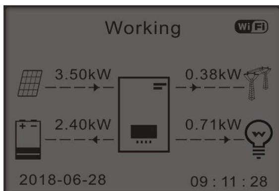
4) Se la produzione fotovoltaica < consumo del CARICO, scaricherà la batteria per fornire energia al carico.
