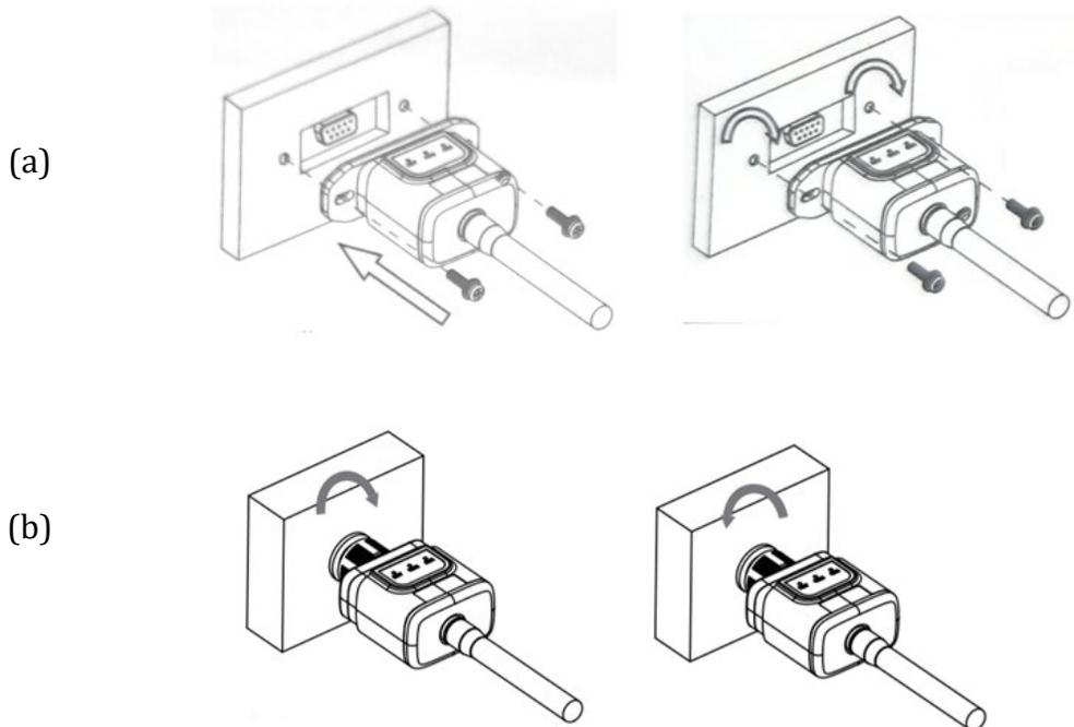
Figura 74 - Inserimento e fissaggio della scheda wifi esterna
