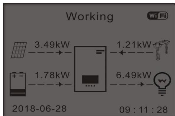
Premere il pulsante “GIÙ” per visualizzare i parametri di rete/batteria correnti, premere “SU” per tornare all’interfaccia principale.
