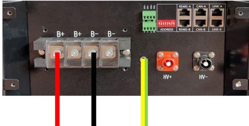
Figura 27 - Connessione batteria WeCo 5k3
