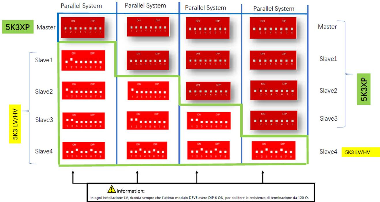
Figura 43 - Collegamento in parallelo di catterie WeCo 5K3XP e WeCo 5K3XP (esempio 1)
