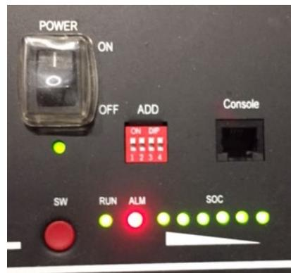
Figura 69 - Stato della batteria dopo aver posizionato lo switch POWER su ON ed aver premuto il tasto SW
