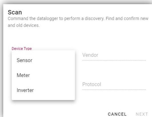
Nel caso in cui tra i dispositivi connessi al proprio Datalogger ci sia un Meter si dovrà selezionare il tipo di interfaccia di comunicazione meter/Datalogger e il relativo protocollo di comunicazione.
