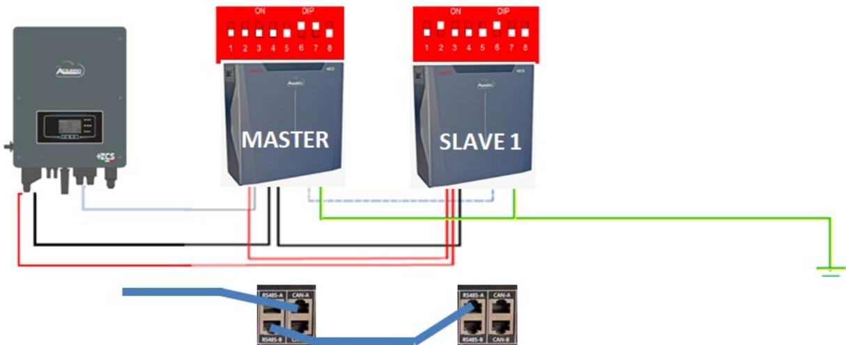
Figura 29 - Parallelo di due batterie WeCo 5k3
