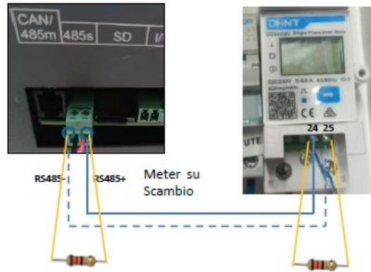
5. Collegare il Meter nella modalità «inserzione diretta» nel dettaglio:
