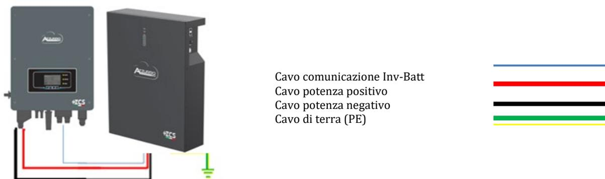
Figura 45 - Connessione batteria AZZURRO ZSX 5120
