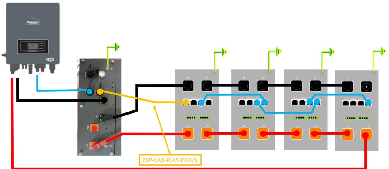
Figura 9 - Collegamento in parallelo di batteria AZZURRO 5000S e AZZURRO 5000/AZZURRO 5000PRO
