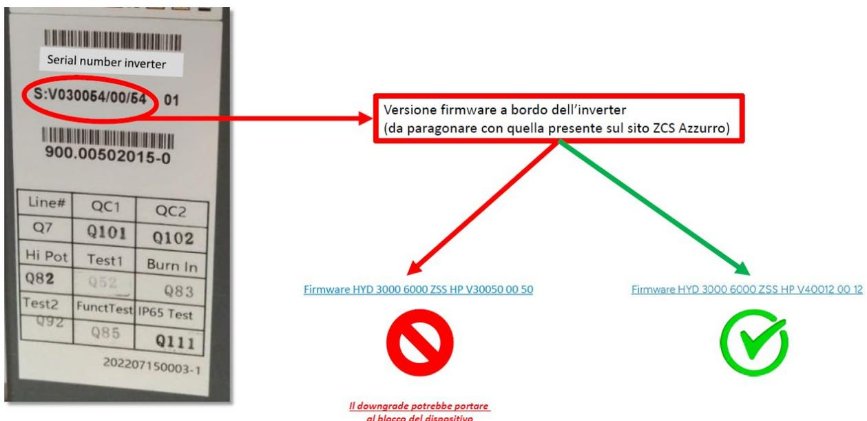
**ATTENZIONE!! Il downgrade della versione firmware dell’inverter potrebbe portare al guasto del dispositivo.**
