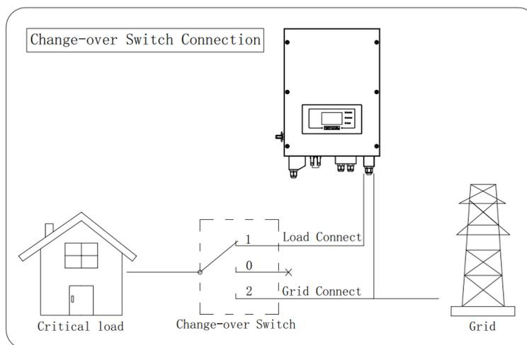
Figura 65 – Collegamenti commutatore
