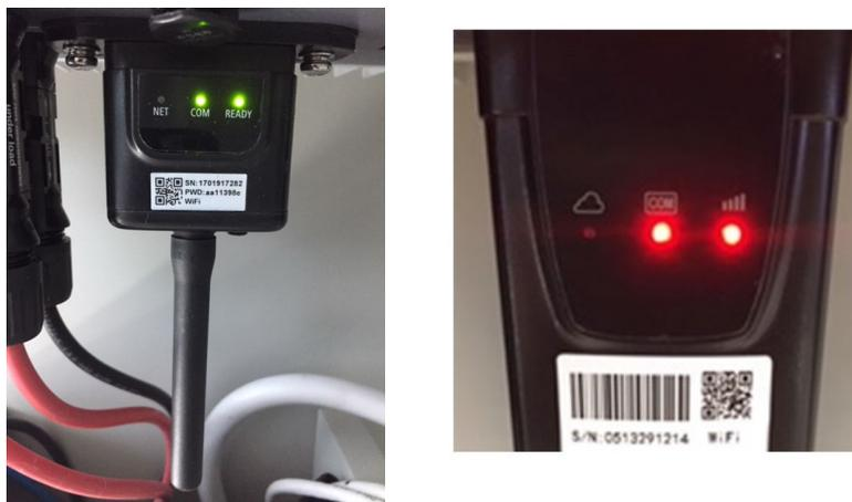
Figura 90 - Stato iniziale dei led
