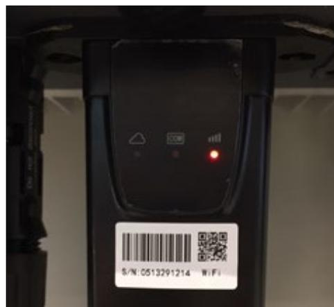
Figura 95 – Stato di comunicazione irregolare tra wifi e server remoto
