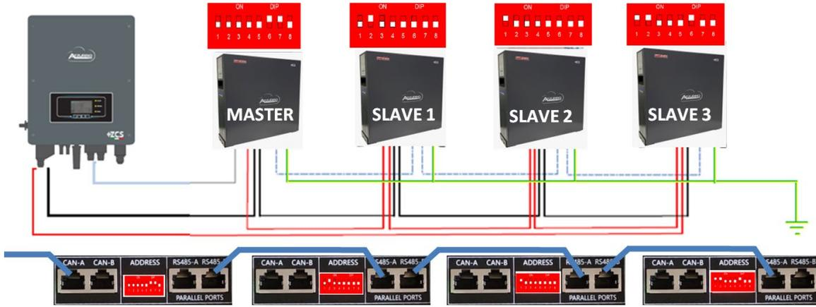
Figura 24 - Parallelo di quattro batterie WeCo 4k4 PRO
