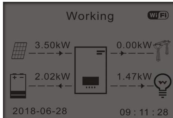
3) Se la batteria è completamente carica (o già alla potenza massima di carica) l'energia in eccesso verrà esportata alla rete.
