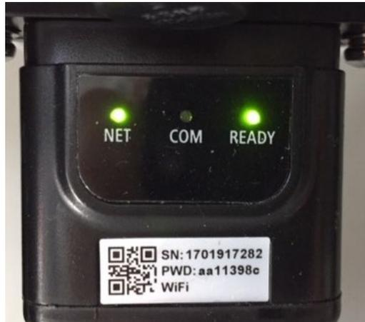
Figura 103 - Stato di comunicazione irregolare tra inverter e scheda
