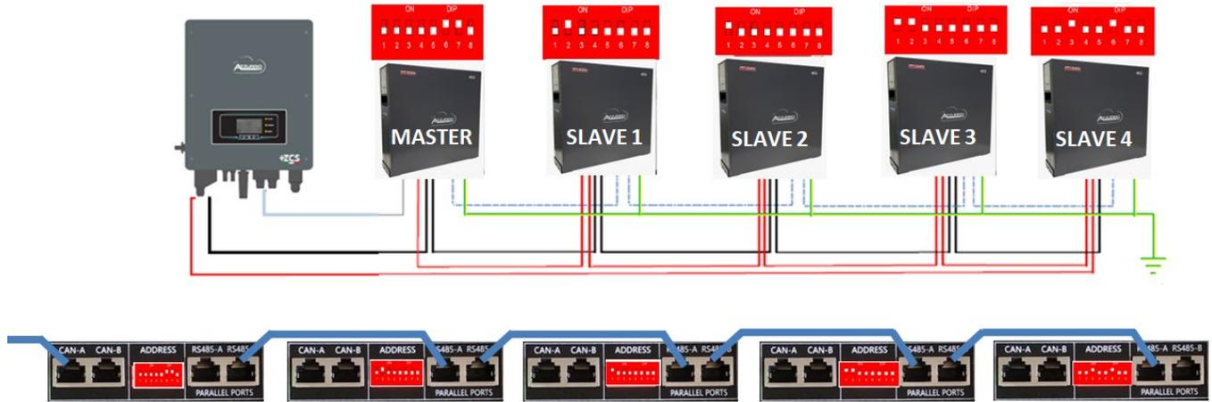
Figura 25 - Parallelo di cinque batterie WeCo 4k4 PRO
