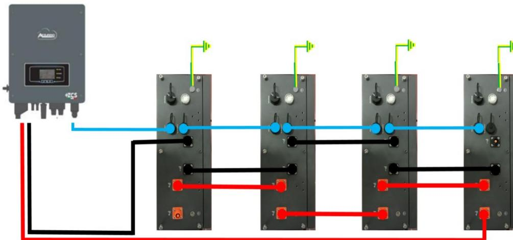
Figura 88 - Collegamento in parallelo di quattro batterie AZZURRO 5000 S
