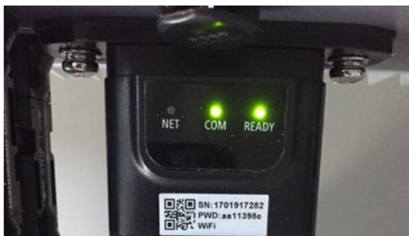
Figura 108 - Stato iniziale dei led
