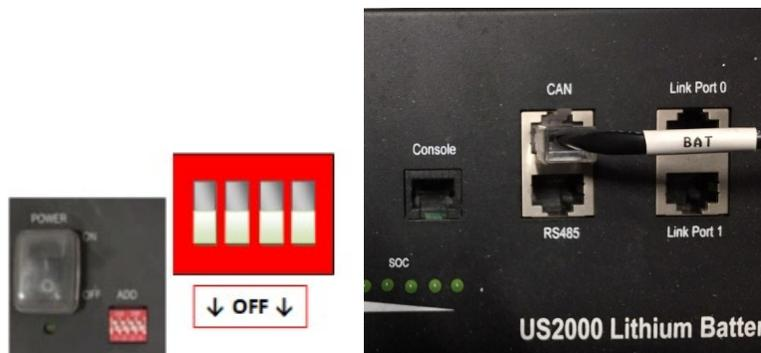
Figura 9 - Connessione cavo di comunicazione sulla batteria Pylontech
