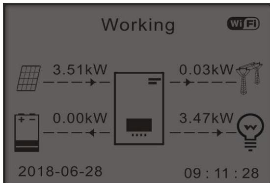
2) Se la produzione fotovoltaica > consumo del CARICO, l'energia in eccesso verrà immagazzinata nella batteria.
