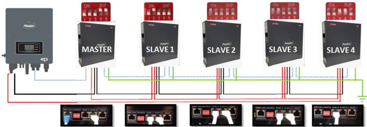
Figura 18 - Parallelo di cinque batterie WeCo 4k4
