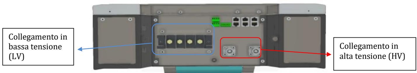
**Attenzione:** Per il collegamento delle batterie 5K3XP con inverter 3000SP o ibrido monofase è obbligatorio utilizzare la sola sezione in bassa tensione. Non utilizzare la sezione in alta tensione onde evitare danneggiamenti di batterie o inverter.
