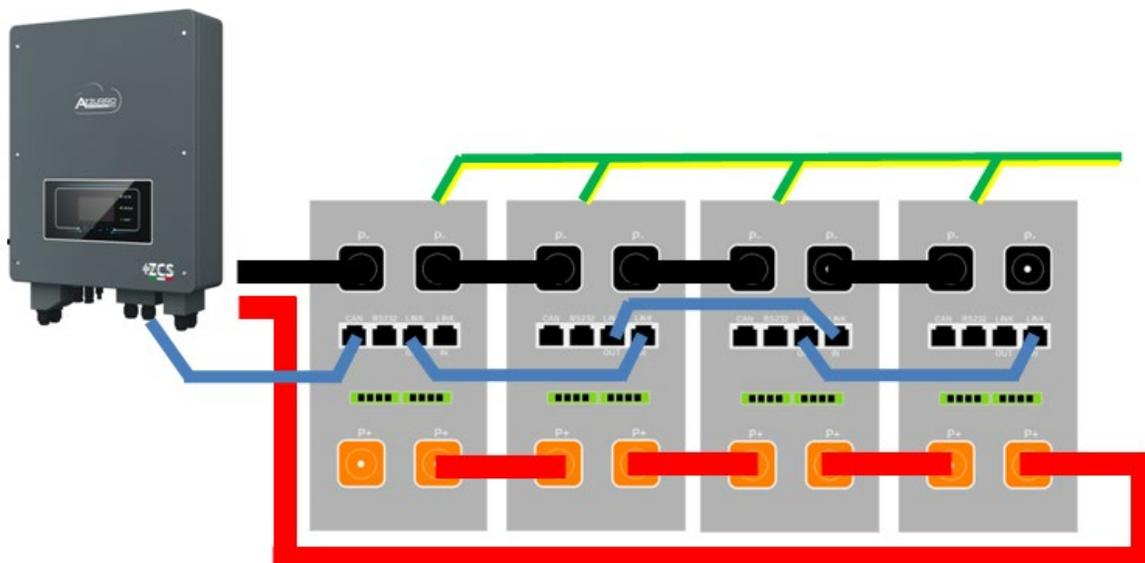
Figura 51 - Parallelo di quattro batterie AZZURRO 5000
