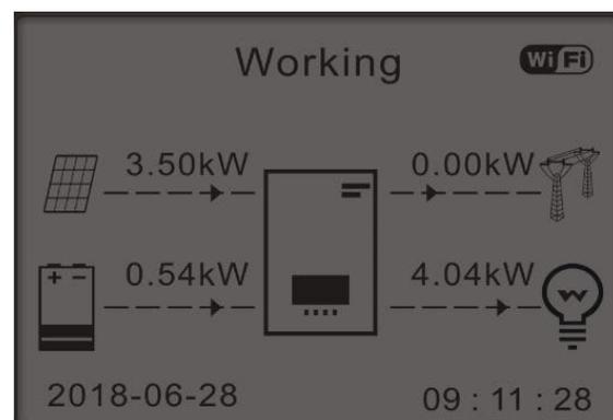
5) Se la produzione fotovoltaica + batteria < consumo del CARICO, l'energia mancante per alimentare i carichi verrà importata dalla rete.
