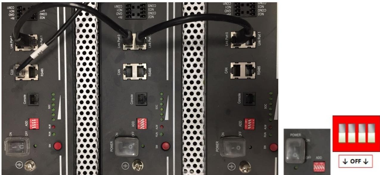
Figura 11 - Connessione di comunicazione tra tre batterie Pylontech
