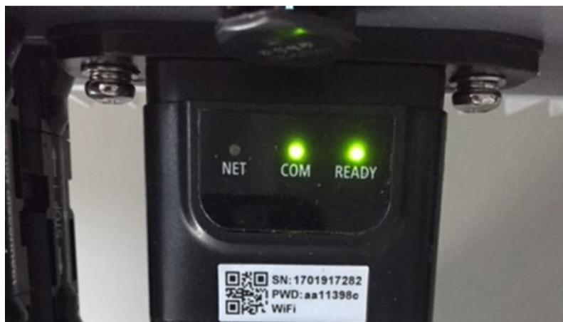
Figura 102 - Stato iniziale dei led
