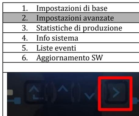
3. A questo punto premere l'ultima freccia a destra per accedere ai parametri batteria
