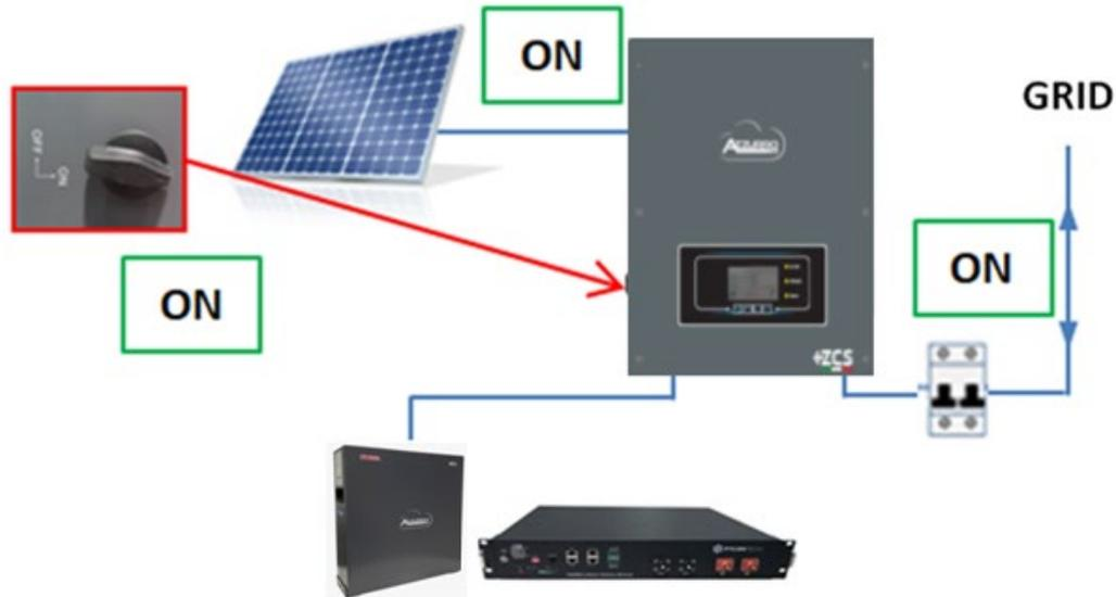
7. Una volta attivato il fotovoltaico, verificare che:
