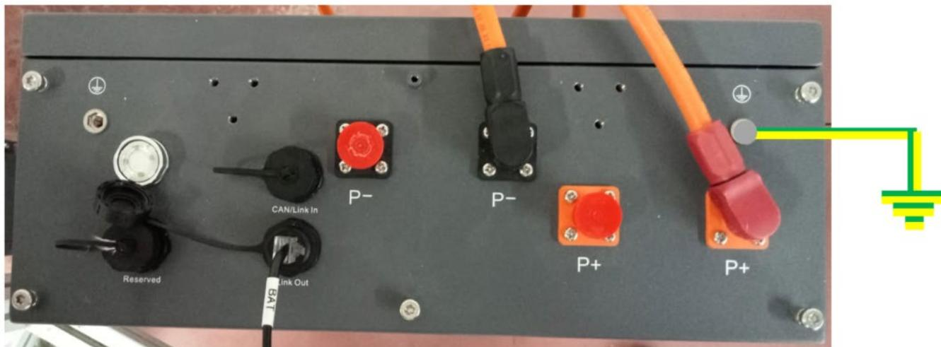
Figura 49 – Morsetti della batteria AZZURRO 5000 S
