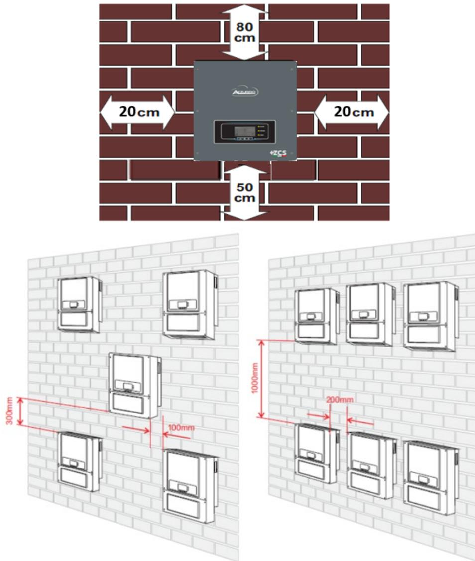
Figura 4 - Posizione di installazione dell'inverter 1PH HYD3000-HYD6000-ZSS
