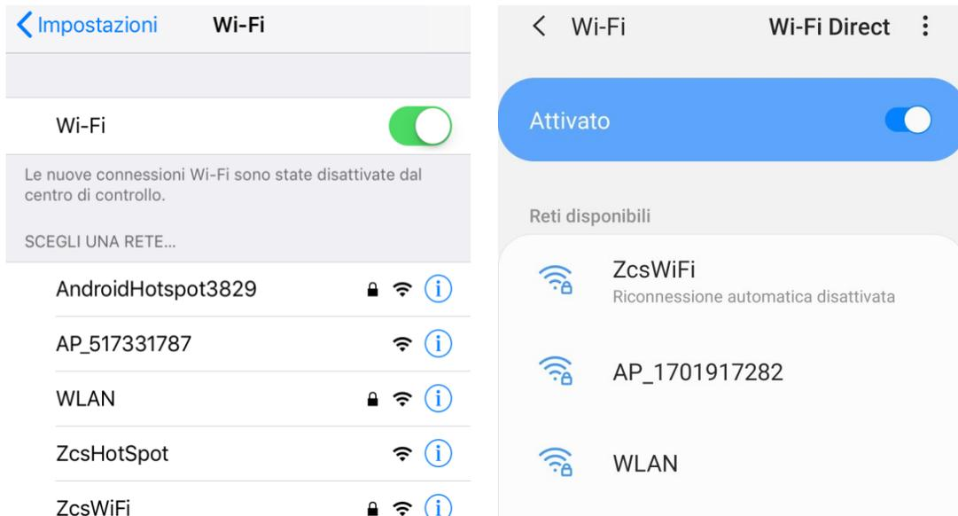
Figura 120 - Ricerca delle rete wifi su Smartphone iOS (a sinistra) e Android (a destra)
