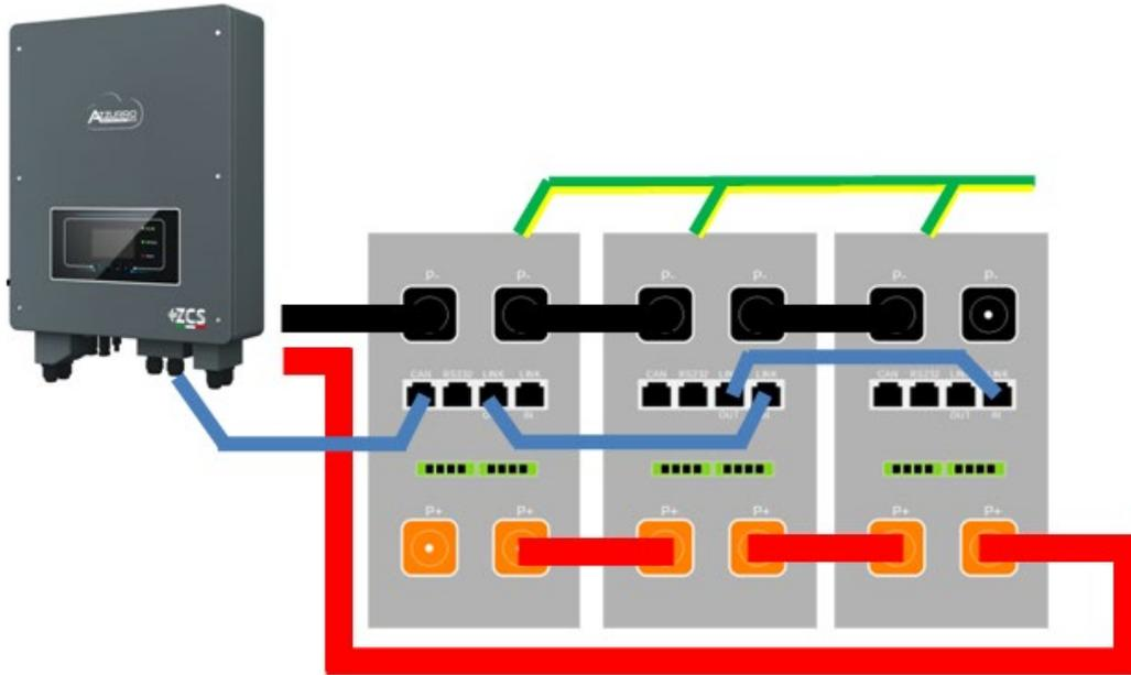
Figura 50 - Parallelo di tre batterie AZZURRO 5000 PRO
