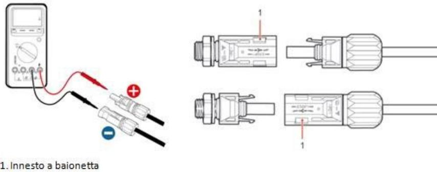
Figura 54 - Collegamento dei connettori fotovoltaici
