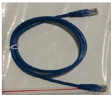
Figura 24 – Cavo di comunicazione fra batterie WeCo 4k4 PRO
