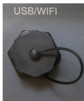
Figura 89 - Alloggiamento della scheda wifi esterna
