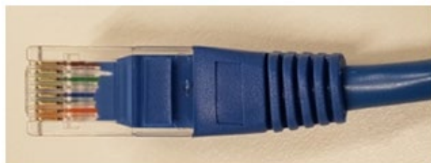
Figura 58 - Estremità del cavo di comunicazione WeCo con morsetto lato inverter nell'ingresso CAN
