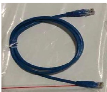
Figura 21 – Cavo di comunicazione tra batterie AZZURRO 5000S
