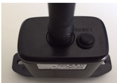
Figura 107 - Tasto di reset sulla scheda wifi
