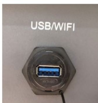
Figura 89 - Alloggiamento della scheda wifi esterna
