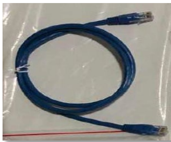
Figura 17 – Cavo di comunicazione fra batterie WeCo 4k4
