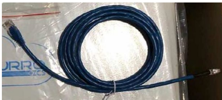
Figura 47 - Cavo di comunicazione fra inverter e batteria AZZURRO 5000 S
