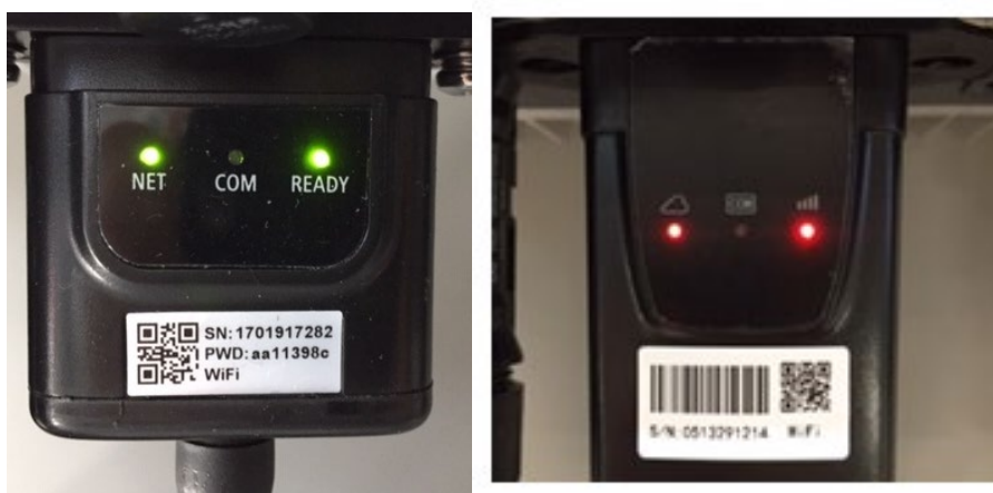
Figura 53 - Stato di comunicazione irregolare tra inverter e Wi-Fi
