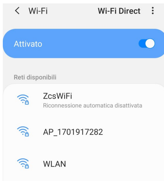
Figura 37 - Disabilitazione della riconnessione automatica a una rete
