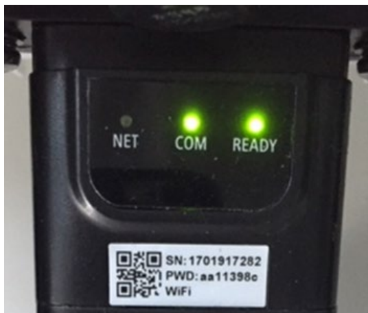
Figura 65 - Stato di comunicazione irregolare tra adattatore e server remoto
