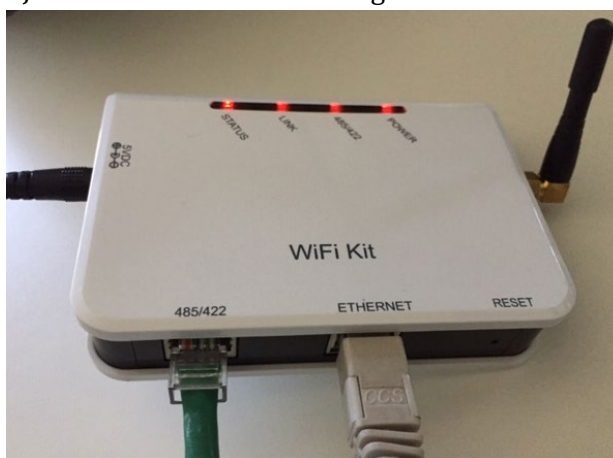
Figura 76 – Cavo Ethernet collegato al datalogger
