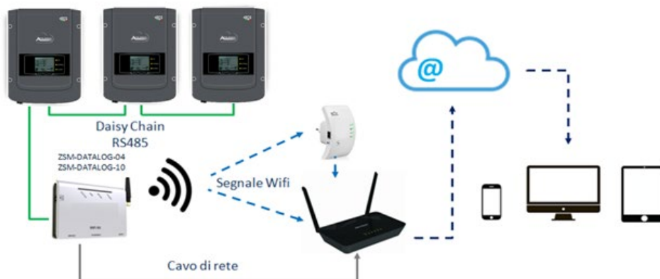
Figura 66 – Schema per il collegamento del datalogger ZSM-DATALOG-04 / ZSM-DATALOG-10
