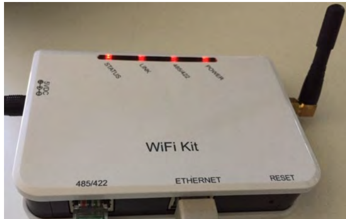
Figura 95 – LED che indica la corretta configurazione del datalogger
