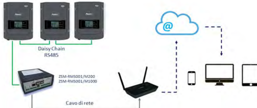
Figura 73 – Schema che mostra il funzionamento del datalogger ZSM-RMS001/M200 / ZSM-RMS001/M1000
