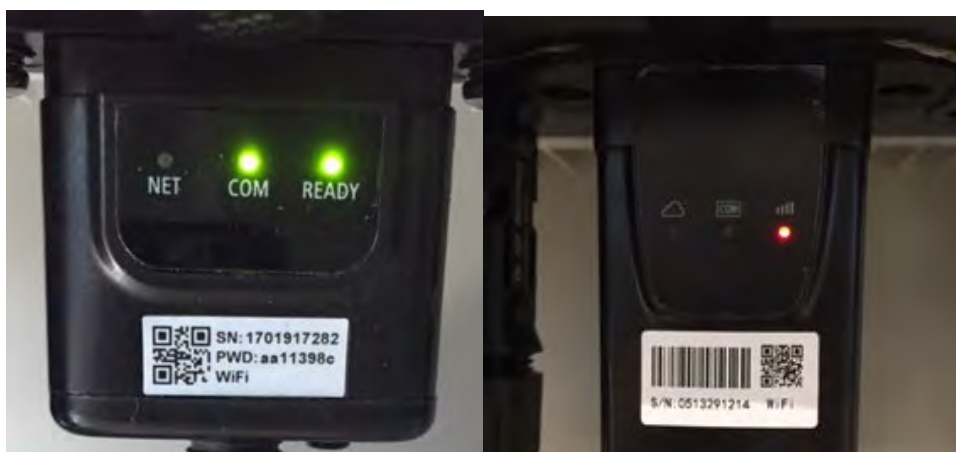
Figura 55 - Stato di comunicazione irregolare tra Wi-Fi e server remoto
