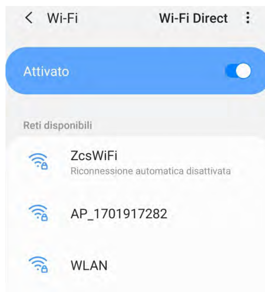
Figura 84 - Disabilitazione della riconnessione automatica a una rete
