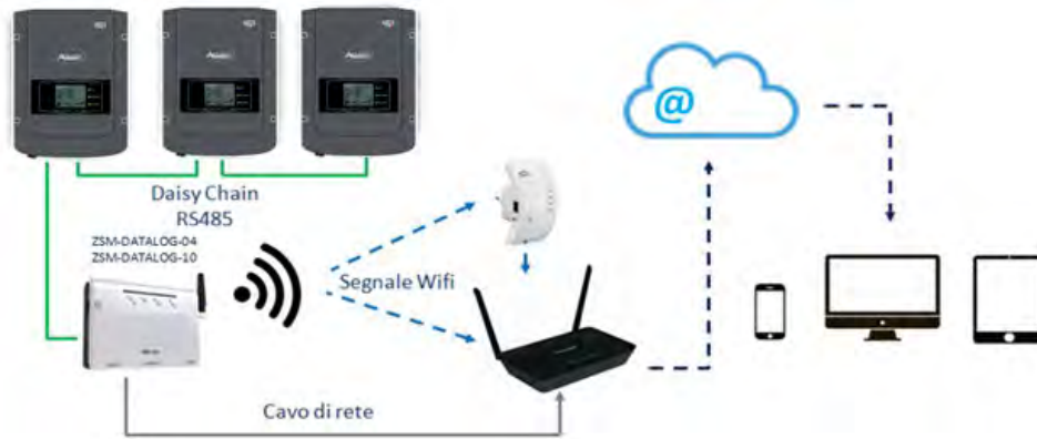
Figura 72 – Schema per il collegamento del datalogger ZSM-DATALOG-04 / ZSM-DATALOG-10
