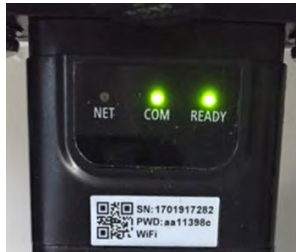
Figura 5-60 - Stato di comunicazione irregolare tra l'adattatore e il server remoto
