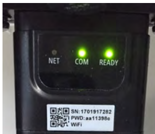
Figura 5-63 - Stato di comunicazione irregolare tra adattatore e server remoto
