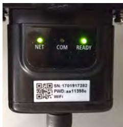
Figura 5-52 - Stato di comunicazione irregolare tra inverter e Wi-Fi
