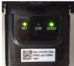
Figura 5-59 - Stato di comunicazione irregolare tra l'inverter e l'adattatore
