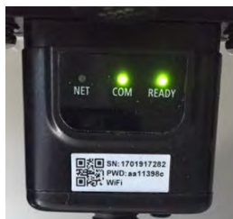
Figura 5-54 - Stato di comunicazione irregolare tra Wi-Fi e server remoto
