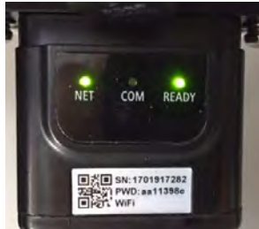
Figura 5-62 - Stato di comunicazione irregolare tra inverter e adattatore
