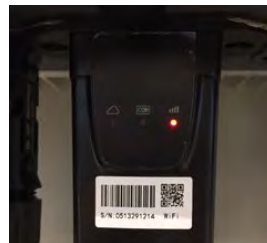
Figura 5-54 - Stato di comunicazione irregolare tra Wi-Fi e server remoto
