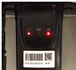
Figura 5-52 - Stato di comunicazione irregolare tra inverter e Wi-Fi
