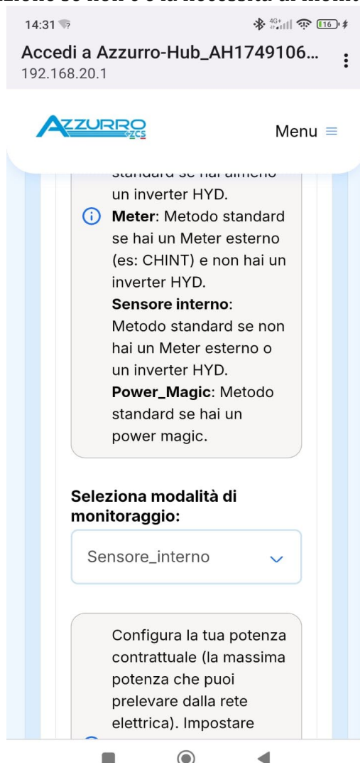
Figura 12 - modalità di misura scambio
