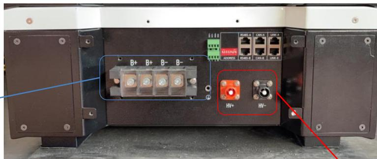
Abschnitt für den Niederspannungsanschluss (LV)
