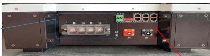
Abschnitt für den Hochspannungsanschluss (HV)
