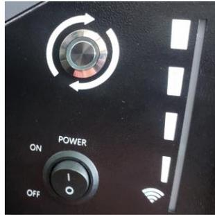
2. Muss der drehbare DC-Trennschalter auf OFF eingestellt sein;
