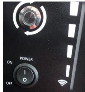
4. **NUR die Master**-Batterie einschalten, indem Sie die Schaltfläche gedrückt halten, bis die Hintergrundbeleuchtung des Led aufleuchtet;
