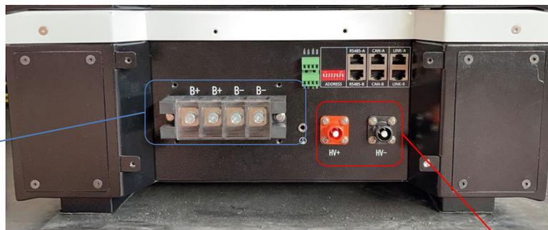
Abschnitt für den Niederspannungsanschluss (LV)
