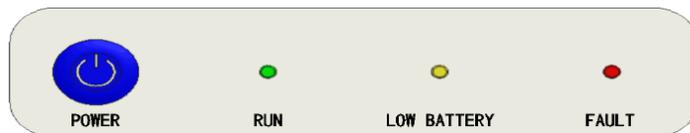
Zum Einschalten von **Pylontech**: den Schalter am vorderen Teil **aller Batterien** auf AN stellen.
