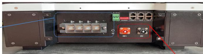
Abschnitt für den Hochspannungsanschluss (HV)
