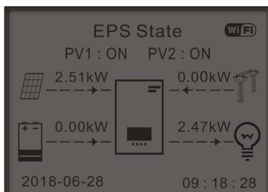
Si la production photovoltaïque = consommation de la CHARGE, l'onduleur HYD-ES ne chargera ou ne déchargera pas la batterie.
