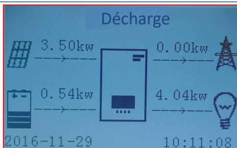
Lorsque la puissance du système photovoltaïque sera inférieure à celle requise par les charges, le système utilisera l'énergie stockée dans la batterie pour alimenter les charges de la maison.
