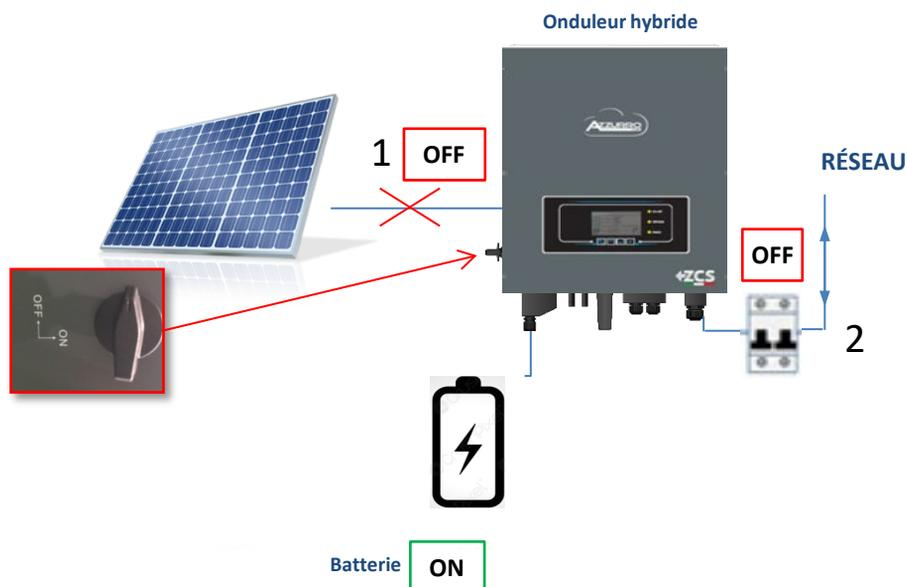
2) Rétablir la tension AC en actionnant l'interrupteur dédié :
