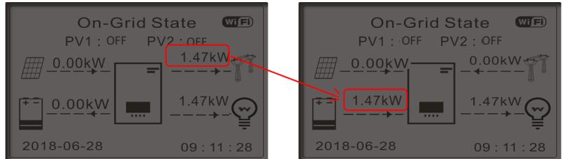
Réactiver le photovoltaïque en tournant le sectionneur DC en position ON.
