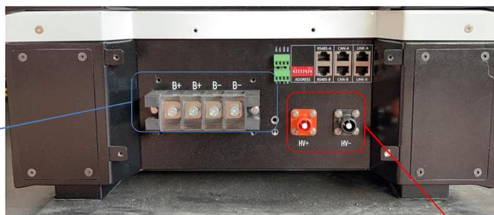
**Attention :** Pour la connexion des batteries 5k3 avec l'onduleur hybride monophasé, il est obligatoire d'utiliser uniquement la section à basse tension. Ne pas utiliser la section à haute tension afin d'éviter les dommages
