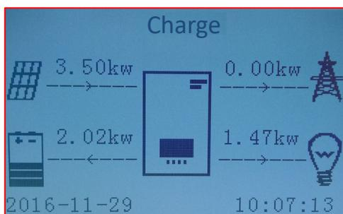
Lorsque la puissance produite par le système photovoltaïque sera supérieure à celle requise par les charges, le Onduleur chargera la batterie avec la puissance excédentaire.
