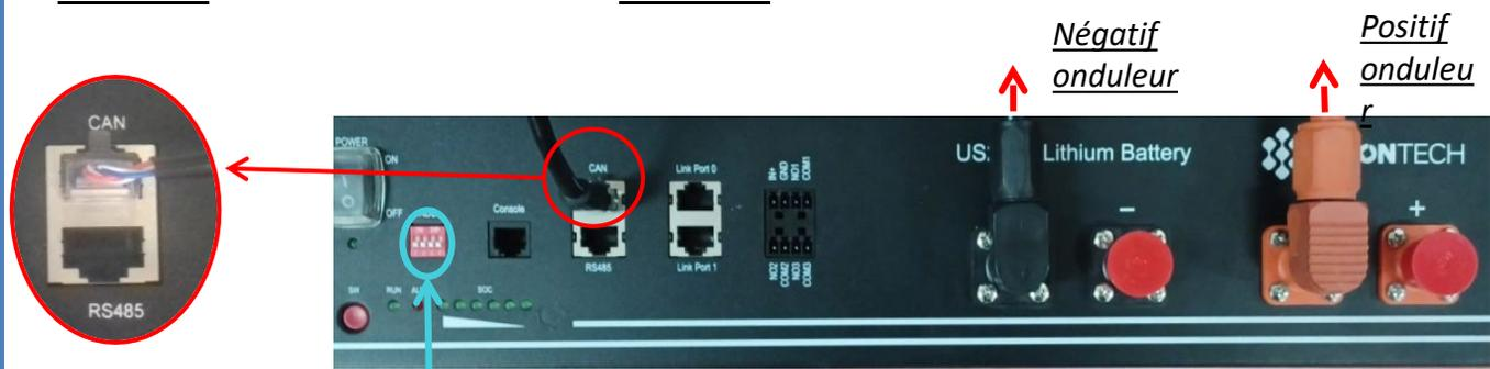
**Remarque :** Les commutateurs DIP doivent être réglés selon les paramètres d'usine, tous en position OFF (00000).
