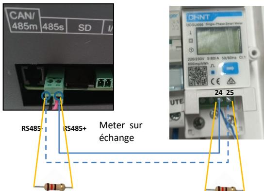
1. Connecter le Meter dans le mode « à insertion directe » dans le détail :
