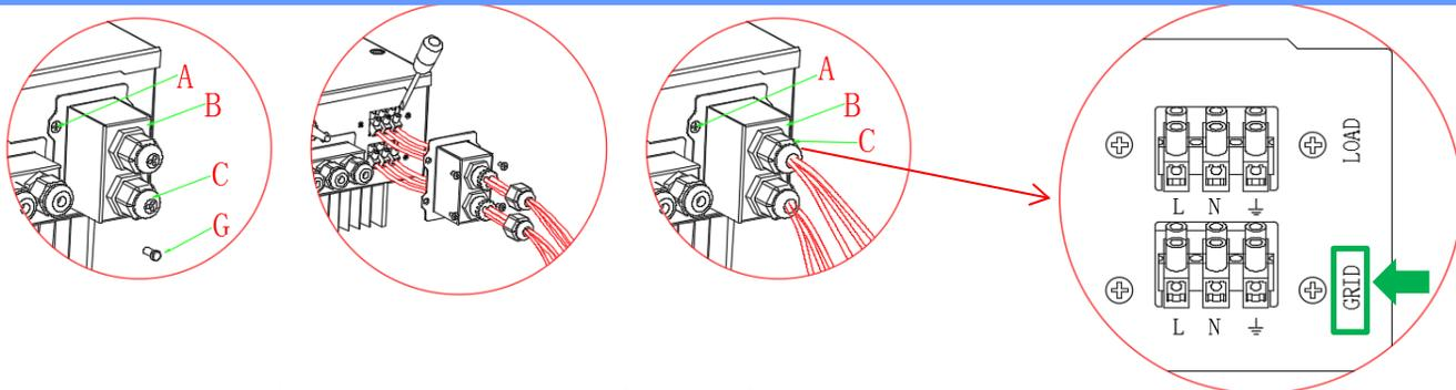
1) Desserrer les 4 vis (A) du couvercle central à l'aide d'un tournevis.
