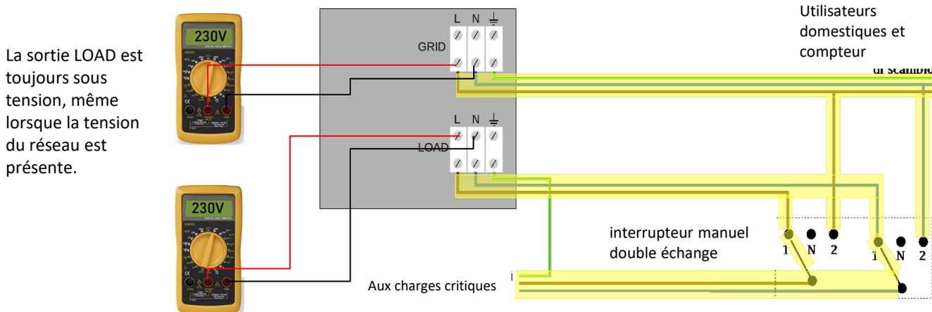
La sortie LOAD est toujours sous tension, même lorsque la tension du réseau est présente.
