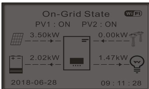
La valeur de consommation  $\overbrace{1.47\text{kW}}$  reste constante\* à mesure que la puissance photovoltaïque augmente.
