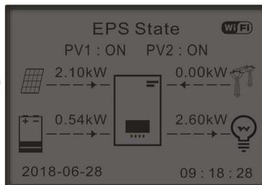
Si la production photovoltaïque < consommation de la CHARGE ( $\Delta P > 100W$ ), l'onduleur HYD-ES déchargera la batterie.
