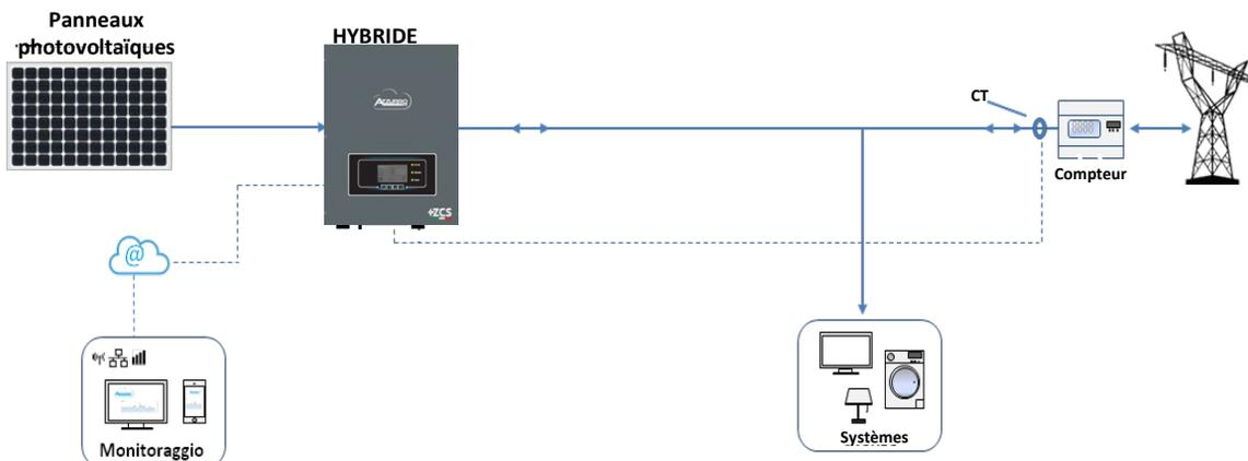
Le système peut également fonctionner comme un onduleur photovoltaïque uniquement et donc sans batteries.
