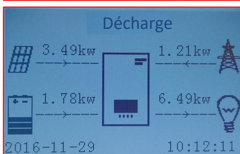
Lorsque la somme entre la puissance produite par le système photovoltaïque et celle fournie par la batterie sera inférieure à celle requise par les charges, la puissance manquante sera puisée depuis le réseau.
