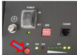
Pour allumer **Pylontech** : mettre sur ON l'interrupteur situé à l'avant de **toutes les batteries**.
