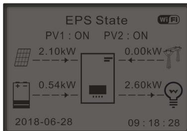
Si la production photovoltaïque > consommation de la CHARGE ( $\Delta P > 100W$ ), l'onduleur HYD-ES chargera la batterie.
