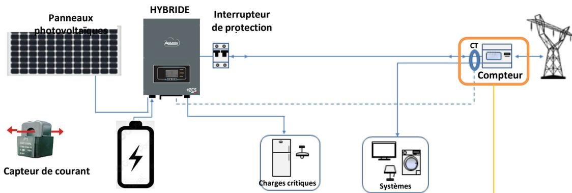
Le capteur doit englober tous les câbles de phase entrant ou sortant du compteur.
