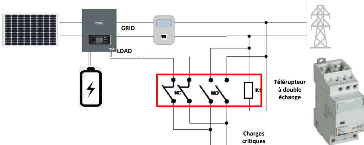
**REMARQUE :** Dans les conditions décrites ci-dessus, en cas de panne de courant, la partie du système alimentée par le port LOAD de l'onduleur se comporte comme un système informatique.
