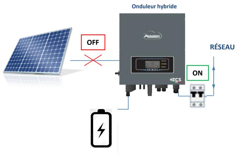
3) Vérifier que la valeur de puissance puisée depuis le réseau sur l'écran est à peu près égale à la valeur de puissance absorbée indiquée par le compteur, ou obtenue en mesurant avec une pince ampèremétrique sous le compteur d'échange.
