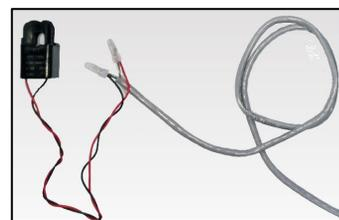
Pour éviter la rupture des fils conducteurs, il est recommandé d'utiliser un câble avec des conducteurs souples et non rigides.
