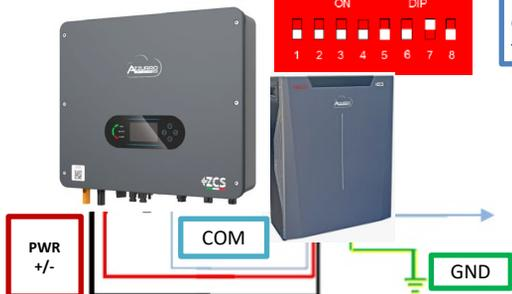
Dans le cas de PLUSIEURS BATTERIES, connecter le câble de communication du port **COM** de l'onduleur au port **CAN-A** de la batterie MAÎTRE après avoir défini le positionnement correct des commutateurs DIP (voir page suivante).
