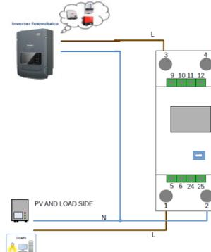
REMARQUE : Pour des **distances** entre Meter et Onduleur hybride **supérieures à 100 mètres**, il est conseillé de connecter le long de la chaîne 485 un résistances de 120 Ohms, directement au Meter (broches 24 et 25).
