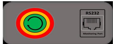
Dans le cas de batteries **WeCo** ou **Azzurro**, mettre l'interrupteur sur 1 (s'il est présent) et appuyer sur le bouton POWER de chaque batterie pendant 1 seconde, le voyant RUN s'allumera et le contacteur interne se fermera automatiquement.
