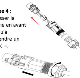
**Étape 5 :** Connecter la borne de charge au port de charge de l'onduleur et pousser la borne en avant jusqu'à entendre un « clic » indiquant que la connexion de la borne est terminée.
