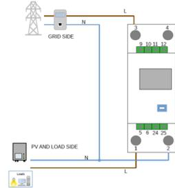
REMARQUE : Pour des **distances** entre Meter et Onduleur hybride **supérieures à 100 mètres**, il est conseillé de connecter le long de la chaîne 485 un résistances de 120 Ohms, directement au Meter (broches 24 et 25).
