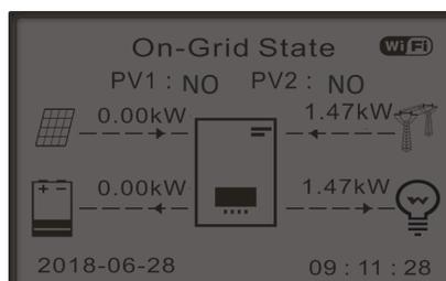
4) Activer photovoltaïque en tournant le sectionneur DC en position ON.
