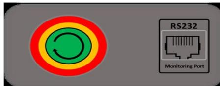
Pour allumer **Pylontech** : mettre sur ON l'interrupteur situé à l'avant de **toutes les batteries**.
