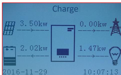
Lorsque la puissance produite par le système photovoltaïque sera supérieure à celle requise par les charges, l'onduleur chargera la batterie avec la puissance excédentaire.
