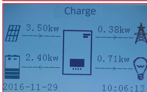
Lorsque la batterie est complètement chargée, ou que la puissance de charge est limitée (afin de préserver l'intégrité de la batterie), la puissance excédentaire sera injectée dans le réseau.
