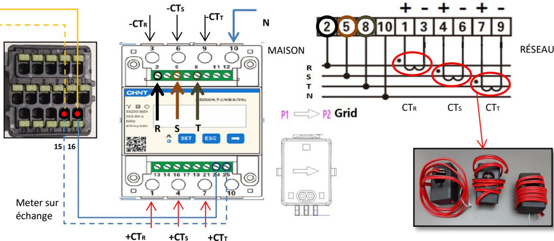
1. Connecter Meter et onduleur via le port série RS485.
