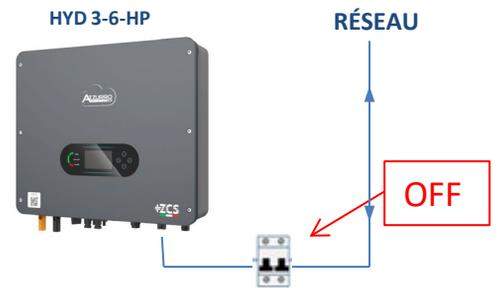
Vérifier que le sectionneur DC présent sur l'onduleur est tourné sur OFF.
