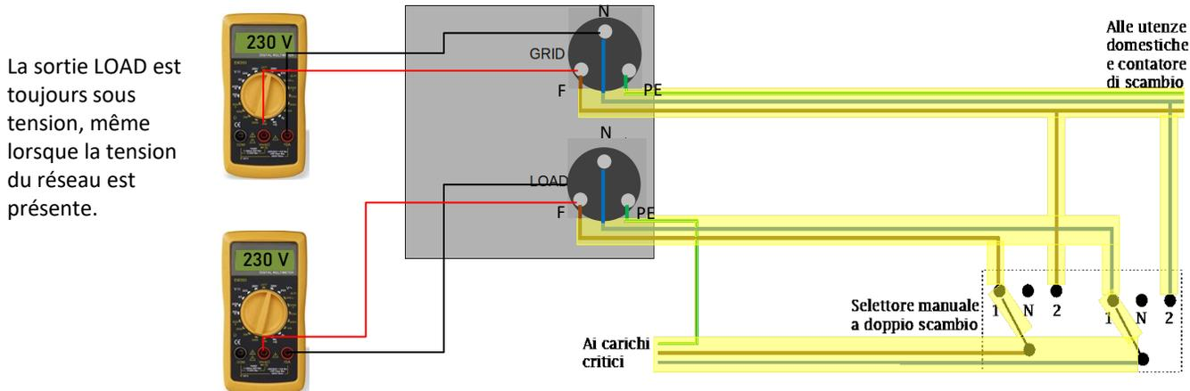
En cas de **panne de courant** électrique, la tension alternative fournie par le réseau électrique manquera ; cette condition commutera les contacts internes de l'onduleur hybride qui, après le temps d'activation, continuera à fournir une tension alternative de 230 V à la sortie LOAD, en n'alimentant que les charges critiques en fonction de la disponibilité des batteries et du photovoltaïque.
