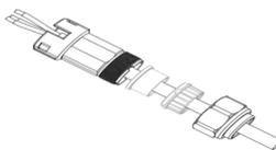
**Étape 3 :** En fonction du signe, bloquer le fil dans le trou du serre-câble sur la borne et le serrer avec la clé Allen.
