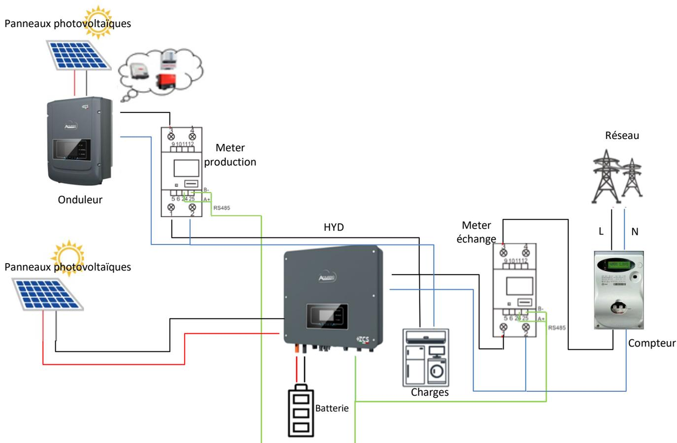
Pour vérifier la lecture correcte du Meter sur l'échange il faut s'assurer que l'onduleur hybride et n'importe quelle autre source de production photovoltaïque soient éteints.
