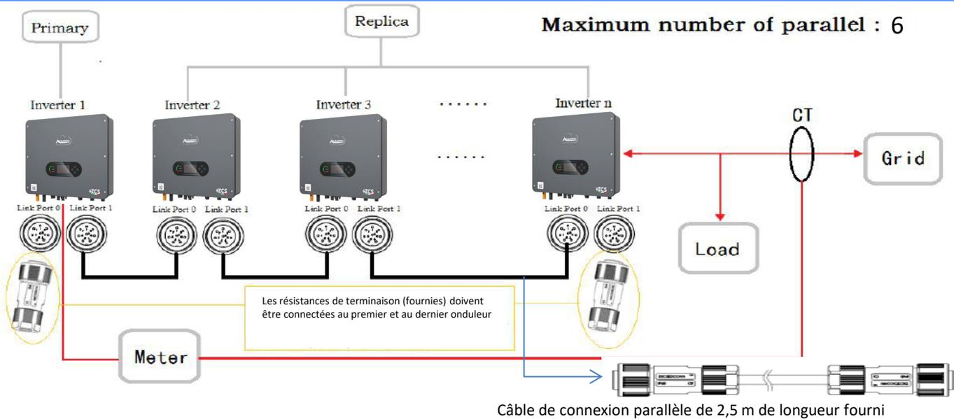
1. Les onduleurs doivent être connectés entre eux en utilisant le câble fourni dans l'emballage en veillant à alimenter les entrées comme ci-après :
