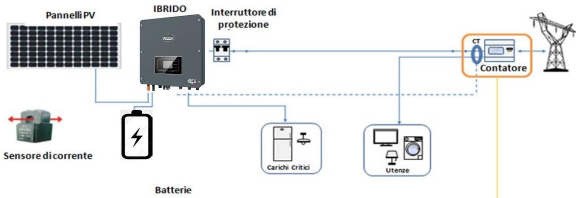
Le capteur doit englober tous les câbles de phase entrant ou sortant du compteur.
