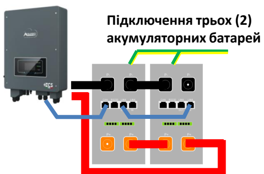
Підключення трьох (4) акумуляторних батарей
