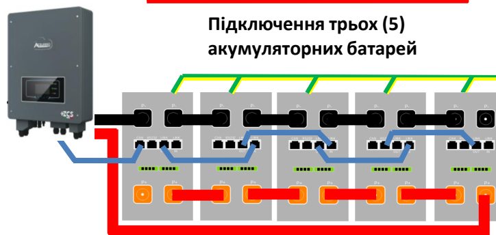
Підключення трьох (4) акумуляторних батарей
