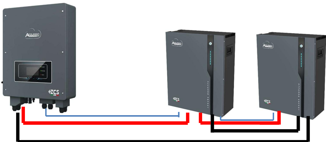
Figure 3 - Exemple de connexions avec 2 batteries
