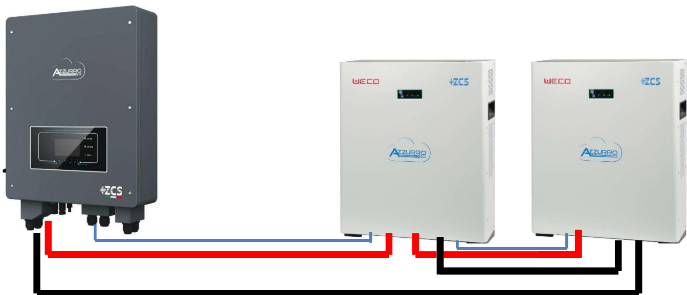
Figure 2 - Exemple de connexions avec 2 batteries
