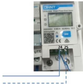
Figure 29 — Connexions des broches du compteur ZSM-METER-DDSU
