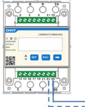
Figure 30 — Connexions des broches du compteur ZSM-METER-DTSU
