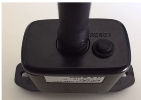
Figure 59 – Bouton Reset sur l'adaptateur Wi-Fi
