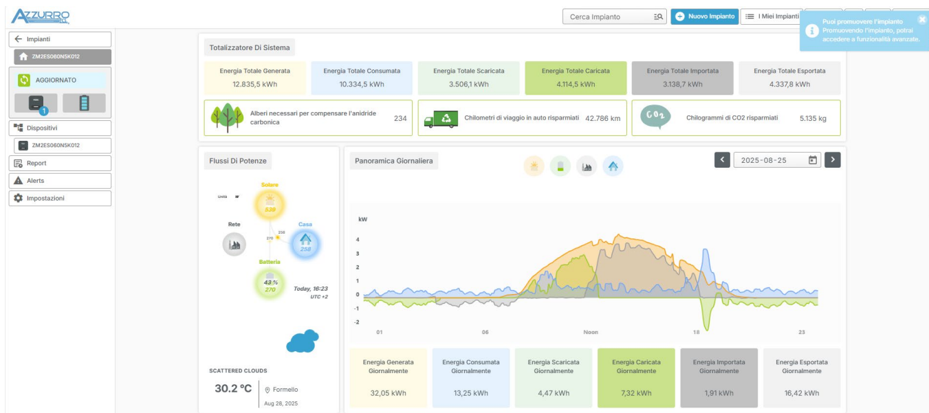
Figure 105 : Exemple de page de surveillance locale (onduleur hybride)
