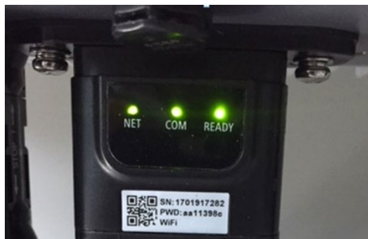
Figure 76 - État final des LED
