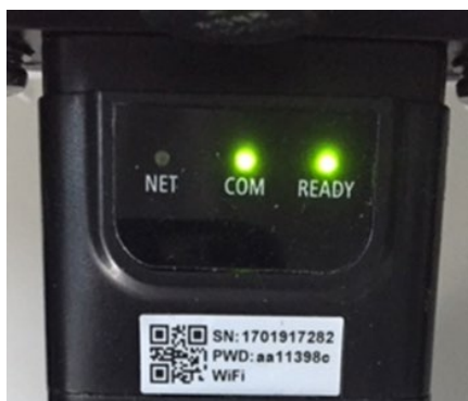
Figure 78 - État de communication irrégulier entre l'adaptateur et le serveur distant
