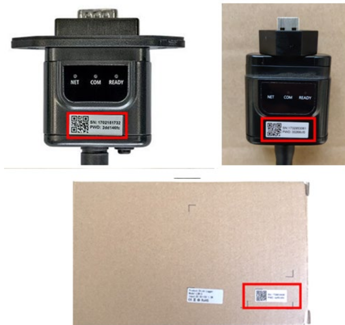
Figure 45 – Mot de passe de l'adaptateur Wi-Fi externe
