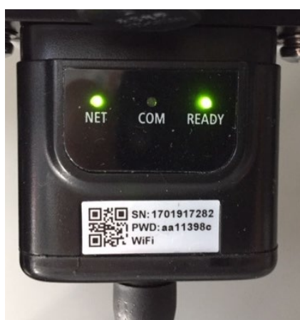
Figure 60 - État de communication irrégulier entre le variateur et le Wi-Fi
