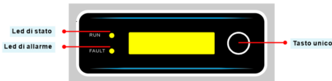
Figure 37 – Écran LCD avec boutons et voyants LED
