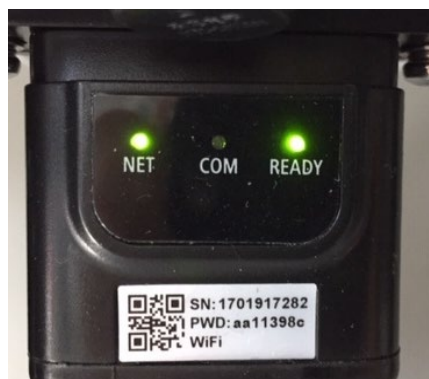
Figure 77 - État de communication irrégulier entre le variateur et l'adaptateur
