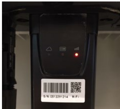
Figure 62 - État de communication irrégulier entre le Wi-Fi et le serveur distant
