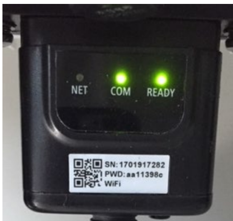
Figure 62 - État de communication irrégulier entre le Wi-Fi et le serveur distant
