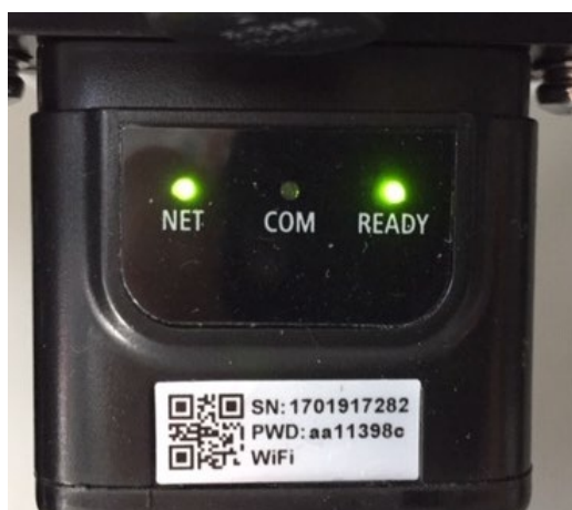
Figure 71 - État de communication irrégulier entre le variateur et l'adaptateur
