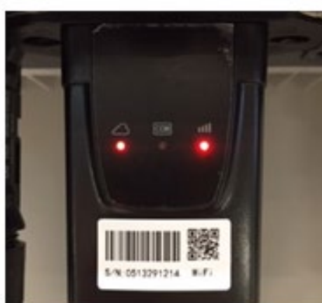
Figure 60 - État de communication irrégulier entre le variateur et le Wi-Fi
