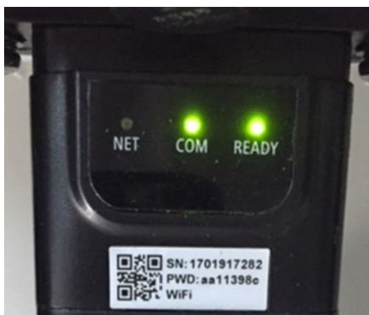
Figure 72 - État de communication irrégulier entre l'adaptateur et le serveur distant
