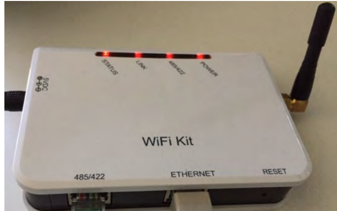
Figura 121 – LED que indica que el datalogger está configurado correctamente
