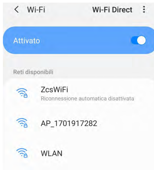
Figura 63 - Deshabilitación de la reconexión automática a una red
