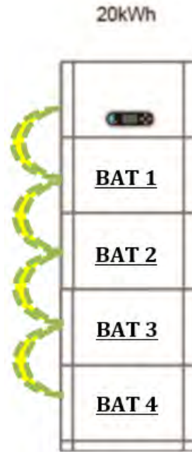
Figura 19- Conexión de la tierra interna (sola columna)
