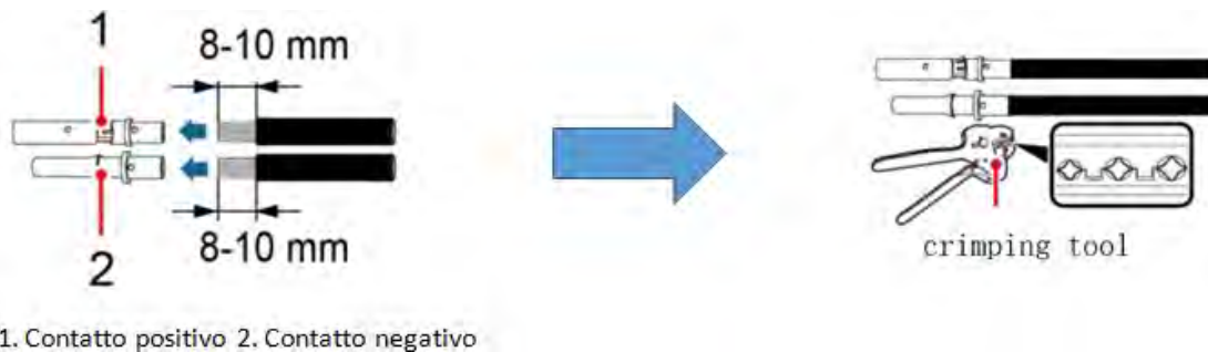
Figura 32 - Preparación de los cables fotovoltaicos positivo y negativo
