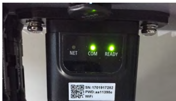
Figura 94 - Estado inicial de los LED
