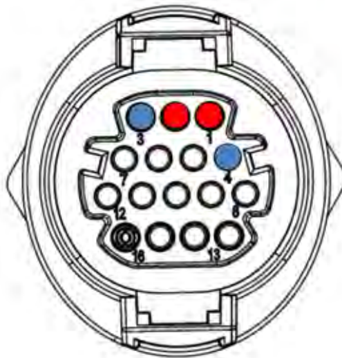
Figura 103a- Conexión de la línea serie mediante conector de comunicación para 3PH HYD5000-HYD20000-ZSS
