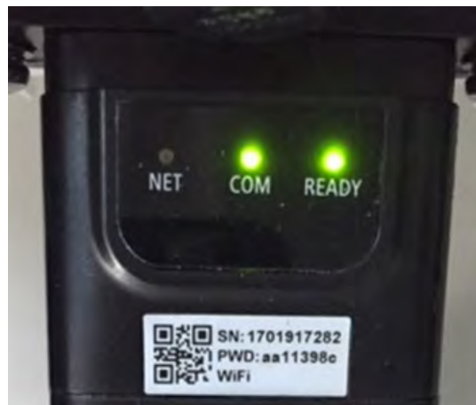
Figura 91 - Estado de comunicación irregular entre adaptador y servidor remoto
