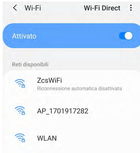
Figure 110 – Désactivation de la reconnexion automatique à un réseau
