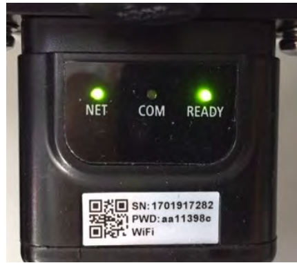
Figure 96 – État de communication irrégulière entre onduleur et adaptateur
