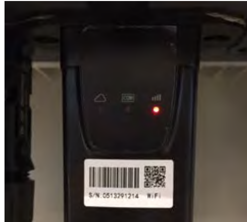
Figure 81 – État de communication irrégulière entre Wi-Fi et serveur à distance
