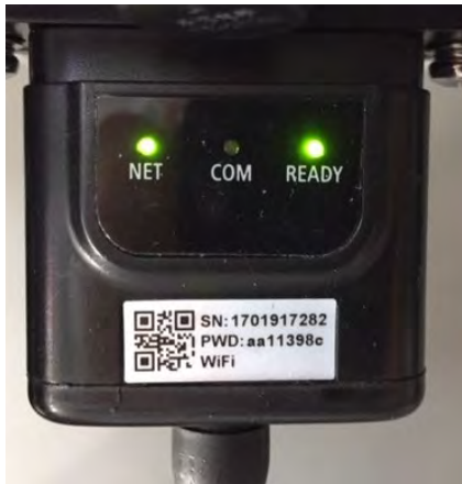
Figure 79 – État de communication irrégulière entre onduleur et Wi-Fi
