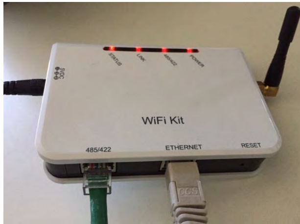
Figure 92 – Câble Ethernet connecté au datalogger
