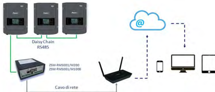
Figure 99 – Schéma illustrant le fonctionnement du datalogger ZSM-RMS001/M200 / ZSM-RMS001/M1000
