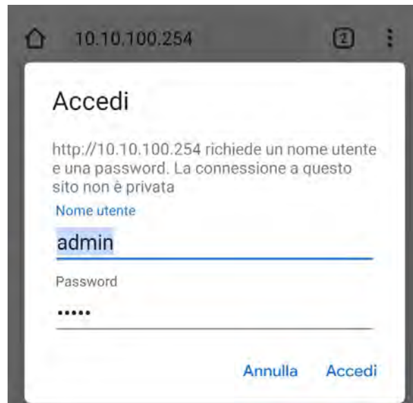
Figure 68 – Page d'accès au serveur Web pour configurer l'adaptateur Wi-Fi
