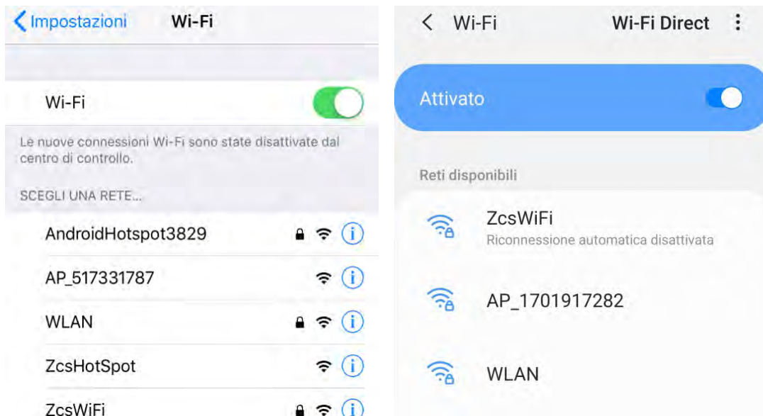
Figure 62 - Recherche des réseaux Wi-Fi sur smartphone iOS (gauche) et smartphone Android (droite)
