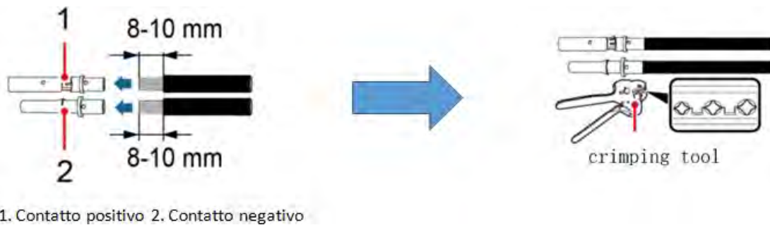
Figure 32 - Préparation des câbles photovoltaïques positif et négatif
