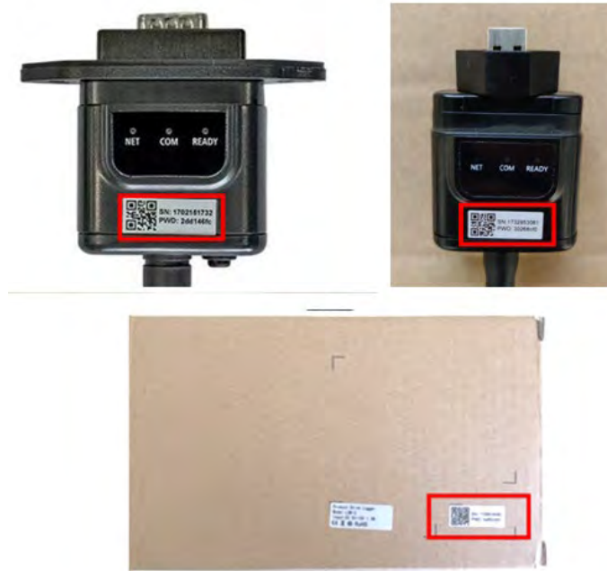
Figure 65 – Mot de passe de l'adaptateur Wi-Fi extérieur
