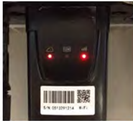
Figure 79 – État de communication irrégulière entre onduleur et Wi-Fi
