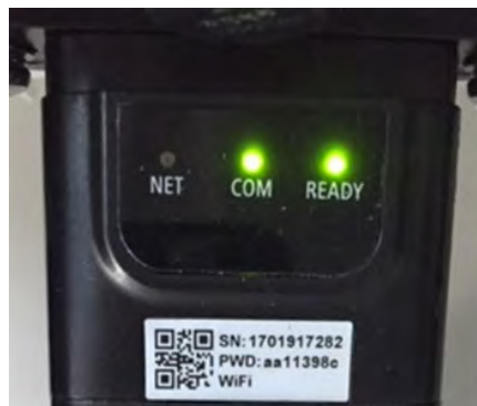
Figure 97 – État de communication irrégulière entre adaptateur et serveur à distance
