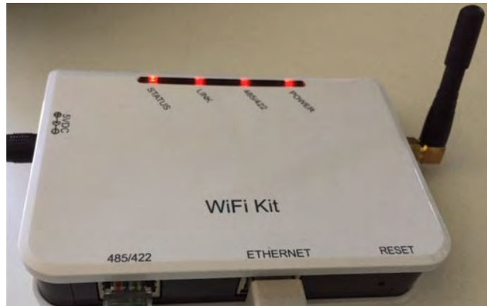
Figure 121 - LED qui indique la configuration correcte du datalogger
