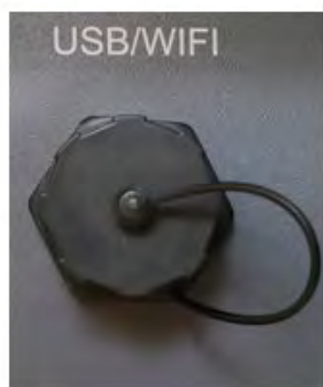
Figure 60 - Port pour adaptateur Wi-Fi extérieur
