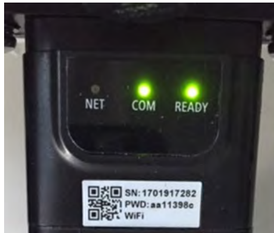
Figure 91 – État de communication irrégulière entre adaptateur et serveur à distance
