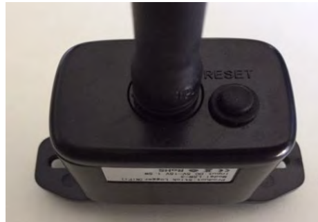
Figure 78 – Bouton de réinitialisation sur l'adaptateur Wi-Fi
