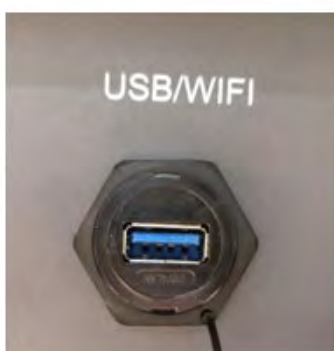
Figure 60 - Port pour adaptateur Wi-Fi extérieur
