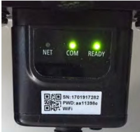
Figure 81 – État de communication irrégulière entre Wi-Fi et serveur à distance
