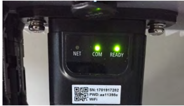
Figure 94 - État initial des LED
