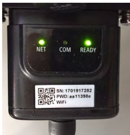
Rysunek 79 - Nieprawidłowy stan komunikacji pomiędzy falownikiem a Wi-Fi
