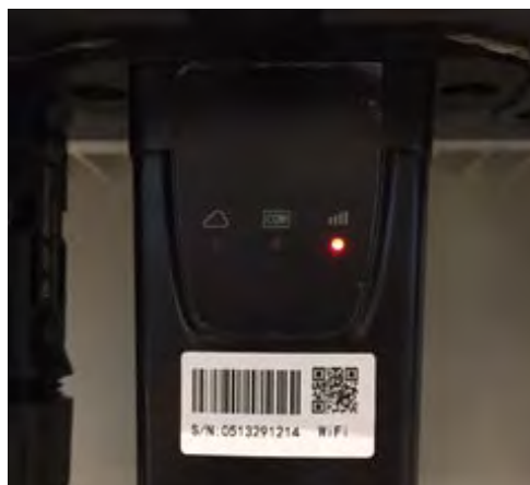
Rysunek 81 - Nieprawidłowy stan komunikacji pomiędzy Wi-Fi i zdalnym serwerem
