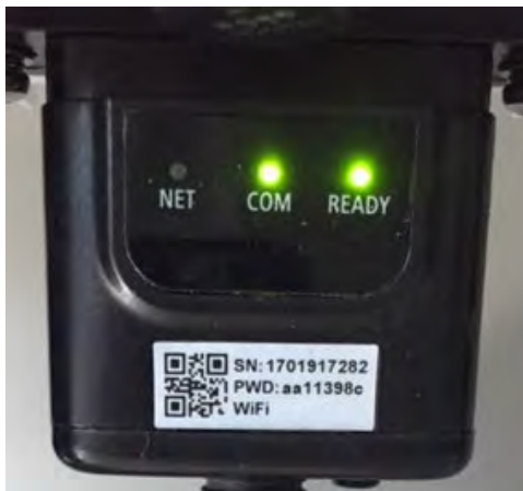
Rysunek 81 - Nieprawidłowy stan komunikacji pomiędzy Wi-Fi i zdalnym serwerem
