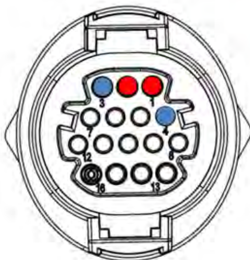
Rysunek 103a- Podłączenie linii szeregowej przez zacisk komunikacyjny 3PH HYD5000-HYD20000-ZSS
