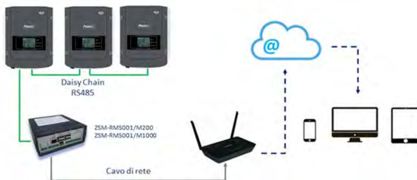
Rysunek 99 – Schemat działania rejestratora danych ZSM-RMS001/M200 / ZSM-RMS001/M1000
