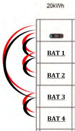
Rysunek 21 - Podłączenie wewnętrznego zacisku prądu stałego baterii ( pojedyncza kolumna )
