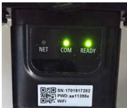
Rysunek 97 - Nieprawidłowy stan komunikacji pomiędzy adapterem i zdalnym serwerem
