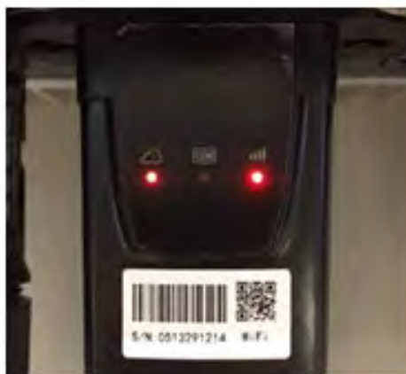
Rysunek 79 - Nieprawidłowy stan komunikacji pomiędzy falownikiem a Wi-Fi
