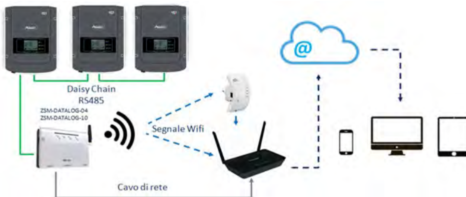
Rysunek 98 – Schemat podłączenia rejestratorów danych ZSM-DATALOG-04 / ZSM-DATALOG-10
