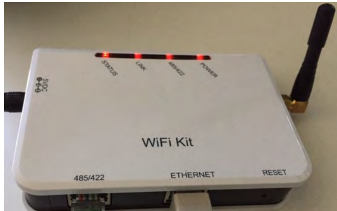
Рисунок 121 – Світлодіоди, які вказують на правильну конфігурацію реєстратора даних
