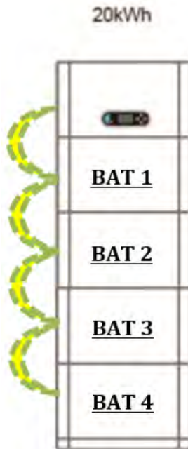
Рисунок 19- Внутрішнє з'єднання заземлення (одна колонка)
