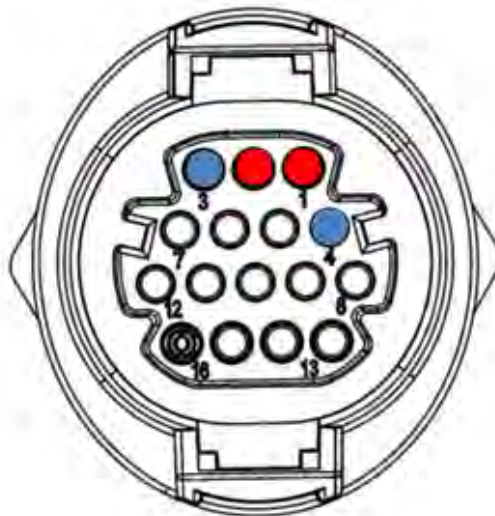
Рисунок 103а- Підключення послідовної лінії через роз'єм зв'язку для 3PH HYD5000-HYD20000-ZSSS
