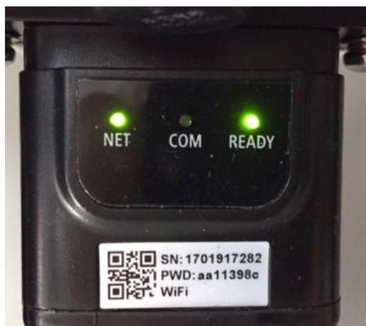
Figura 110 - Estado de comunicación irregular entre inversor y tarjeta
