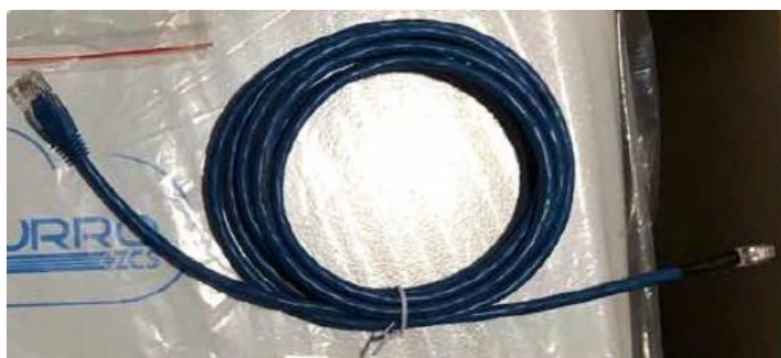
Figura 12 - Cable de comunicación entre inversor y batería WeCo 4k4
