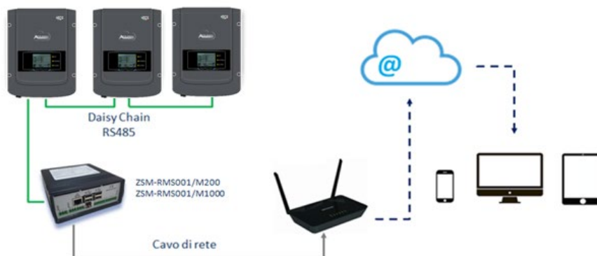
Figura 118 – Esquema de funcionamiento del Datalogger ZSM-RMS001/M200 / ZSM-RMS001/M1000
