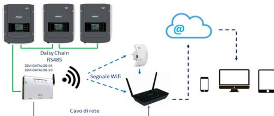
Figura 117 – Esquema de conexión del datalogger ZSM-DATALOG-04 / ZSM-DATALOG-10
