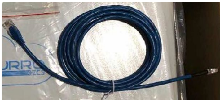
Figura 46 - Cable de comunicación entre inversor y batería AZZURRO ZSX 5000 S
