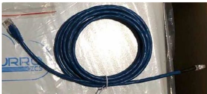
Figura 26 - Cable de comunicación entre inversor y batería WeCo 5k3
