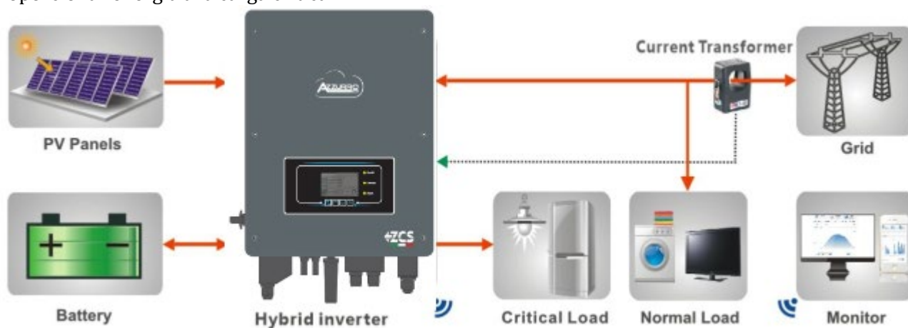
Figura 1- Diagrama en esquema de un equipo en que se ha instalado un inversor híbrido 1PH HYD3000-HYD6000-ZSS
