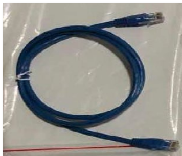
Figura 48– Cable de comunicación entre baterías AZZURRO 5000
