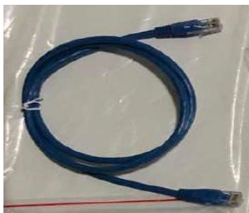
Figura 28 – Cable de comunicación entre baterías WeCo 5k3
