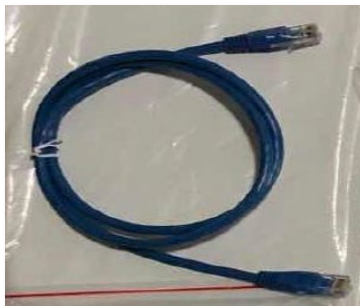
Figura 35 – Cable de comunicación entre baterías WeCo 5K3XP
