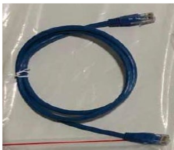
Figura 50 - Cable de comunicación entre baterías AZZURRO ZSX 5000 S
