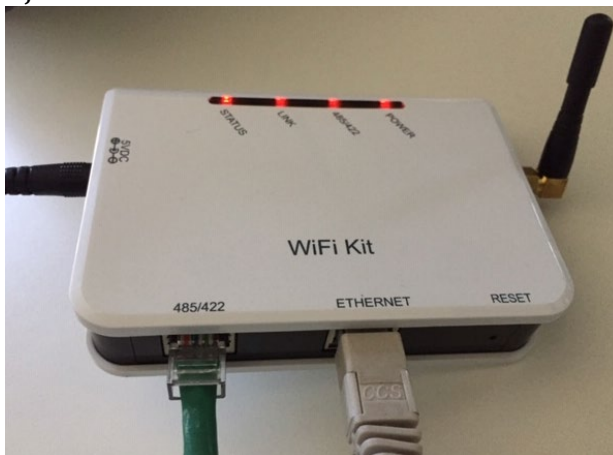
Figura 125 – Cable ethernet conectado al datalogger
