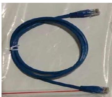
Figura 50- Cable de comunicación entre baterías AZZURRO ZSX 5120
