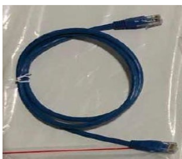
Figura 6 – Cable de comunicación entre baterías WeCo 4k4-LT
