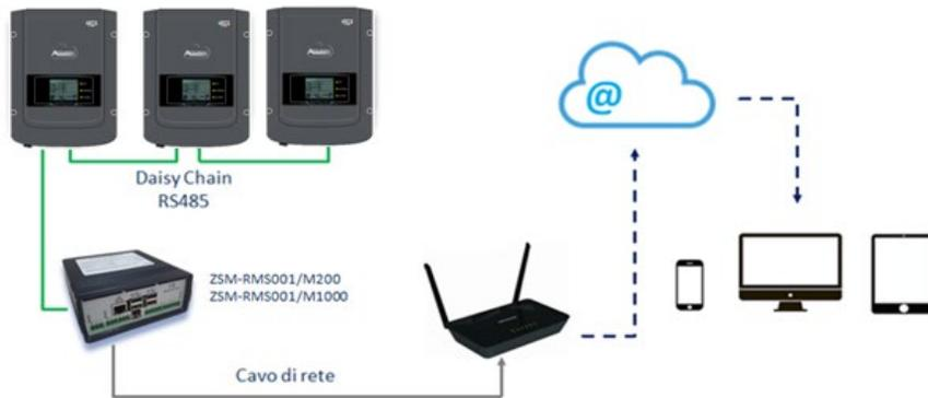
Figura 118 – Esquema de funcionamiento del Datalogger ZSM-RMS001/M200 / ZSM-RMS001/M1000
