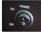
2. Seccionador giratorio CC del inversor en posición de OFF;
