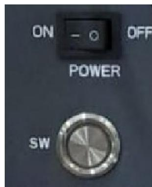
8. Proporcionar alimentación CA a través del interruptor de protección dedicado al inversor de acumulación. En caso de que haya varios interruptores de protección del inversor (por ejemplo, un interruptor magnetotérmico y un diferencial), todos ellos deben estar en ON para permitir la conexión del inversor a la red.
