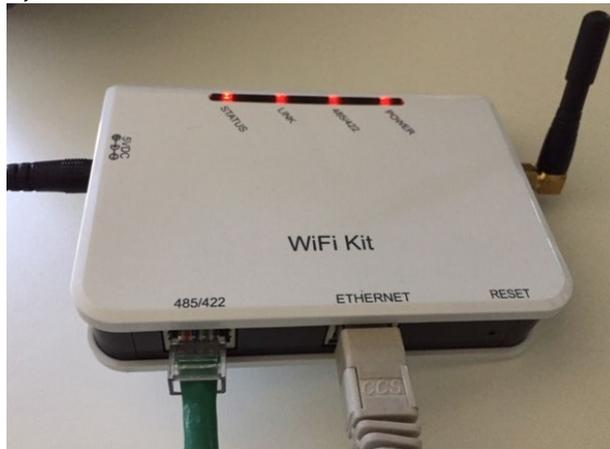
Figura 125 - Cable ethernet conectado al datalogger
