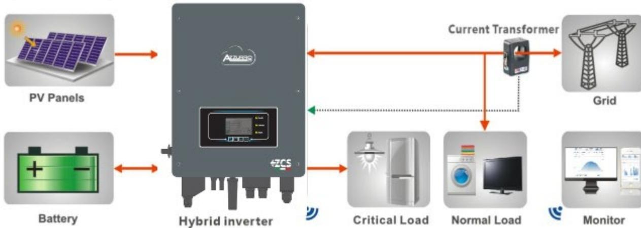
Figura 1- Diagrama en esquema de un equipo en que se ha instalado un inversor híbrido 1PH HYD3000-HYD6000-ZSS
