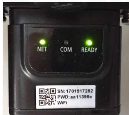
Figura 115 - Estado de comunicación irregular entre inversor y tarjeta
