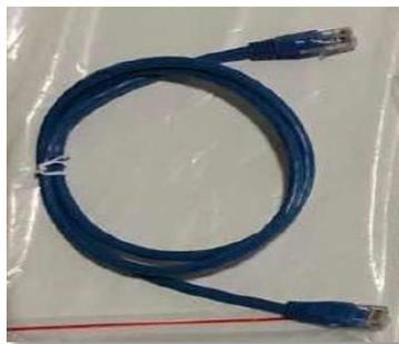
Figura 48- Cable de comunicación entre baterías AZZURRO 5000
