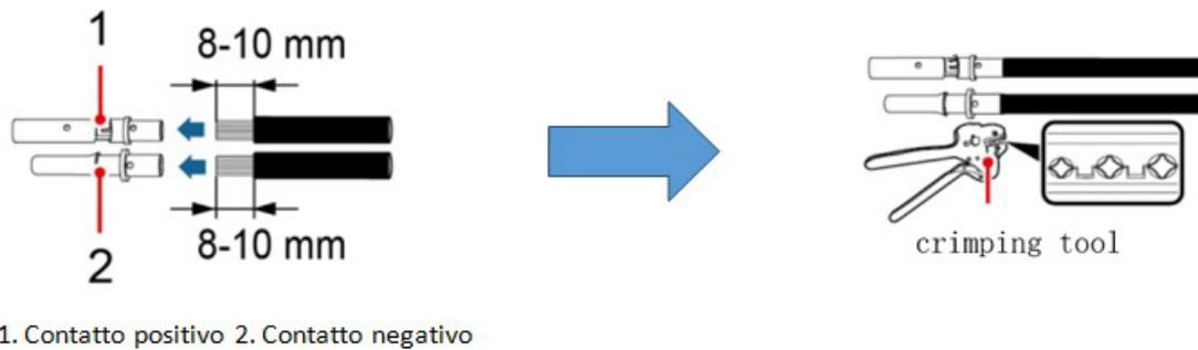
Figura 52- Preparación de los cables fotovoltaicos positivos y negativos
