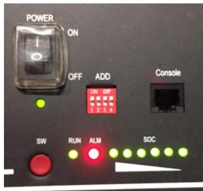
Figura 76 - Estado de la batería después de haber puesto el conmutador POWER en ON y tras haber pulsado la tecla SW
