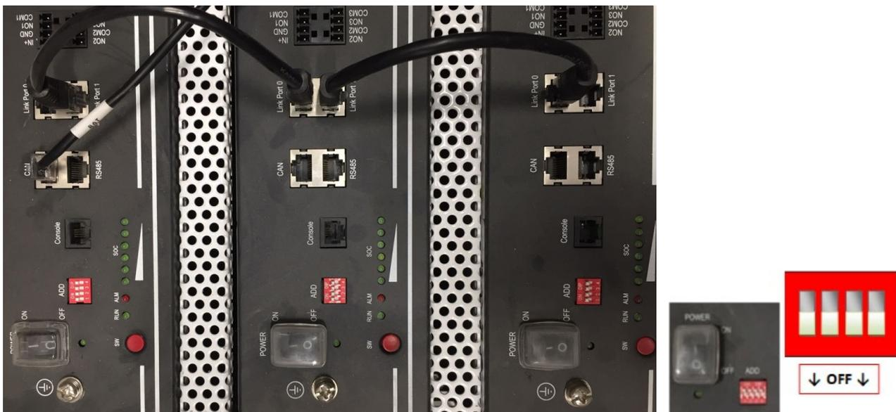
Figura 11 - Conexión de comunicación entre tres baterías Pylontech
