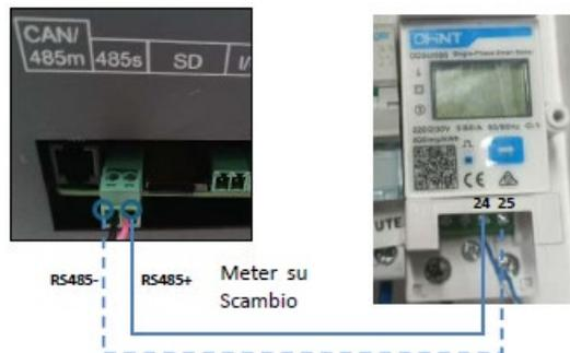
3. Lado Meter conectar resistencia de 120 ohmios desde PIN 24 y 25.
