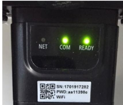
Figura 116 – Estado de comunicación irregular entre tarjeta y servidor remoto
