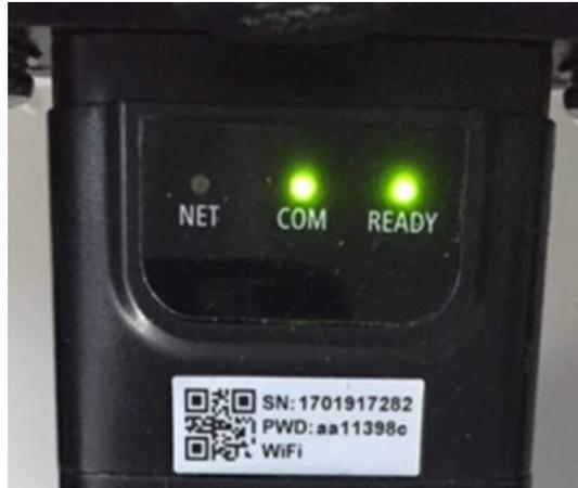
Figura 111 – Estado de comunicación irregular entre tarjeta y servidor remoto
