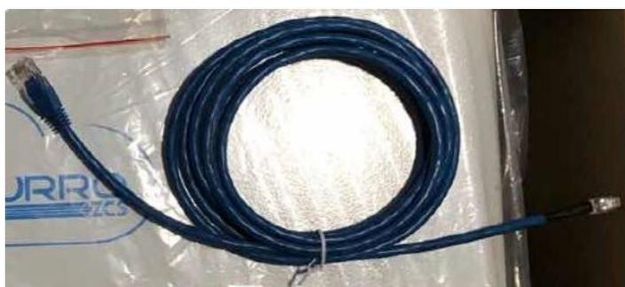
Figura 33 - Cable de comunicación entre inversor y batería WeCo 5K3XP
