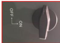
3. Mediante el interruptor lateral, ponga todas las baterías en 1 sin encenderlas (no pulse el botón redondo metálico);
