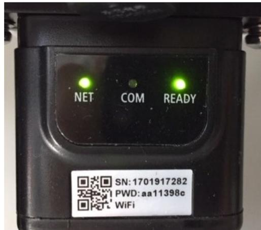
Figura 110 - Estado de comunicación irregular entre inversor y tarjeta
