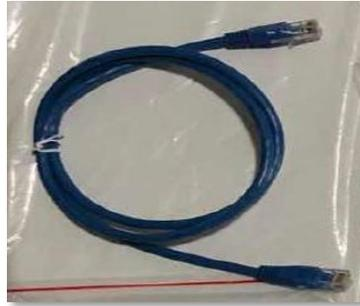
Figura 14 - Cable de comunicación entre baterías WeCo 4k4
