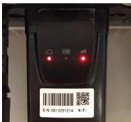
Figura 100 - Estado de comunicación irregular entre inversor y wifi
