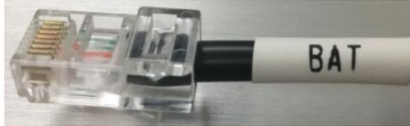
Figura 8 - Cable de comunicación Pylontech a introducir en la entrada de comunicación de la batería
