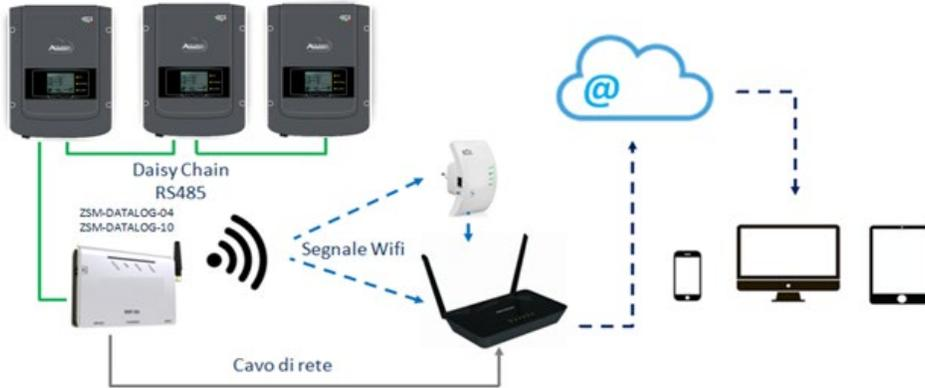
Figura 117 – Esquema de conexión del datalogger ZSM-DATALOG-04 / ZSM-DATALOG-10
