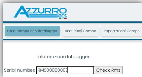
Introducir el número de serie (S/N) del datalogger de referencia y pulsar la tecla “check RMS”. Si el datalogger está correctamente configurado, se abrirá una página donde se deberá introducir la información solicitada en relación con el campo a instalar.
