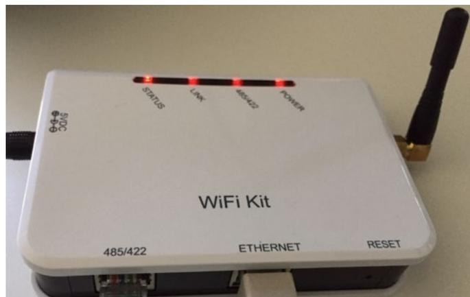
Figura 138 – Led que indican que el datalogger está correctamente configurado
