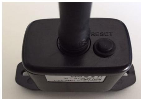
**Figura 99 – Tecla de reset en la tarjeta wifi**
