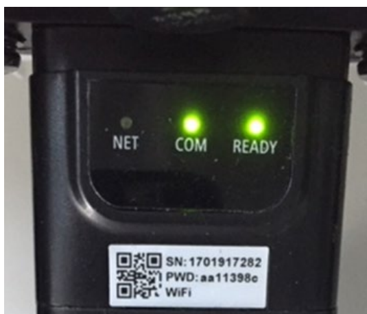
Figure 105 – État de communication irrégulière entre carte et serveur à distance
