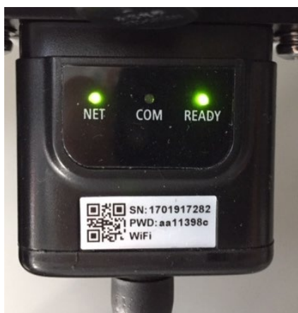
Figure 93 – État de communication irrégulière entre onduleur et Wi-Fi
