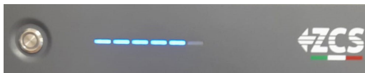
Figure 50 – Bouton d'allumage de la batterie AZZURRO ZSX 5000 S
