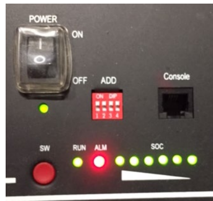
Figure 69 – État de la batterie après avoir positionné le commutateur POWER sur ON et appuyé sur le bouton SW
