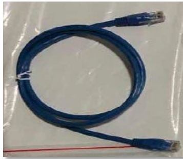
Figure 35 – Câble de communication entre batteries WeCo 5K3XP
