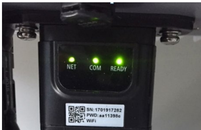
Figure 103 – État final des led
