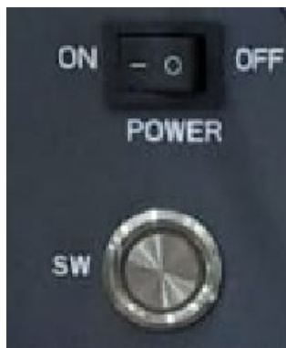
Figure 13 – Bouton d'allumage de la batterie AZZURRO ZSX 5120
