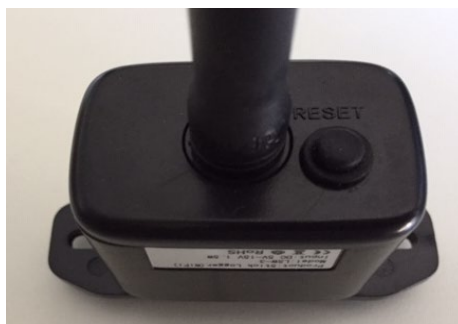
Figure 92 – Touche de réinitialisation sur la carte Wi-Fi
