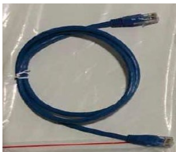
Figure 14 – Câble de communication entre batteries WeCo 4k4
