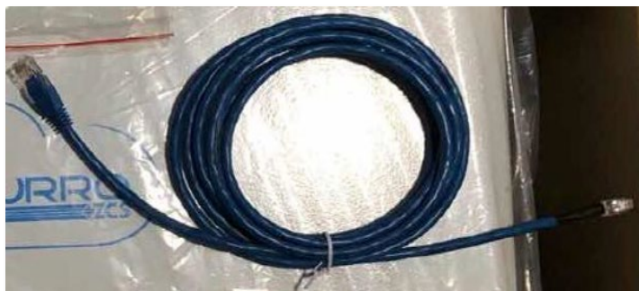
Figure 12 – Câble de communication entre onduleur et batterie WeCo 4k4
