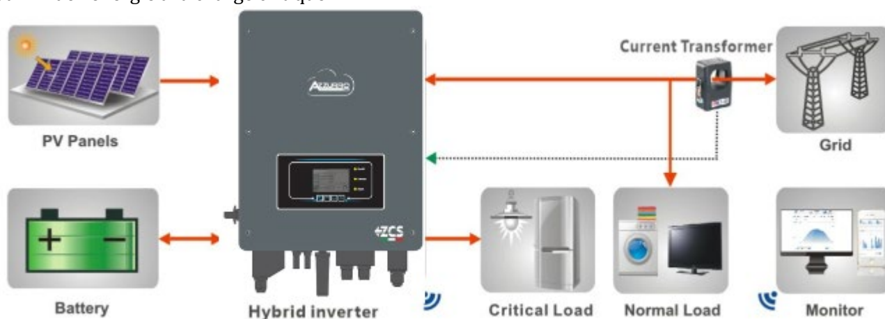
Figure 1 - Schéma de principe d'un système dans lequel est installé un onduleur hybride 1PH HYD3000-HYD6000-ZSS
