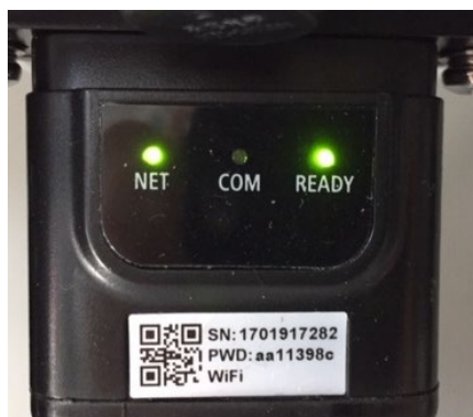
Figure 110 – État de communication irrégulière entre onduleur et carte
