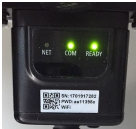
Figure 95 – État de communication irrégulière entre Wi-Fi et serveur à distance
