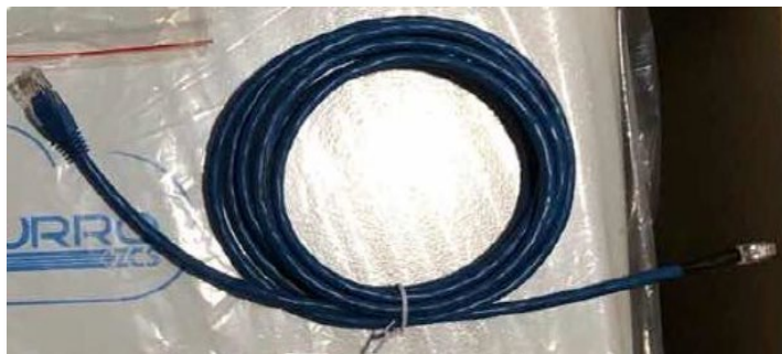
Figure 26 – Câble de communication entre onduleur et batterie WeCo 5k3
