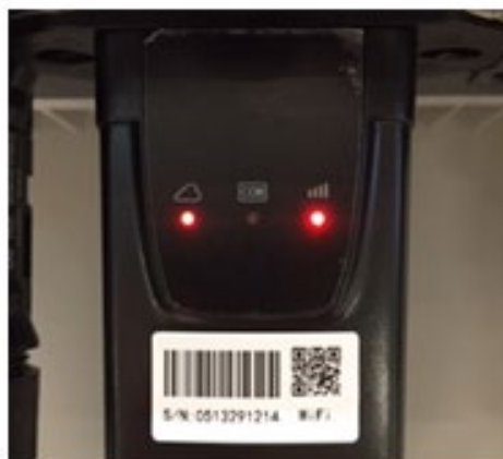
Figure 93 – État de communication irrégulière entre onduleur et Wi-Fi
