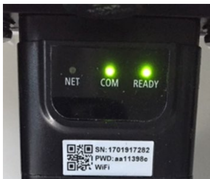
Figure 111 – État de communication irrégulière entre carte et serveur à distance
