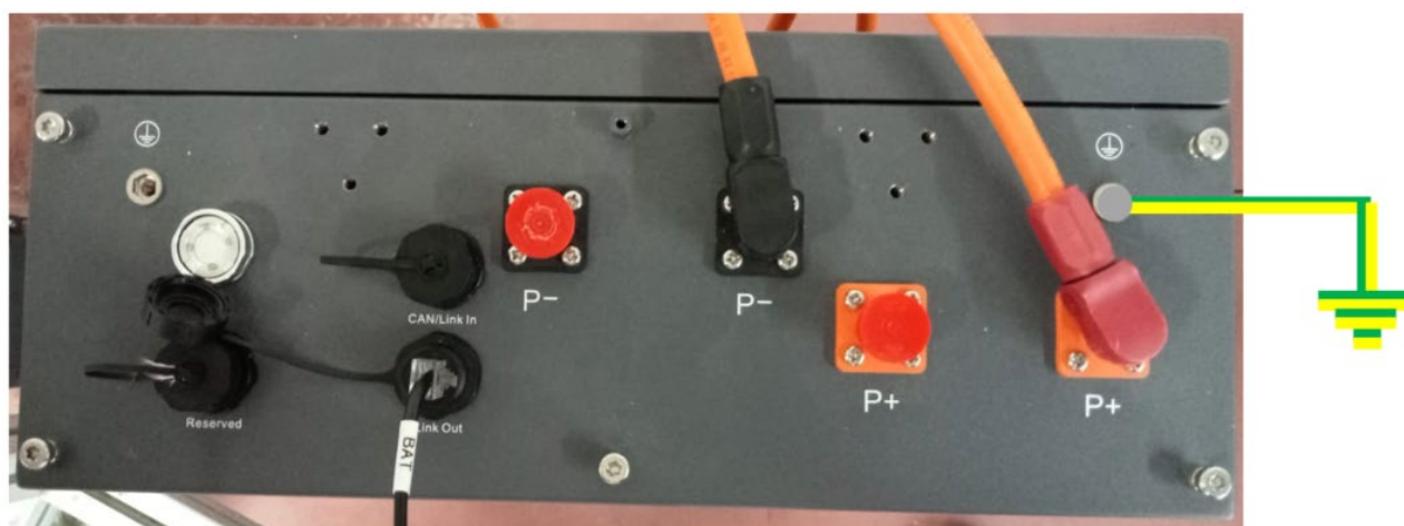
Figure 49 – Bornier de la Batterie AZZURRO ZSX 5000 S
