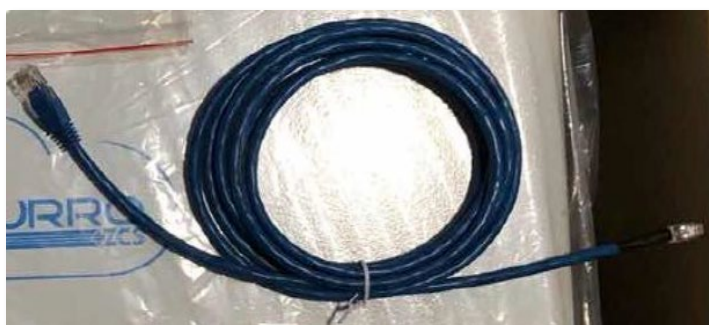
Figure 33 – Câble de communication entre onduleur et batterie WeCo 5K3XP
