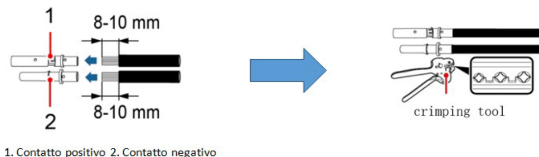
Figure 52 – Préparation des câbles photovoltaïques positifs et négatifs
