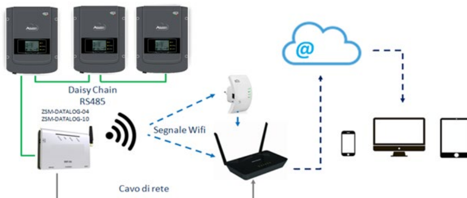
Figure 112 – Schéma de connexion du datalogger ZSM-DATALOG-04 / ZSM-DATALOG-10
