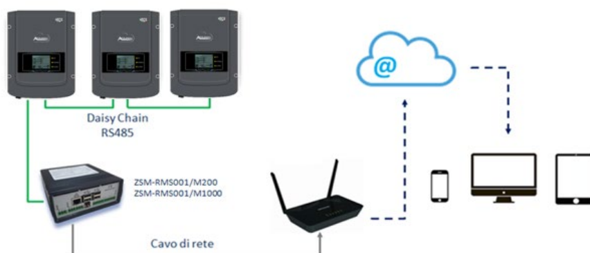
Figure 113 – Schéma fonctionnel du datalogger ZSM-RMS001/M200 / ZSM-RMS001/M1000
