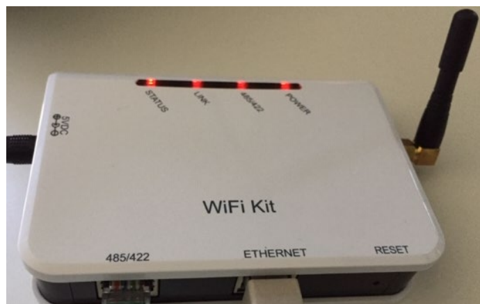
Figure 132 - Led qui indique la configuration correcte du datalogger
