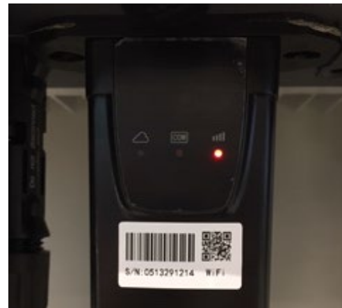
Figure 95 – État de communication irrégulière entre Wi-Fi et serveur à distance
