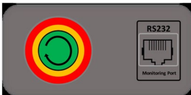
Figure 15 – Vue du bouton d'allumage de la batterie WeCo
