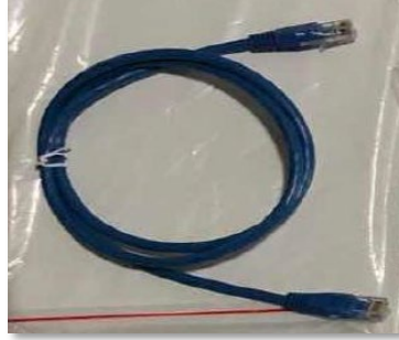
Figure 24 – Câble de communication entre batteries WeCo 4k4
