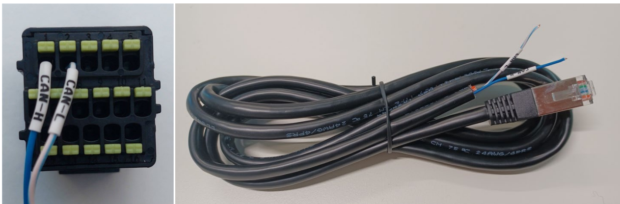
Figure 16 – Câble de communication Pylontech à insérer dans l'entrée de communication de la batterie
