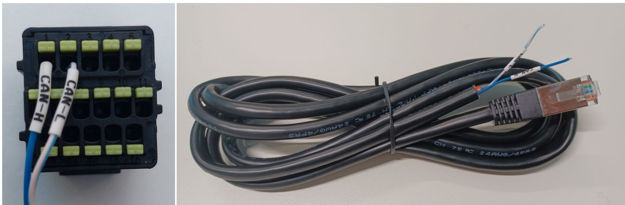
Figure 11 - Câble de communication Pylontech à insérer dans l'entrée de communication de la batterie
