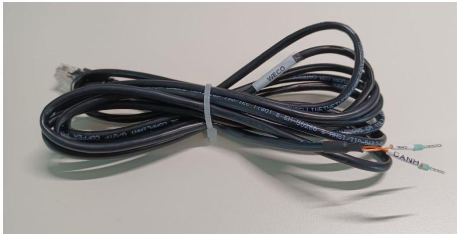
Figure 53 – Câble de communication entre l'onduleur et la batterie WeCo 5k3
