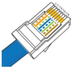
Figure 143 – Brochage pour la connexion du connecteur RJ45
