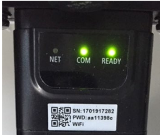
Figure 134 – État de communication irrégulière entre carte et serveur à distance
