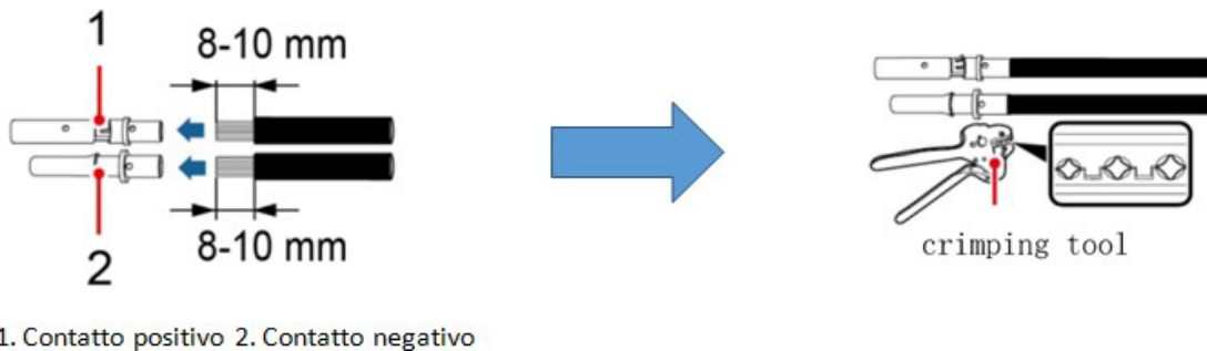
Figure 7 - Préparation des câbles photovoltaïques positif et négatif
