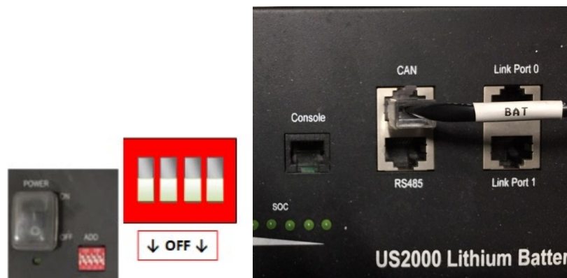
Figure 12 – Connexion du câble de communication à la batterie Pylontech
