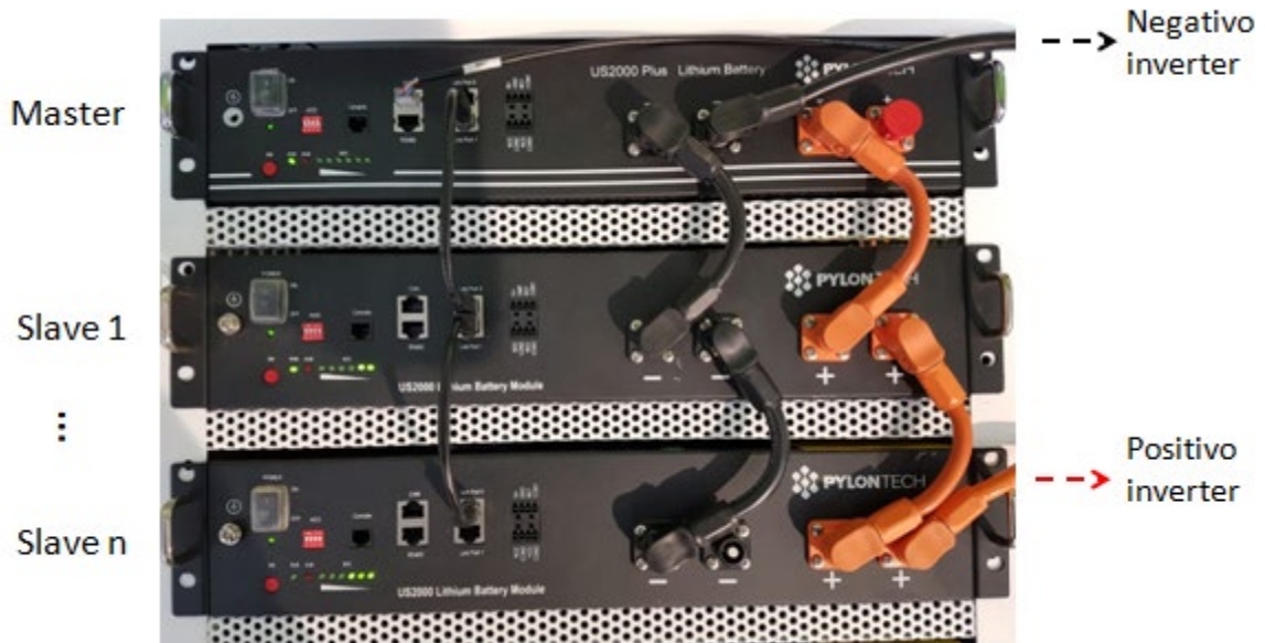
Figure 15 – Connexion de trois batteries Pylontech en parallèle
