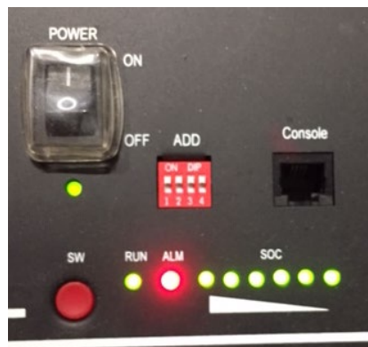
Figure 100 – État de la batterie après avoir positionné l'interrupteur POWER sur ON et appuyé sur le bouton SW
