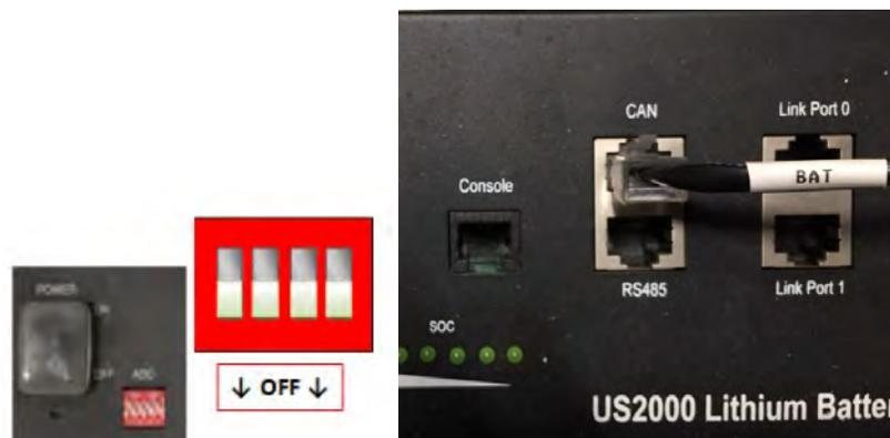
Figure 14 – Connexion du câble de communication à la batterie Pylontech
