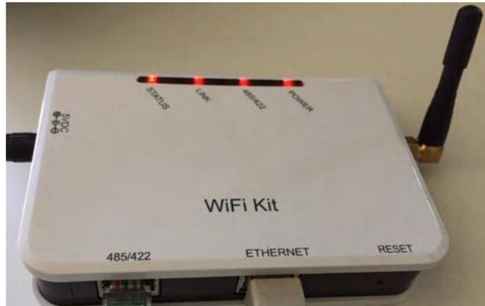
Figure 175 – Led qui indique la configuration correcte du datalogger
