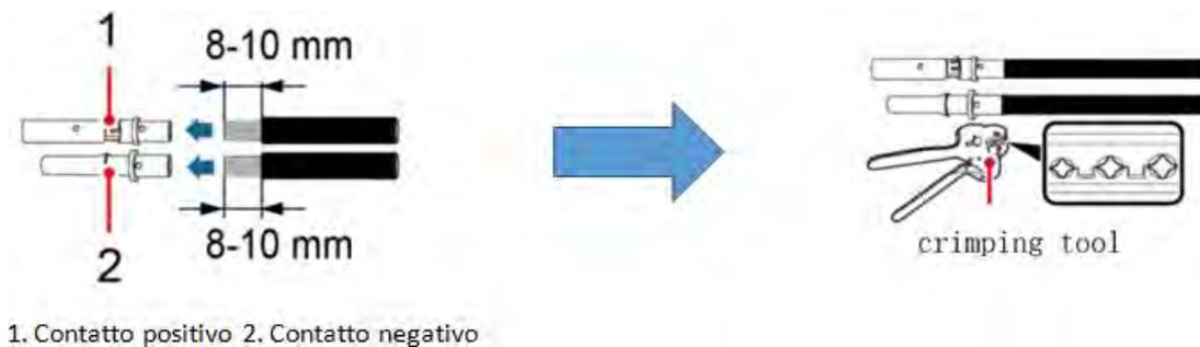
Figure 9 - Préparation des câbles photovoltaïques positif et négatif
