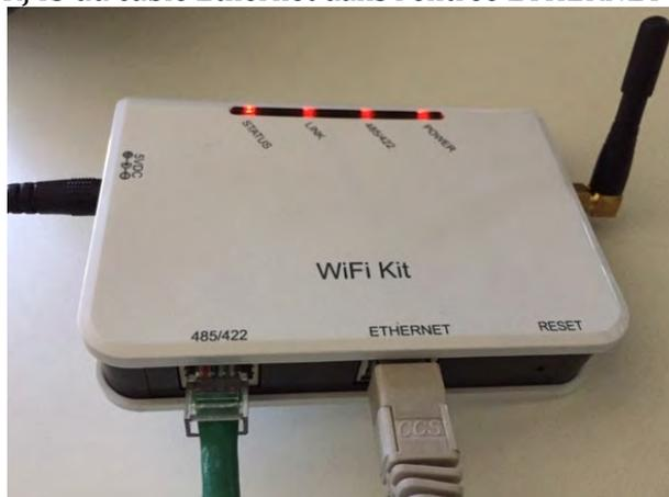
Figure 162 – Câble Ethernet connecté au datalogger
