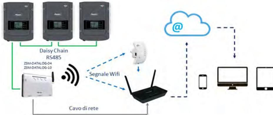
Figure 152 – Schéma de connexion du datalogger ZSM-DATALOG-04 / ZSM-DATALOG-10
