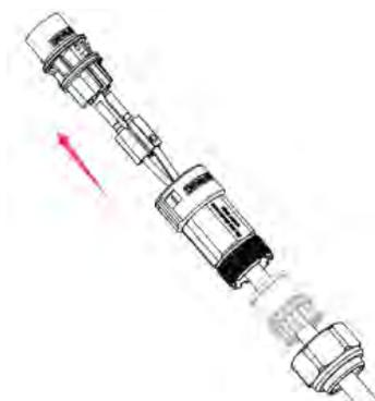
**Phase 5** : Connecter la borne au port de l'onduleur et pousser la borne en avant jusqu'à entendre un « clic » indiquant que la connexion de la borne est terminée.
