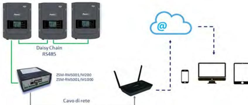
Figure 153 – Schéma fonctionnel du datalogger ZSM-RMS001/M200 / ZSM-RMS001/M1000
