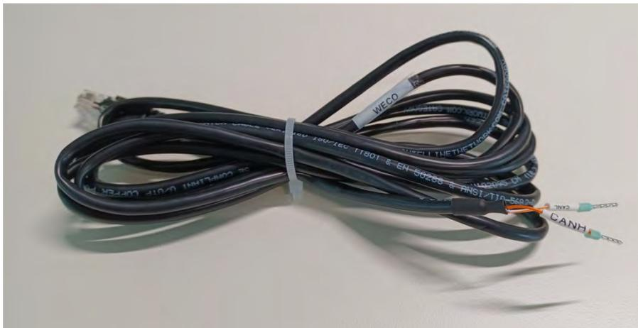
Figure 55 – Câble de communication entre l'onduleur et la batterie WeCo 5k3
