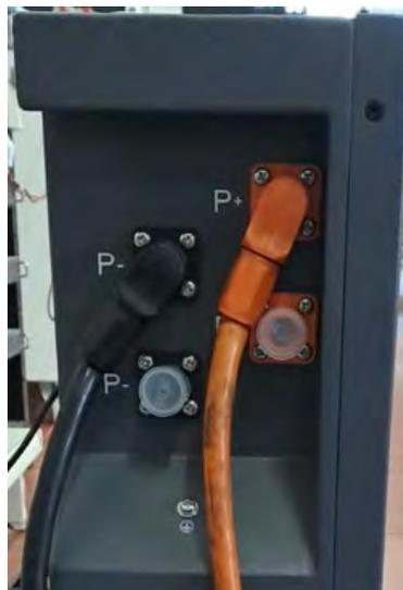
Figure 85 – Bornier de la Batterie AZZURRO ZSX 5120
