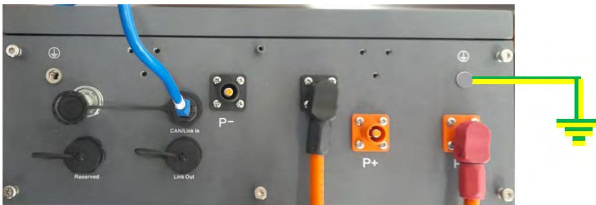
Figure 94 – Bornier de la batterie AZZURRO 5000 S
