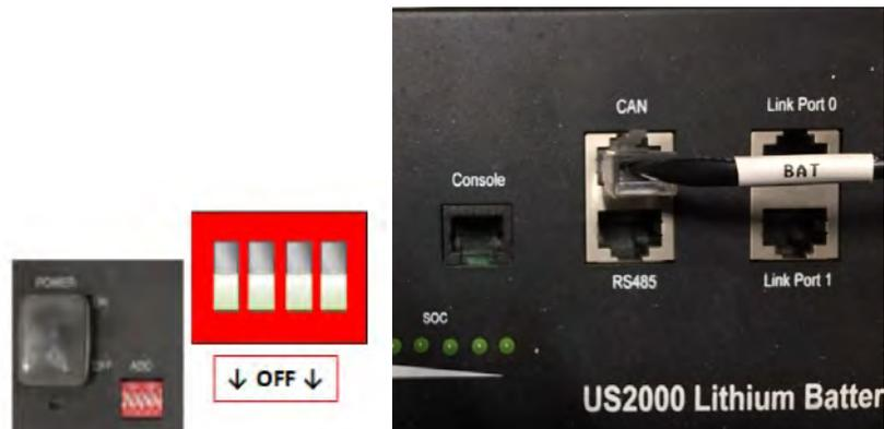
Figure 19 – Connexion du câble de communication à la batterie Pylontech
