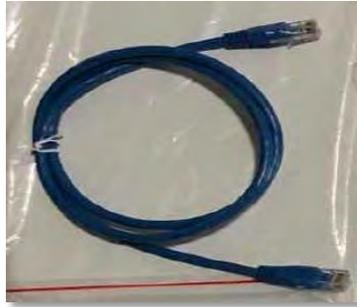
Figure 71 – Câble de communication entre batteries AZZURRO 5000
