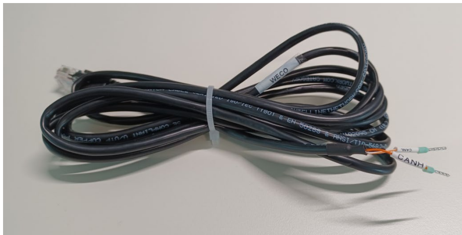
Рисунок 37 – Комунікаційний кабель між інвертором та акумулятором WeCo 4k4-LT
