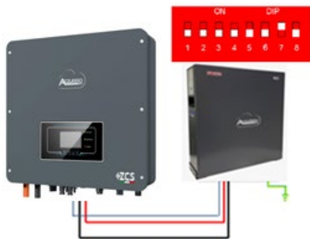
Рисунок 30 – З'єднання акумуляторної батареї WeCo 4k4 PRO
