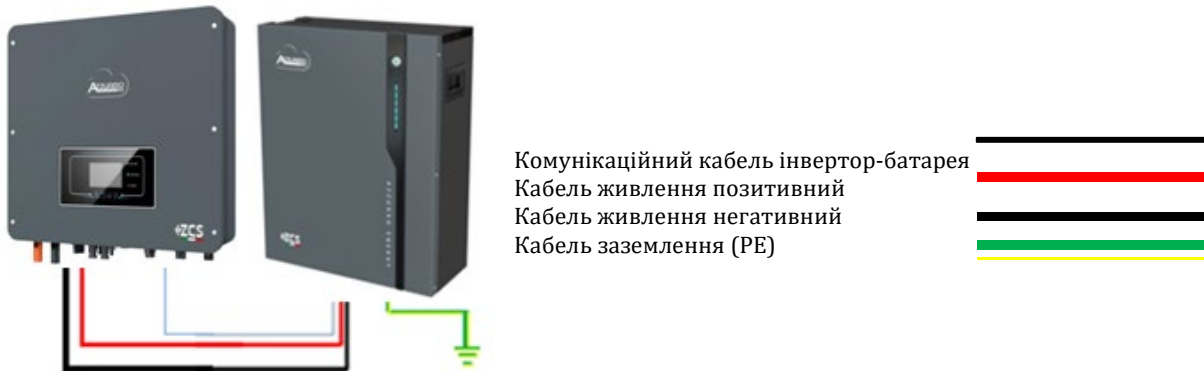
Рисунок 74 – З'єднання акумуляторної батареї AZZURRO 5000 PRO
