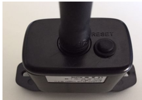
Рисунок 122 – Кнопка скидання налаштувань на платі Wi-Fi
