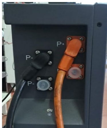
Рисунок 83 – Клемна плата акумулятора AZZURRO ZSX 5120
