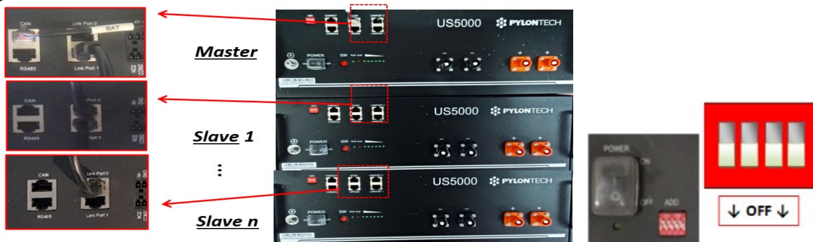
Рисунок 19 – Підключення кабелю між трьома акумуляторами Pylontech
