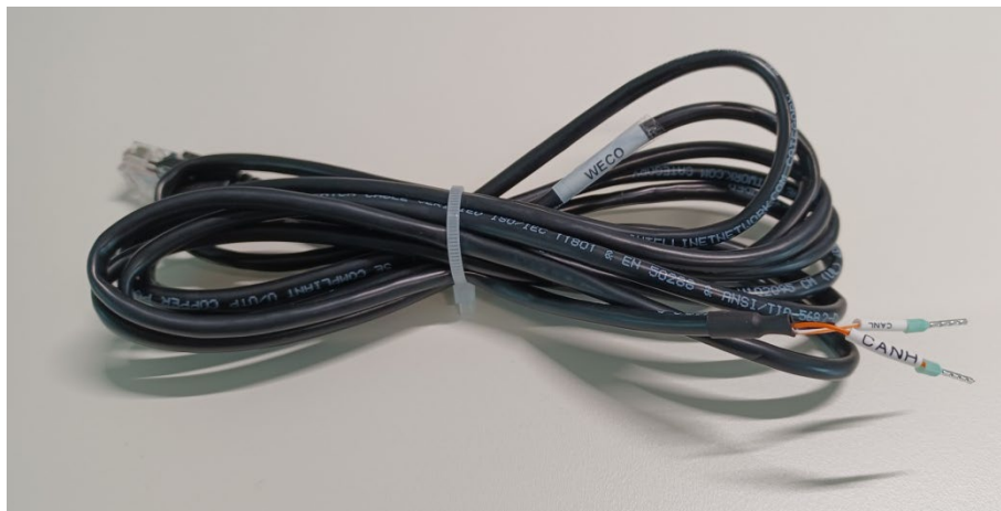
Рисунок 46 – Комунікаційний кабель між інвертором та акумулятором WeCo 5k3
