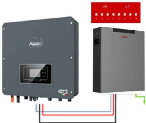
Рисунок 38 – З'єднання акумуляторної батареї WeCo 4k4-LT
