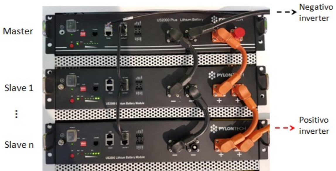
Рисунок 15 - Паралельне підключення трьох батарей Pylontech
