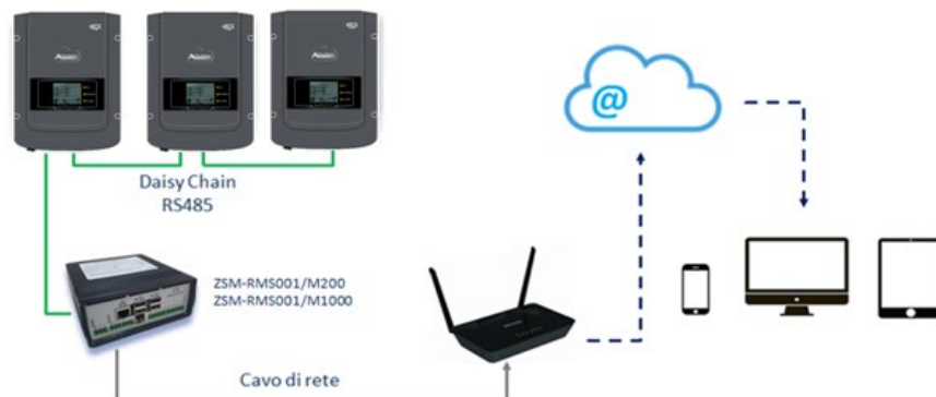
Рисунок 143 – Схема функціонування реєстратора даних ZSM-RMS001 / M200 / ZSM-RMS001 / M1000
