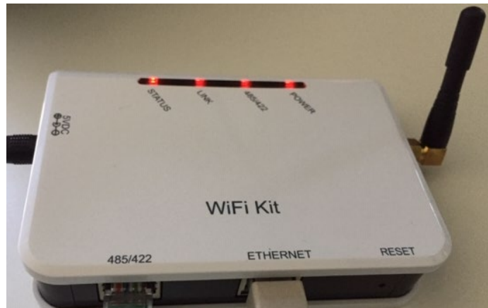
Рисунок 165 – Світлодіоди, які вказують на правильну конфігурацію реєстратора даних
