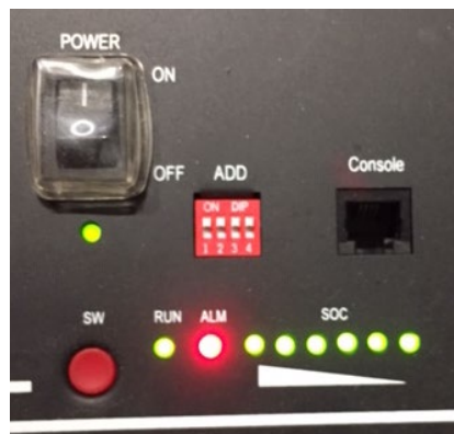
Рисунок 101 - Стан батареї після встановлення перемикача POWER у положення ON та натискання кнопки SW
