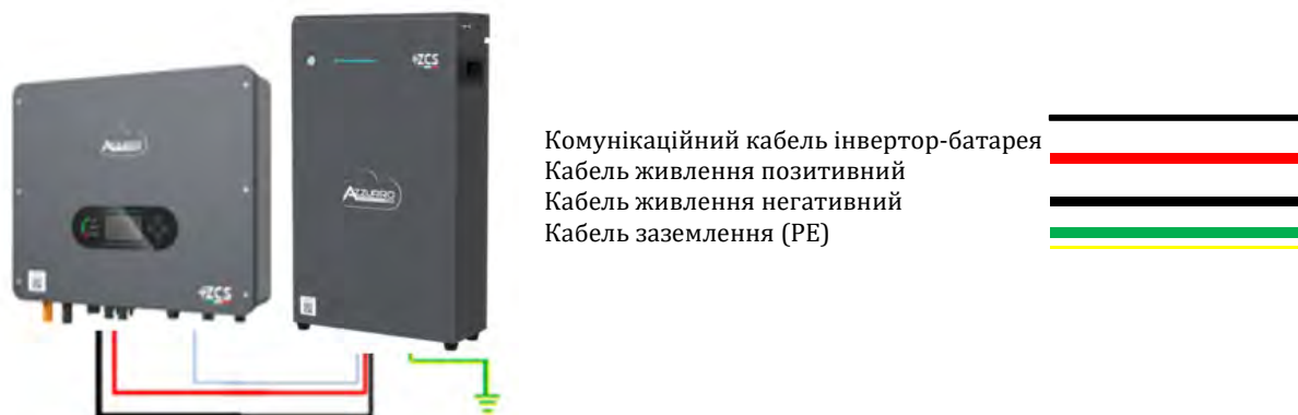
Рисунок 93 – З'єднання акумуляторної батареї AZZURRO 5000 S
