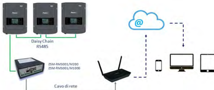
Рисунок 155 – Схема функціонування реєстратора даних ZSM-RMS001 / M200 / ZSM-RMS001 / M1000
