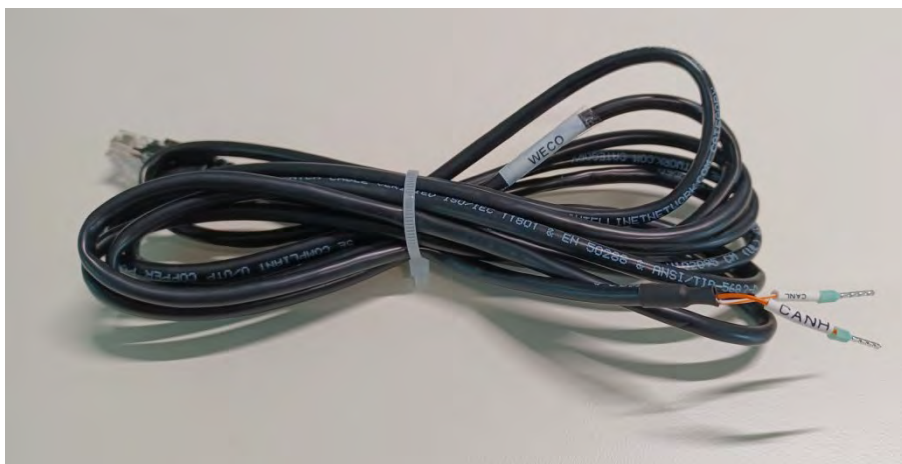
Рисунок 39 – Комунікаційний кабель між інвертором та акумулятором WeCo 4k4-LT
