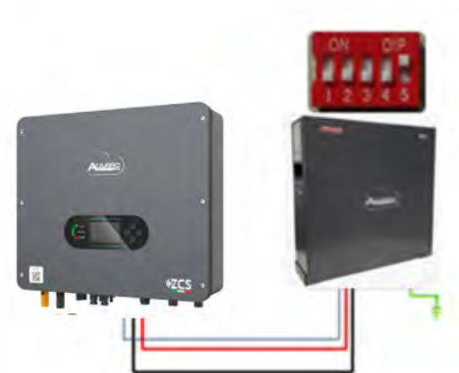
Рисунок 24 – З'єднання акумуляторної батареї WeCo 4k4
