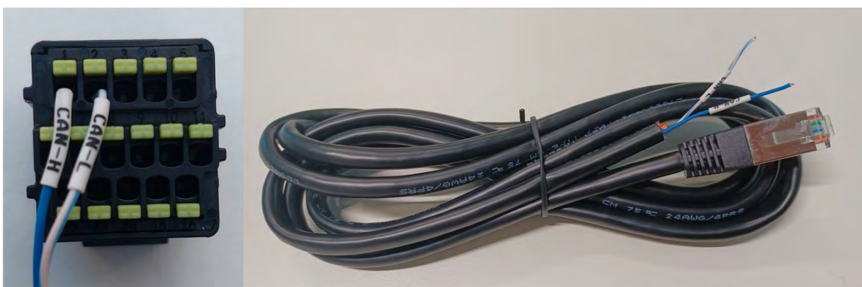
Рисунок 13 – Комунікаційний кабель Pylontech, що вставляється у вхід зв'язку акумуляторної батареї
