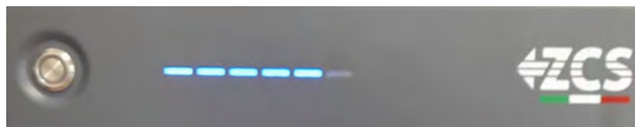
Рисунок 95 – Кнопка живлення акумуляторної батареї AZZURRO 5000 S
