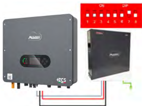
Рисунок 32 – З'єднання акумуляторної батареї WeCo 4k4 PRO
