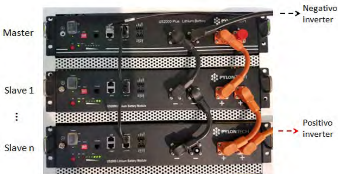
Рисунок 17 – Паралельне підключення трьох батарей Pylontech
