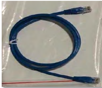
Рисунок 57 – Комунікаційний кабель між батареями WeCo 5K3XP
