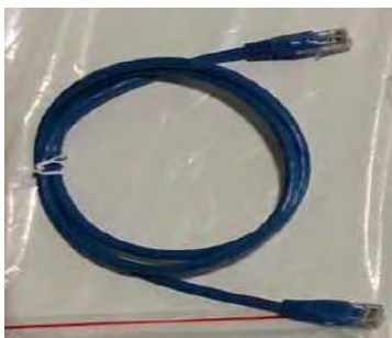
Рисунок 26 – Комунікаційний кабель між батареями WeCo 4k4
