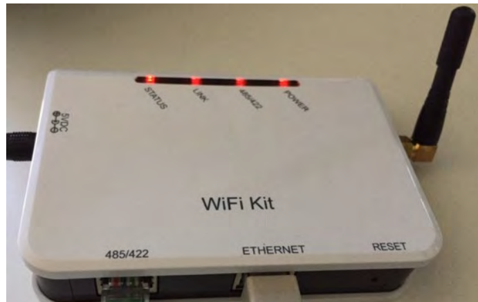
Рисунок 177 – Світлодіоди, які вказують на правильну конфігурацію реєстратора даних
