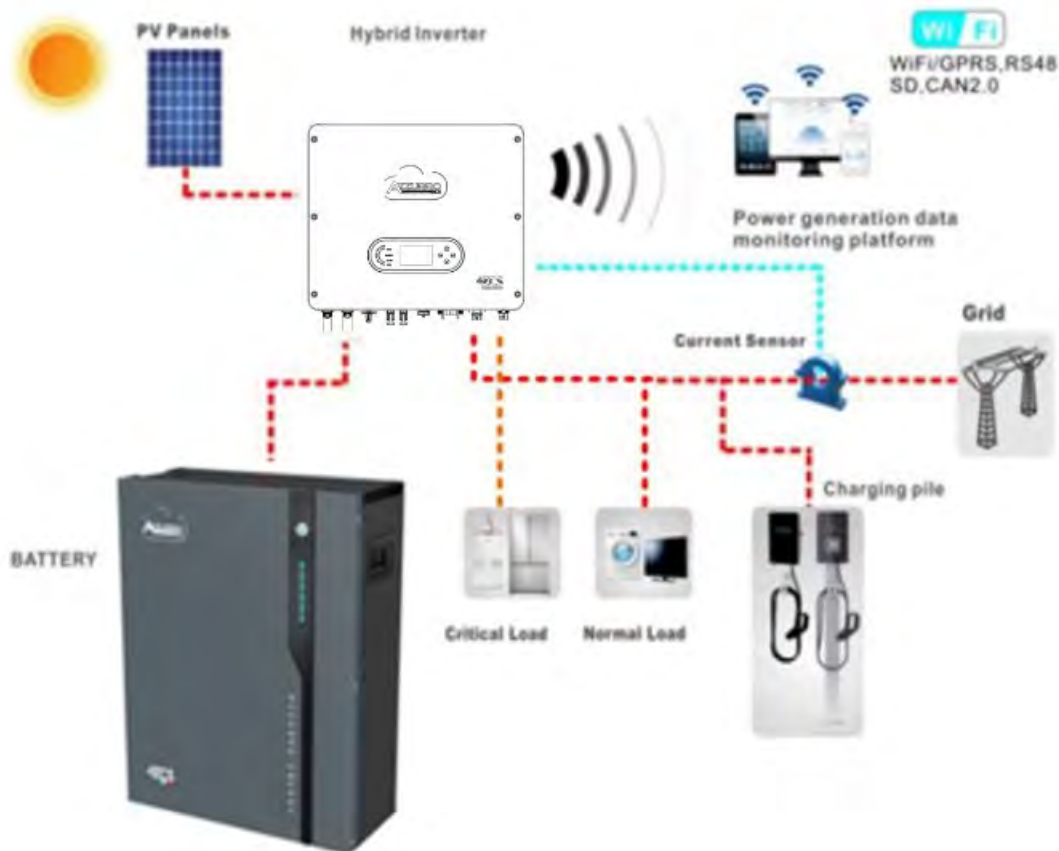
Рисунок 1 – Схема системи із встановленим гібридним інвертором 1PH HYD3000-HYD6000-ZSS-HP
