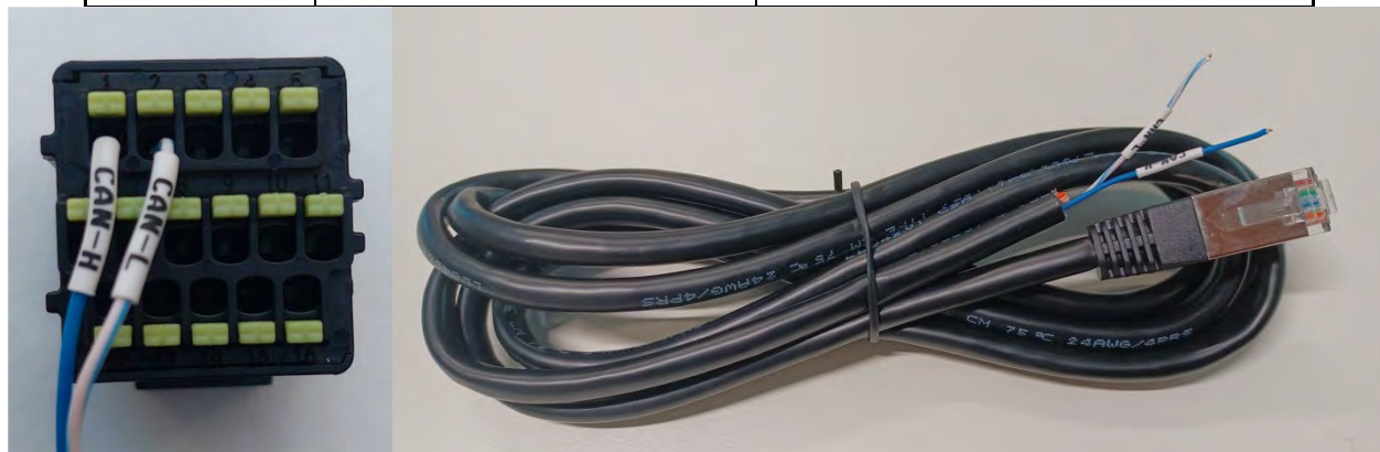
Рисунок 83 – Комунікаційний кабель між інвертором та акумулятором AZZURRO ZSX 5120
