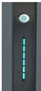
Рисунок 78 – Кнопка живлення акумуляторної батареї AZZURRO 5000 PRO
