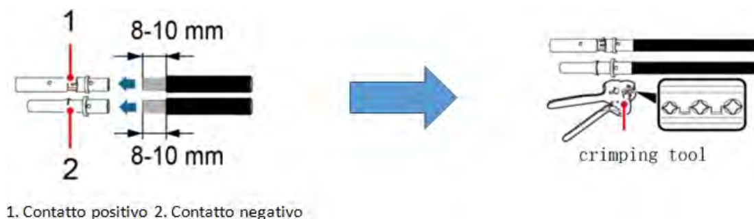
Рисунок 9 – Підготовка позитивних та негативних кабелів фотоелектричної системи
