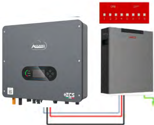
Рисунок 40 – З'єднання акумуляторної батареї WeCo 4k4-LT
