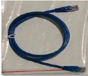
Рисунок 50 – Комунікаційний кабель між батареями WeCo 5k3
