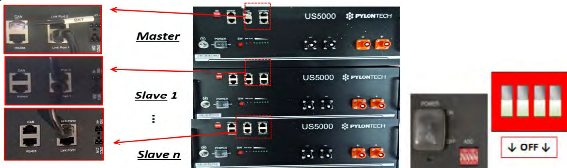
Рисунок 21 – Підключення кабелю між трьома акумуляторами Pylontech
