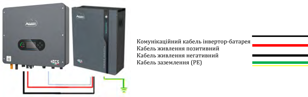
Рисунок 76 – З'єднання акумуляторної батареї AZZURRO 5000 PRO
