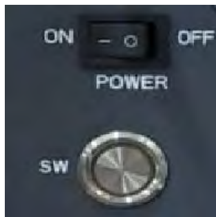
Рисунок 86 – Кнопка живлення акумуляторної батареї AZZURRO ZSX 5120
