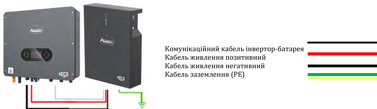
Рисунок 84 – З'єднання акумуляторної батареї AZZURRO ZSX 5120
