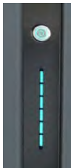
Рисунок 70 – Кнопка живлення акумуляторної батареї AZZURRO 5000
