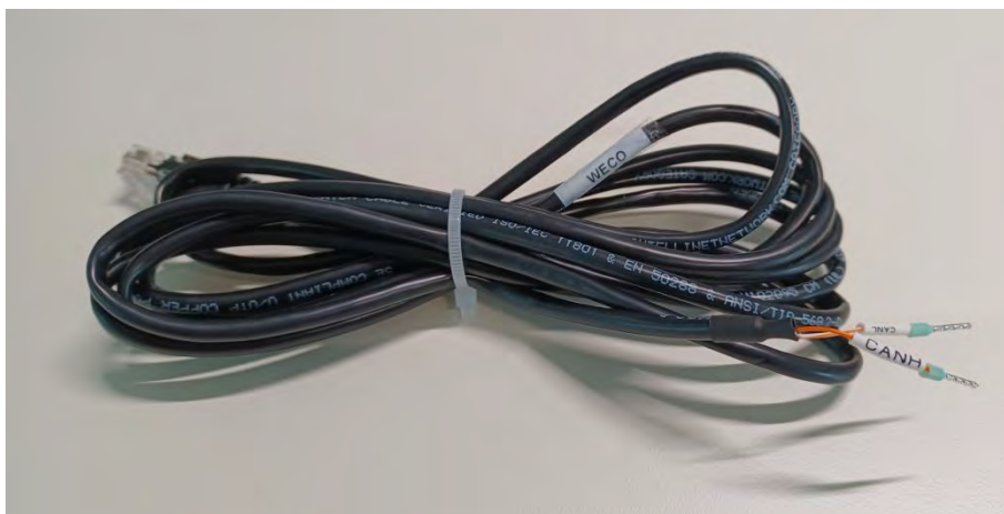
Рисунок 55 – Комунікаційний кабель між інвертором та акумулятором WeCo 5K3XP
