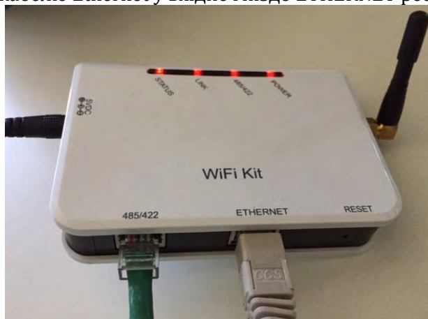
Рисунок 164 – Кабель Ethernet, підключений до реєстратора даних
