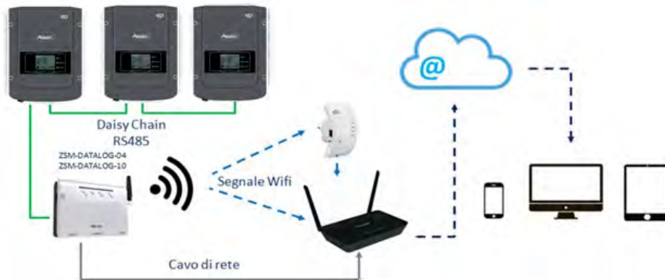
Рисунок 154 – Схема підключення реєстратора даних ZSM-DATALOG-04 / ZSM-DATALOG-10
