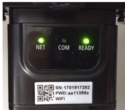
Рисунок 109 - Нестабільний стан зв'язку між інвертором та платою
