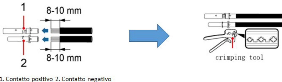
Рис.52- Підготовка позитивних та негативних кабелів фотоелектричної системи
