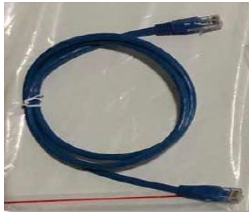
Рисунок 5 – Комунікаційний кабель між батареями WeCo 4k4-LT
