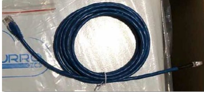
Рис.19 - Комунікаційний кабель між інвертором та акумулятором WeCo 4k4 PRO
