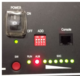
Рис.69 – Стан акумуляторної батареї після встановлення перемикача POWER в положення ON і натискання кнопки SW
