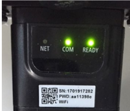
Рисунок 110 - Нестабільний стан зв'язку між платою та віддаленим сервером
