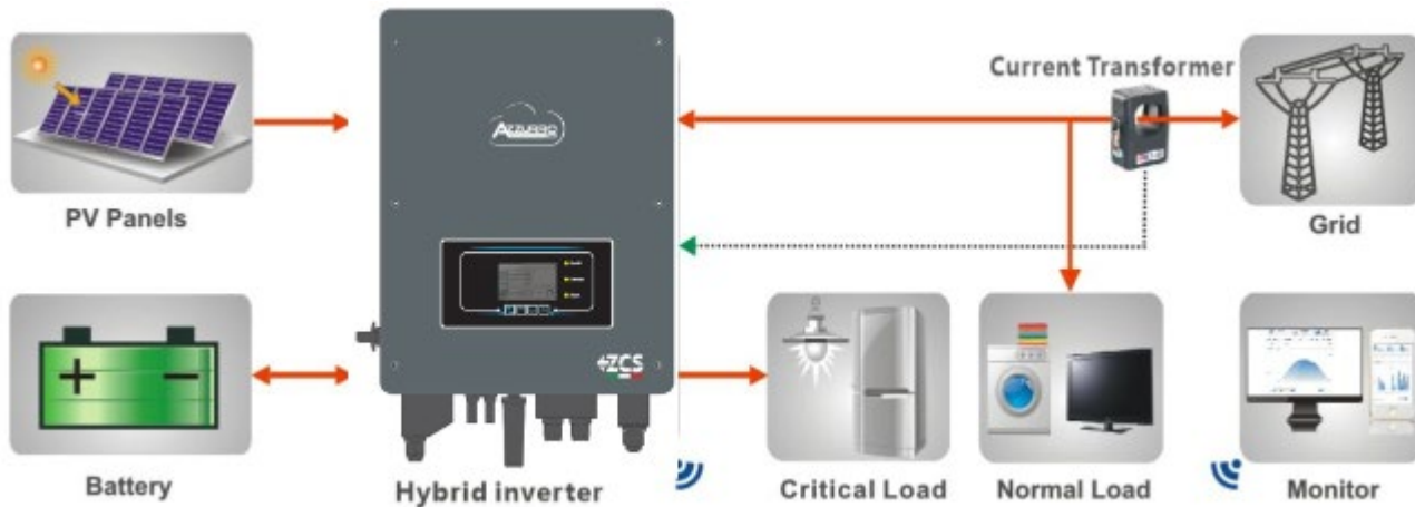
Рис.1 - Принципова схема установки з встановленим гібридним інвертором 1PH HYD3000-HYD6000-ZSS
