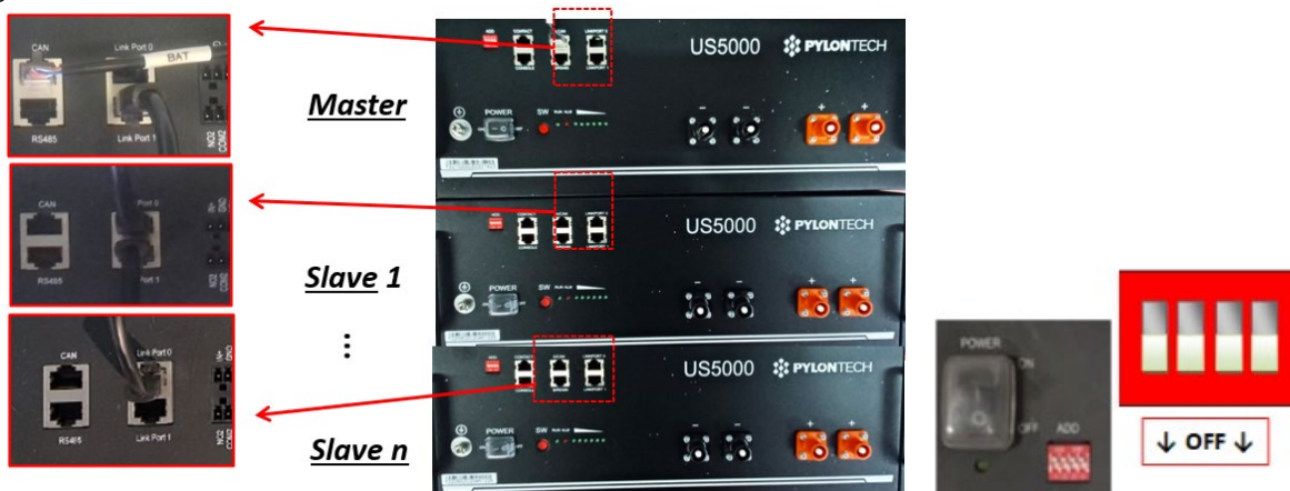
Рис.11 – Комунікаційні з'єднання між трьома акумуляторами Pylontech
