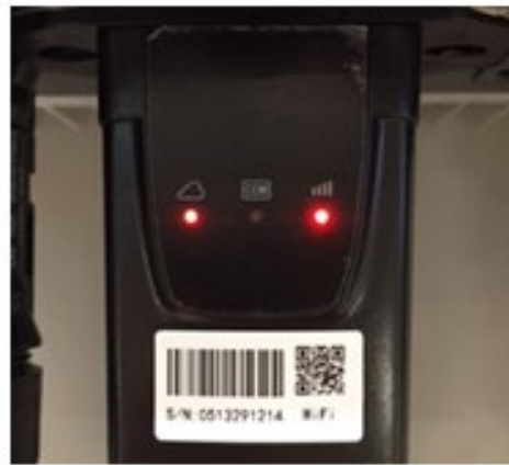
Рисунок 92 - Нестабільний стан зв'язку між інвертором та Wi-Fi
