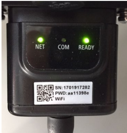
Рисунок 92 - Нестабільний стан зв'язку між інвертором та Wi-Fi
