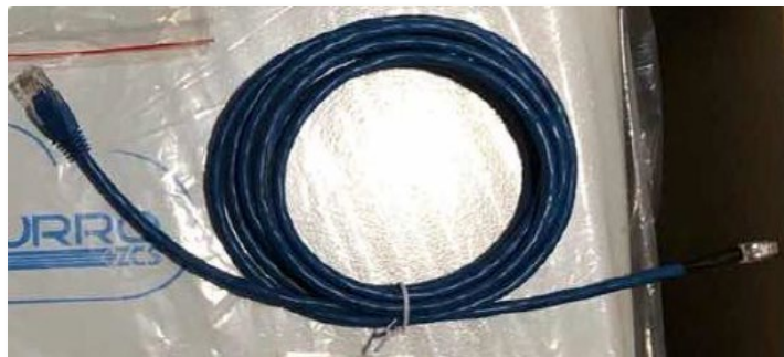
Рис.26 - Комунікаційний кабель між інвертором та акумулятором WeCo 5k3
