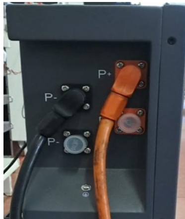
Рисунок 11 – Клемна плата акумулятора AZZURRO ZSX 5120
