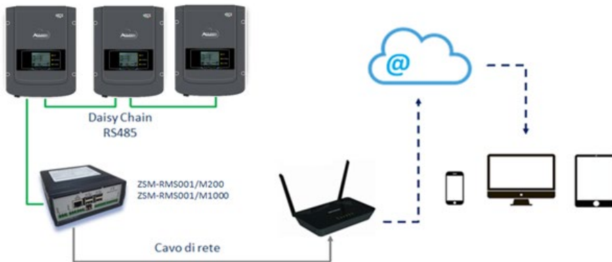
Рисунок 112 - Схема функціонування реєстратора даних ZSM-RMS001 / M200 / ZSM-RMS001 / M1000
