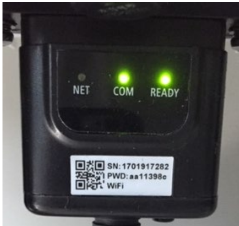
Рисунок 94 - Нестабільний стан зв'язку між Wi-Fi та віддаленим сервером
