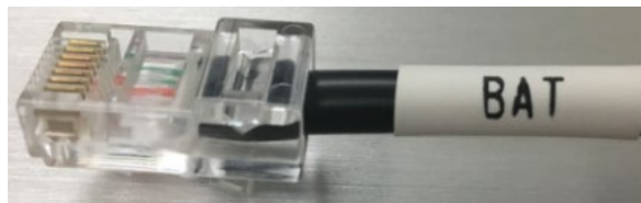
Рисунок 8 - Комунікаційний кабель Pylontech, що вставляється у вхід зв'язку акумуляторної батареї
