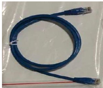
Рис.48 – Комунікаційний кабель між батареями AZZURRO 5000
