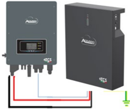
Рис. 48 - Підключення акумуляторної батареї AZZURRO ZSX 5120
