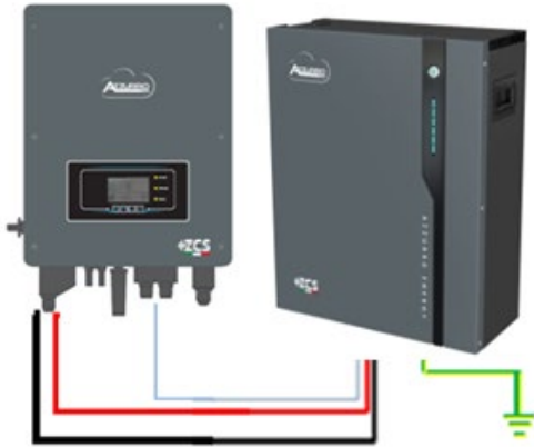
Рис. 45 - Підключення акумуляторної батареї AZZURRO 5000
