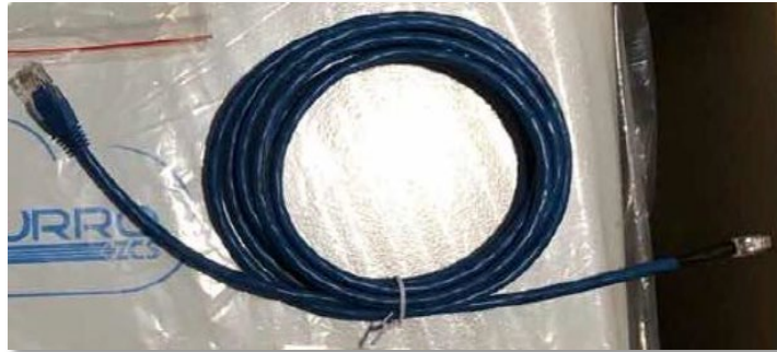
Рис.44 - Комунікаційний кабель між інвертором та акумулятором AZZURRO 5000 PRO
