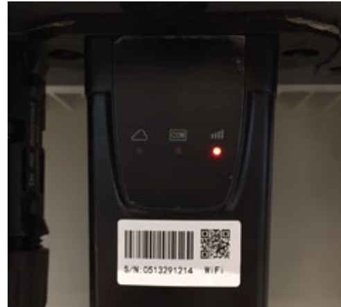
Рисунок 94 - Нестабільний стан зв'язку між Wi-Fi та віддаленим сервером
