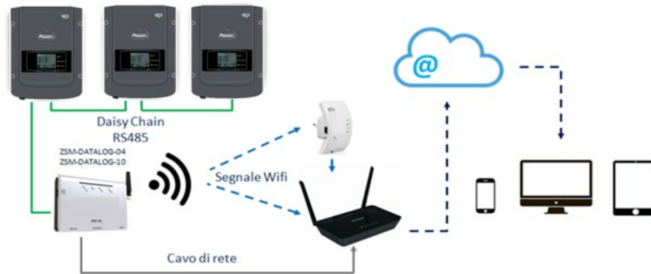
Рисунок 111 - Схема підключення реєстратора даних ZSM-DATALOG-04 / ZSM-DATALOG-10
