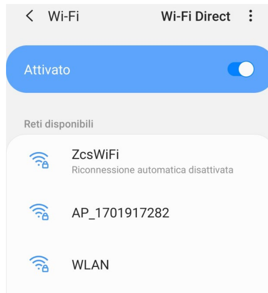
Рисунок 76 - Вимкнення автоматичного повторного підключення до мережі
