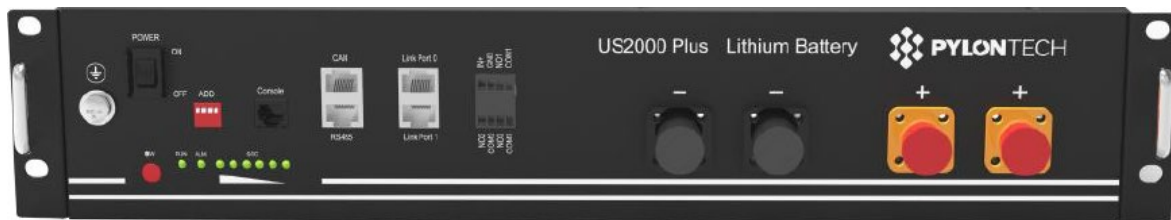
Abbildung 68 – Status der Batterie, nachdem der Schalter POWER auf AN geschaltet und die SW-Taste gedrückt wurde
