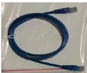
Abbildung 17- Kommunikationskabel zwischen WeCo-Batterien 4K4
