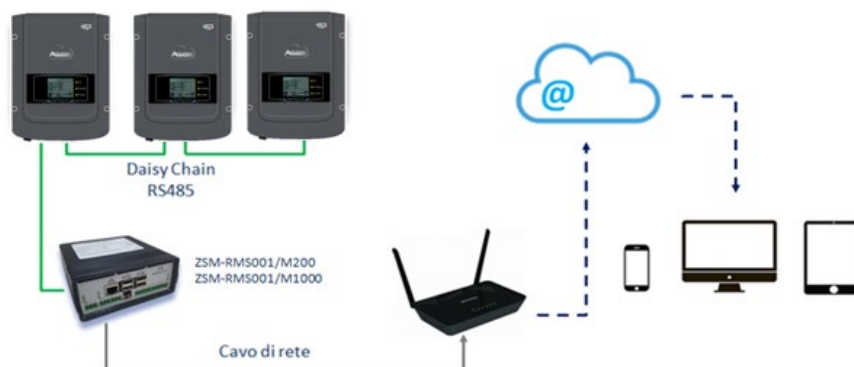
Abbildung 128 – Verbindungsschema des Datenloggers ZSM-RMS001/ M200 / ZSM-RMS001/M1000
