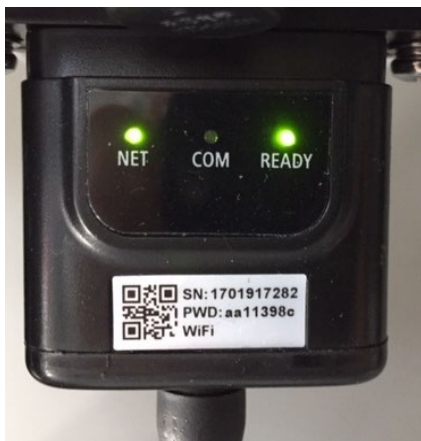
Abbildung 99 - Unregelmäßiger Kommunikationsstatus zwischen Inverter und WLAN
