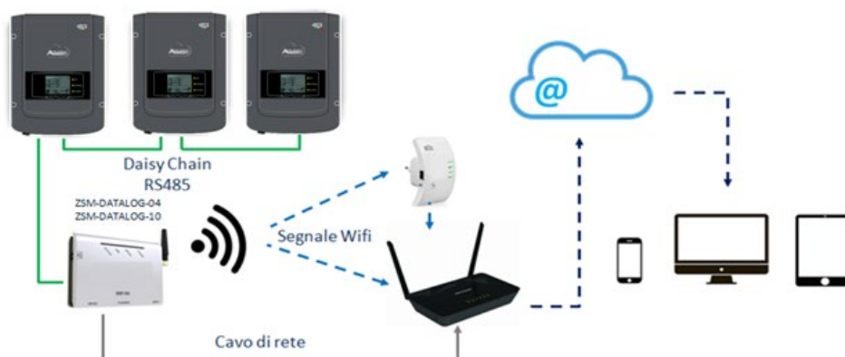
Abbildung 127 – Verbindungsschema des Datenloggers ZSM-DATALOG-04 / ZSM-DATALOG-10
