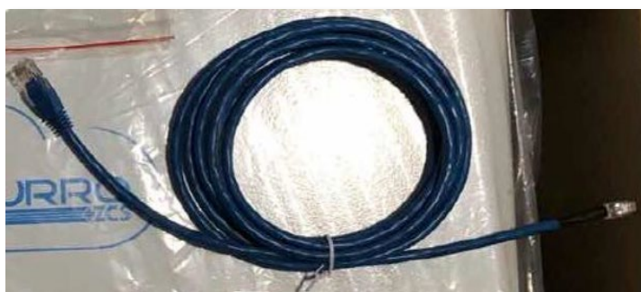
Abbildung 47 - Kommunikationskabel zwischen Inverter und Batterie AZZURRO 5000 PRO
