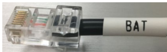
Abbildung 11 - Pylontech-Kommunikationskabel, Plug das in den Kommunikationseingang der Batterie einzustecken ist
