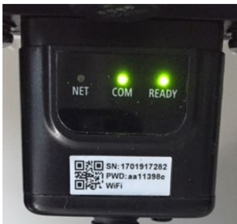
Abbildung 110 – Unregelmäßiger Kommunikationsstatus zwischen WLAN und Remote server
