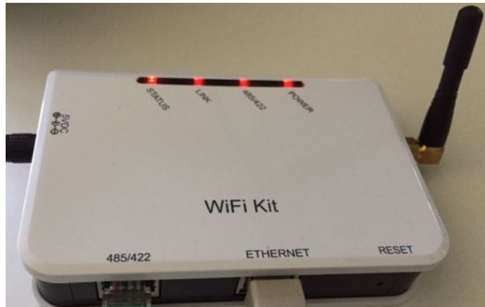
Abbildung 149 – Led, welche die korrekte Konfiguration des Datenloggers anzeigen
