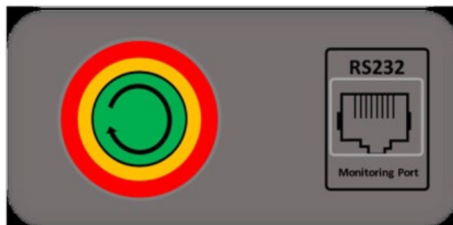
Abbildung 69 - Ansicht des Einschalters der WeCo-Batterie
