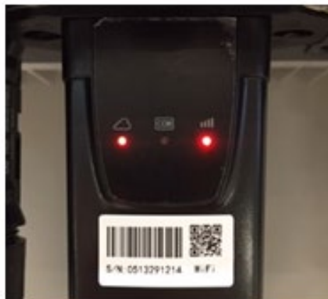
Abbildung 99 - Unregelmäßiger Kommunikationsstatus zwischen Inverter und WLAN
