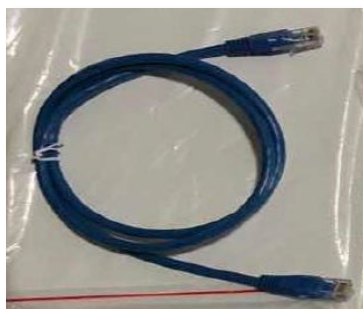
Figure 51 – Câble de communication entre batteries AZZURRO ZSX 5120
