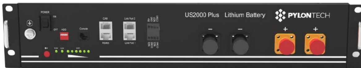
Figure 67 – État de la batterie après avoir positionné le commutateur POWER sur ON et appuyé sur le bouton SW
