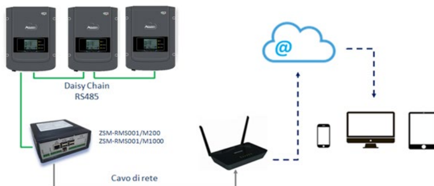
Figure 129 – Schéma fonctionnel du datalogger ZSM-RMS001/M200 / ZSM-RMS001/M1000
