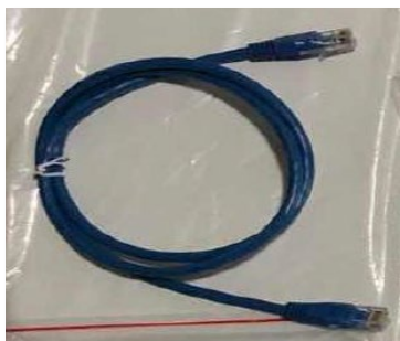
Figure 38 – Câble de communication entre batteries WeCo 5K3XP
