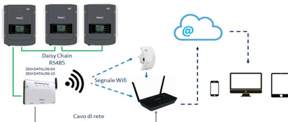
Figure 128 – Schéma de connexion du datalogger ZSM-DATALOG-04 / ZSM-DATALOG-10
