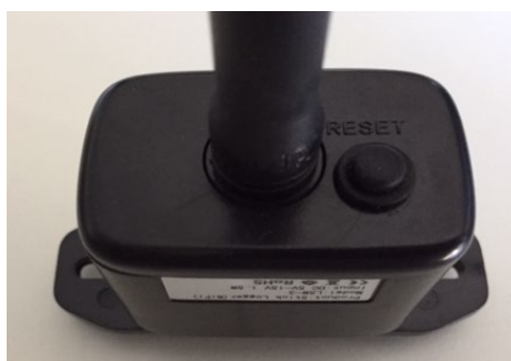
Figure 108 – Touche de réinitialisation sur la carte Wi-Fi
