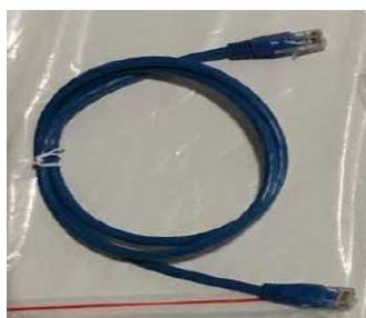
Figure 17 - Câble de communication entre batteries WeCo 4k4
