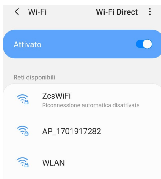
Figure 138 – Désactivation de la reconnexion automatique à un réseau
