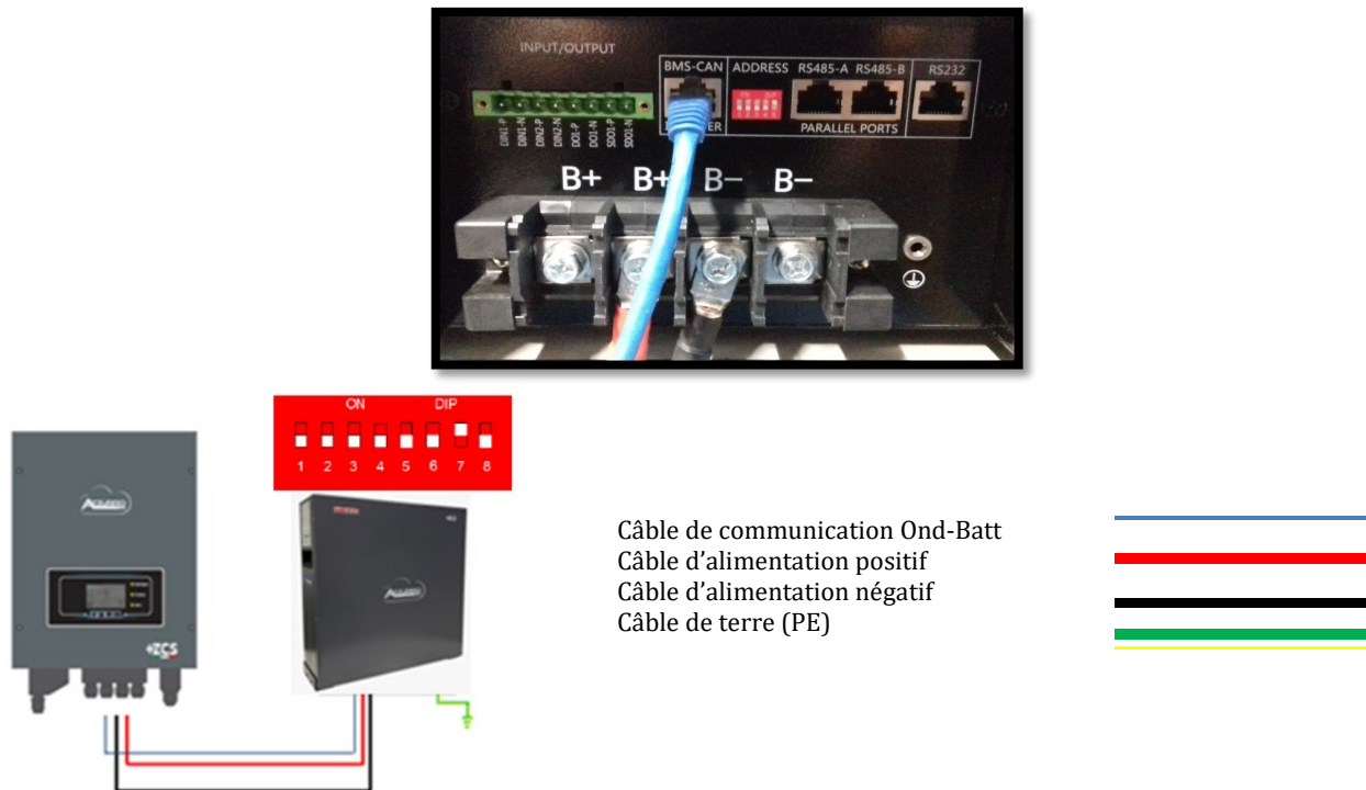
Figure 23 - Connexion de la batterie WeCo 4k4 PRO
