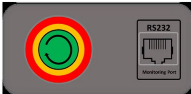
Figure 30 – Vue du bouton d'allumage de la batterie WeCo
