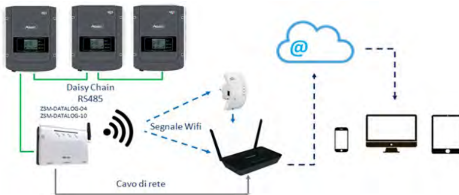
Рисунок 74 – Схема підключення реєстратора даних ZSM-DATALOG-04 / ZSM-DATALOG-10
