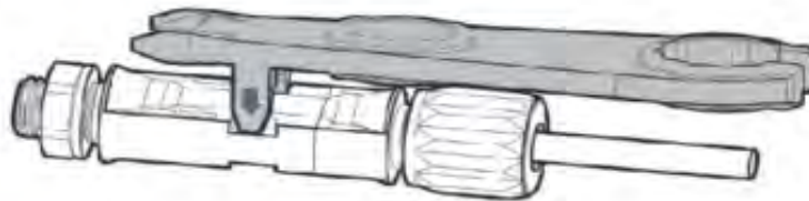
Рисунок 32 – Виймання роз'єму постійного струму
