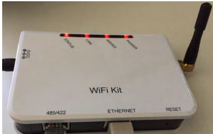
Рис. 95 – Світлодіоди, які вказують на правильну конфігурацію реєстратора даних
