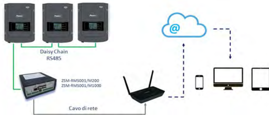
Рисунок 75 – Схема функціонування реєстратора даних ZSM-RMS001/M200 / ZSM-RMS001/M1000
