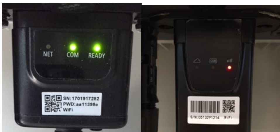
Abbildung 55 - Unregelmäßiger Kommunikationsstatus zwischen WLAN und Remote Server
