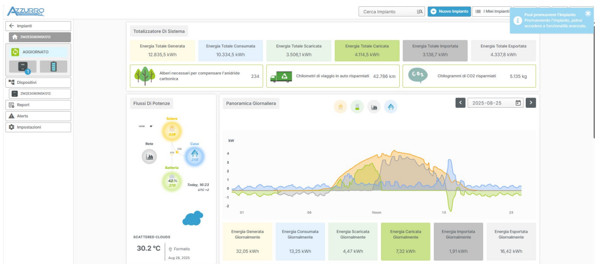
Abbildung 100 – Beispiel einer lokalen Überwachungsseite (Hybrid-Wechselrichter)
