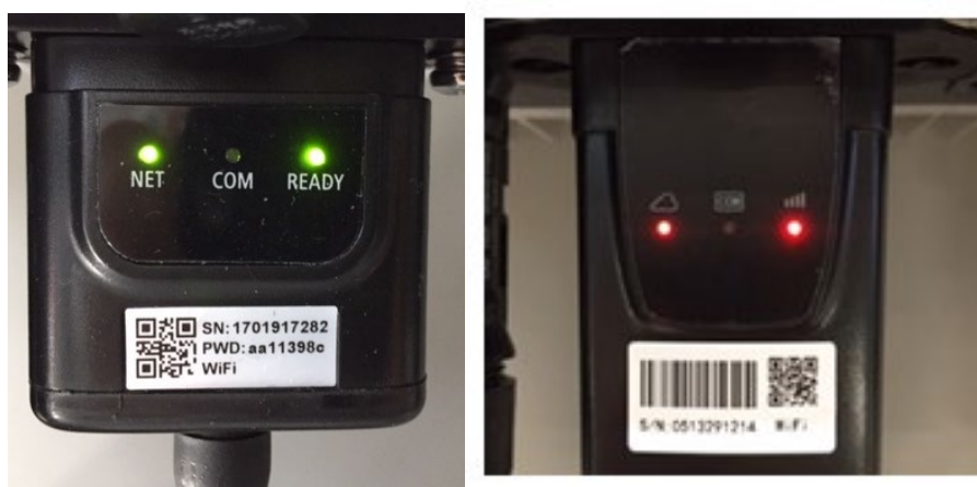
Figura 53 - Estado de comunicación irregular entre inversor y Wi-Fi
