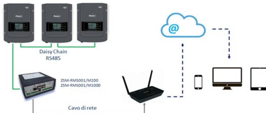
Figura 73 – Esquema que muestra el funcionamiento del datalogger ZSM-RMS001/M200 / ZSM-RMS001/M1000
