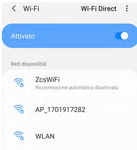
Figura 84 – Deshabilitación de la reconexión automática a una red
