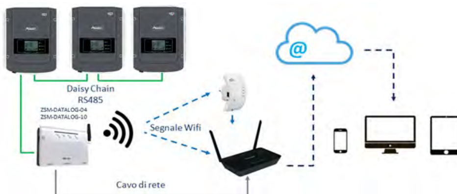
Figura 72 – Esquema para la conexión del datalogger ZSM-DATALOG-04 / ZSM-DATALOG-10
