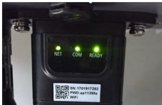
Figura 69 - Estado final de los LED
