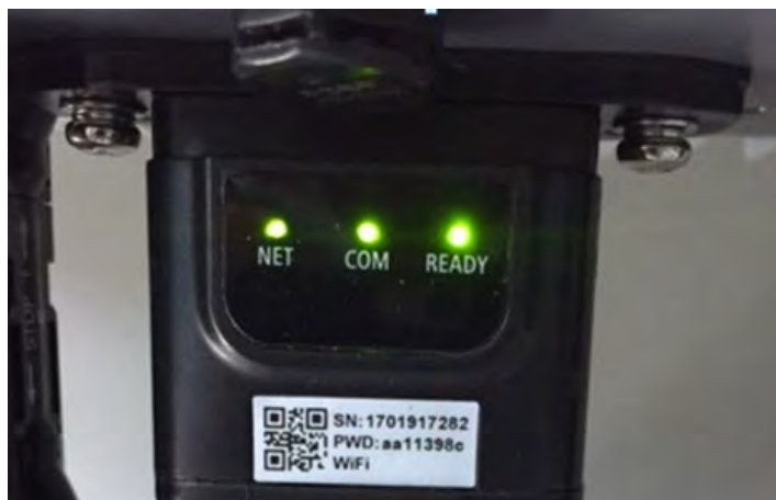
Figura 63 - Estado final de los LED
