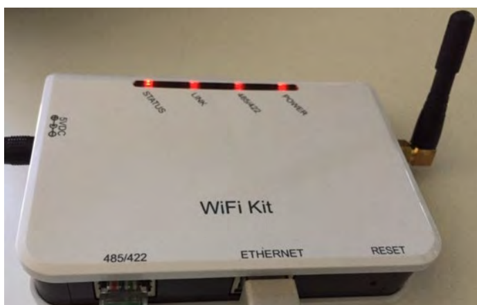
Figura 95 – LED que indica que el datalogger está configurado correctamente
