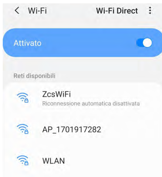
Figura 37 - Deshabilitación de la reconexión automática a una red
