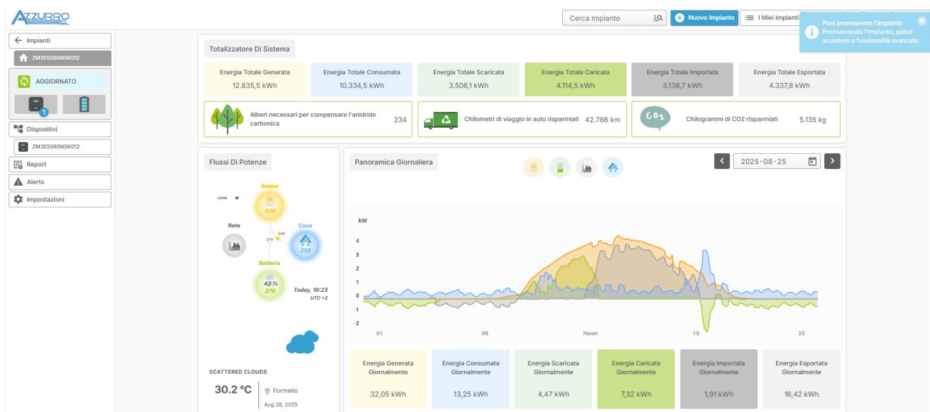
Figure 100 – Exemple de page de surveillance locale (onduleur hybride)
