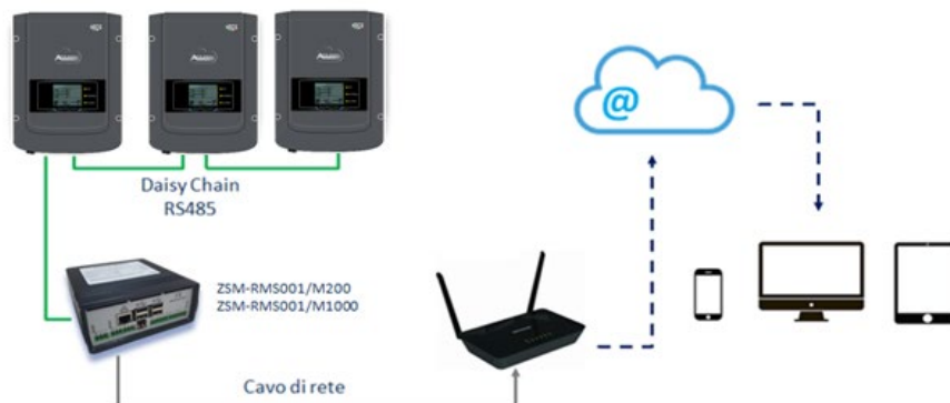
Figure 73 – Schéma illustrant le fonctionnement du datalogger ZSM-RMS001/M200 / ZSM-RMS001/M1000
