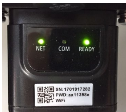
Figure 70 – État de communication irrégulière entre onduleur et adaptateur
