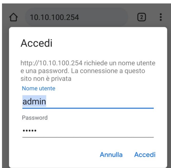
Figure 42 – Page d'accès au serveur Web pour configurer l'adaptateur Wi-Fi
