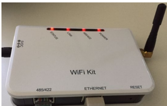
Figure 95 – LED qui indique la configuration correcte du datalogger
