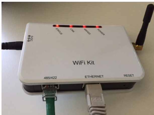
Figure 82 – Câble Ethernet connecté au datalogger
