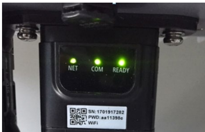
Figure 63 – État final des LED
