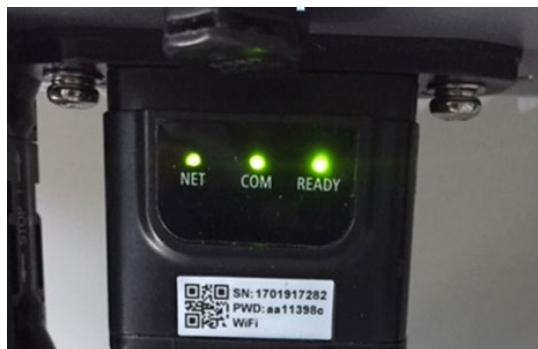
Figure 69 – État final des LED
