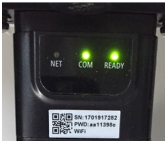
Figure 65 – État de communication irrégulière entre adaptateur et serveur à distance
