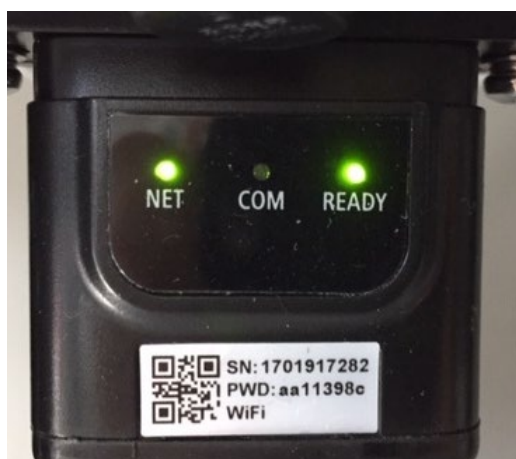
Figure 64 – État de communication irrégulière entre onduleur et adaptateur
