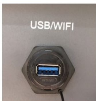
Rysunek 34– Port do zewnętrznego adaptera Wi-Fi
