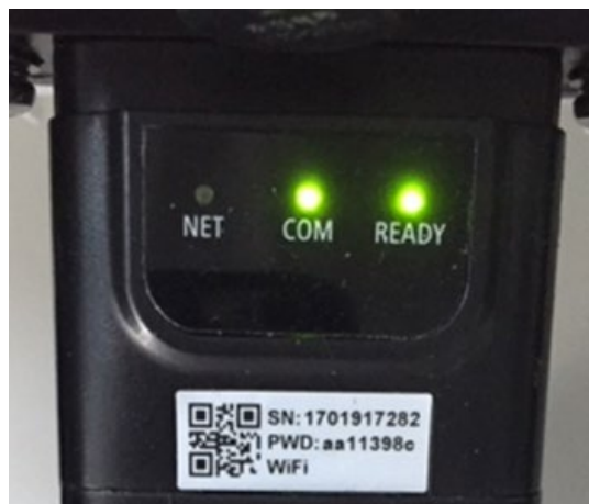
Rysunek 65 - Nieprawidłowy stan komunikacji pomiędzy adapterem i zdalnym serwerem
