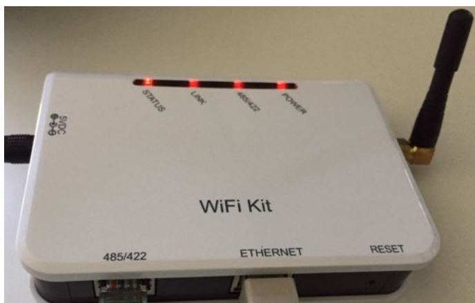
Rysunek 95 – Diody LED wskazujące prawidłową konfigurację rejestratora danych
