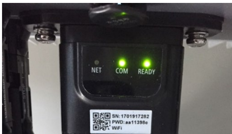
Rysunek 62 - Stan początkowy diod ledowych
