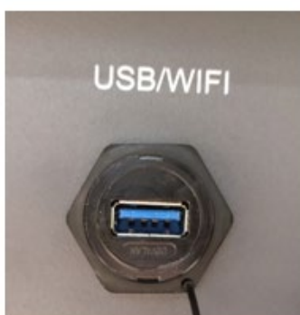
Rysunek 58 – Port adaptera Ethernet
