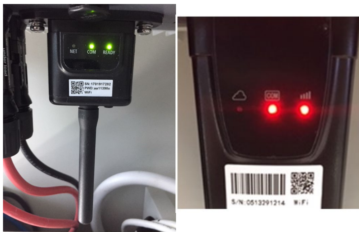
Rysunek 50 - Stan początkowy diod ledowych
