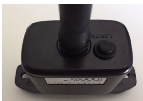
Rysunek 52 – Przycisk resetowania na adapterze Wi-Fi
