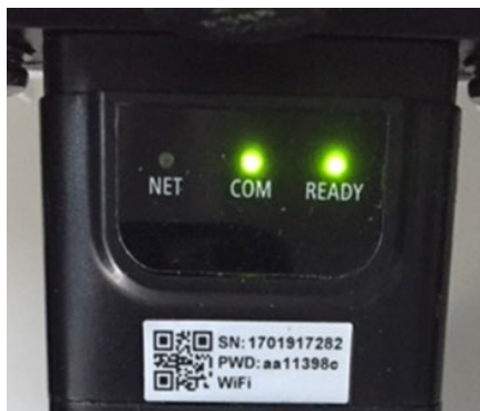
Rysunek 71 - Nieprawidłowy stan komunikacji pomiędzy adapterem i zdalnym serwerem
