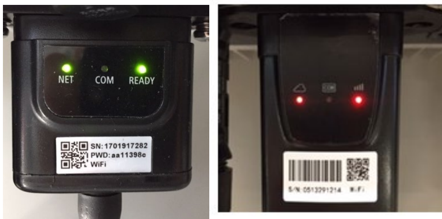
Рисунок 53 - Нестабільний стан зв'язку між інвертором та Wi-Fi
