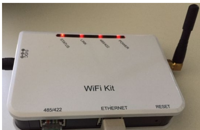
Рисунок 95 – Світлодіод, який вказує на правильне налаштування реєстратора даних
