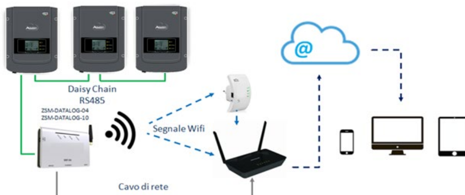
Рисунок 72 – Схема підключення реєстратора даних ZSM-DATALOG-04 / ZSM-DATALOG-10
