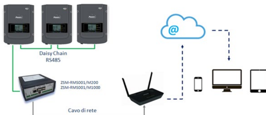
Рисунок 73 – Схема функціонування реєстратора даних ZSM-RMS001/M200 / ZSM-RMS001/M1000
