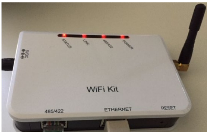
Рисунок 101 – Світлодіоди, які вказують на правильну конфігурацію реєстратора даних
