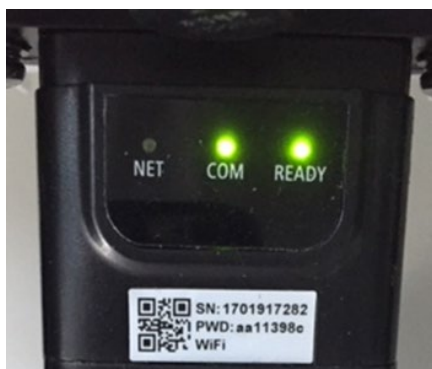
Рисунок 79 - Нестабільний стан зв'язку між адаптером та віддаленим сервером
