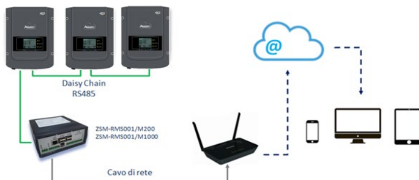
Рисунок 81 - Схема функціонування реєстратора даних ZSM-RMS001 / M200 / ZSM-RMS001 / M1000
