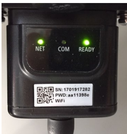
Рисунок 62 - Нестабільний стан зв'язку між інвертором та Wi-Fi
