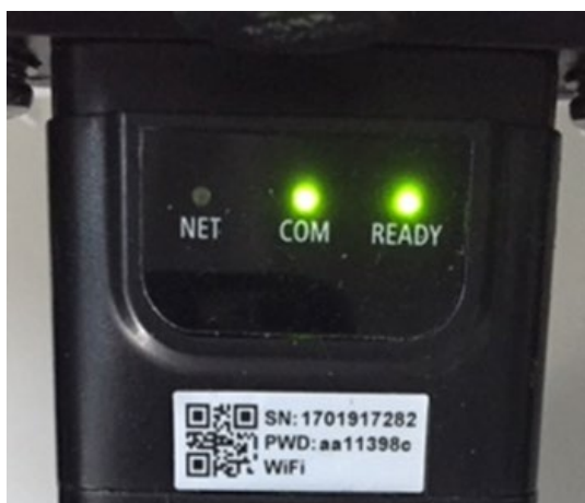
Рисунок 73 - Нестабільний стан зв'язку між адаптером та віддаленим сервером
