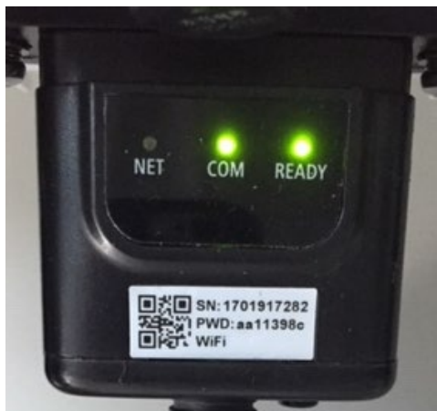
Рисунок 64 - Нестабільний стан зв'язку між Wi-Fi та віддаленим сервером
