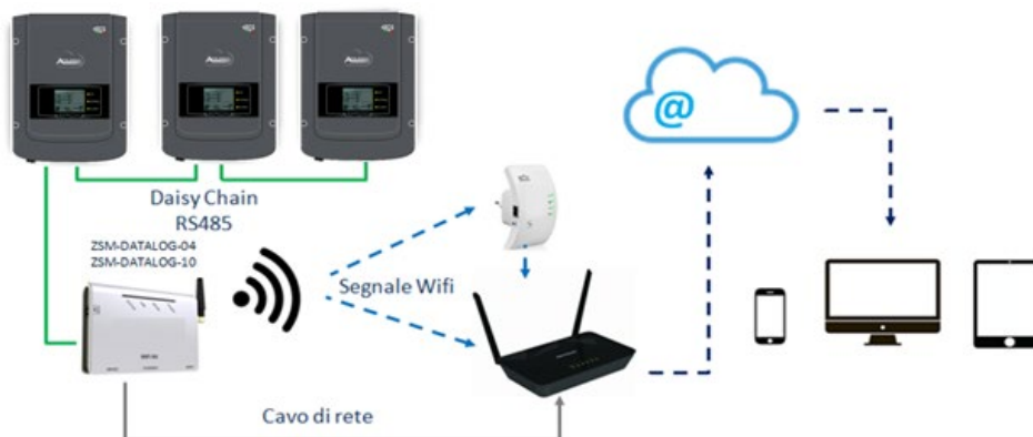
Рисунок 80 - Схема підключення реєстратора даних ZSM-DATALOG-04 / ZSM-DATALOG-10
