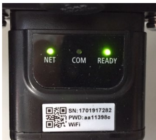
Рисунок 72 - Нестабільний стан зв'язку між інвертором та адаптером
