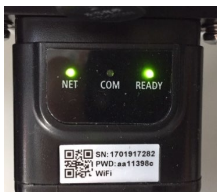
Рисунок 78 - Нестабільний стан зв'язку між інвертором та адаптером
