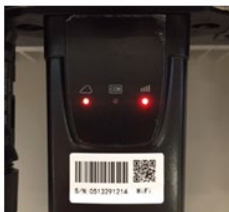
Рисунок 62 - Нестабільний стан зв'язку між інвертором та Wi-Fi
