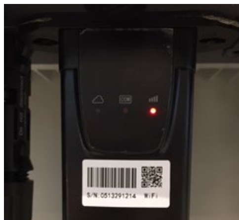
Рисунок 64 - Нестабільний стан зв'язку між Wi-Fi та віддаленим сервером
