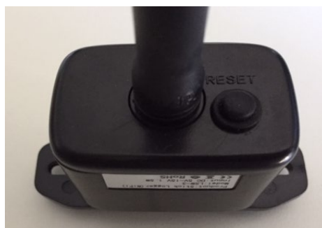
Рисунок 61 - Кнопка скидання на адаптері Wi-Fi
