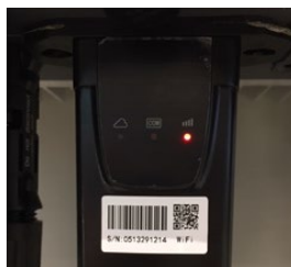
Abbildung 5-54 – Unregelmäßiger Kommunikationsstatus zwischen WLAN und Remote-Server
