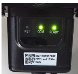
Abbildung 5-54 – Unregelmäßiger Kommunikationsstatus zwischen WLAN und Remote-Server
