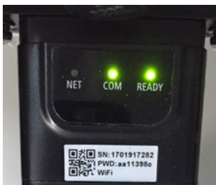
Abbildung 5-63 – Unregelmäßiger Kommunikationsstatus zwischen Adapter und Remote-Server
