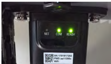
Figura 5-61: Estado inicial de los LED
