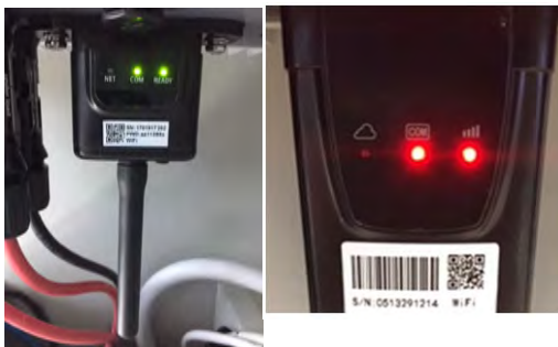
Figura 5-51: Estado inicial de los LED
