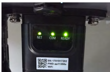
Figure 5-59 - État final des LED
