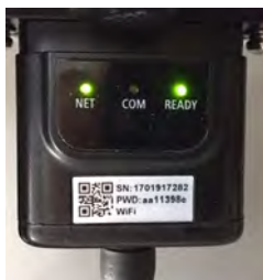
Figure 5-52 - État de communication irrégulier entre le variateur et le Wi-Fi
