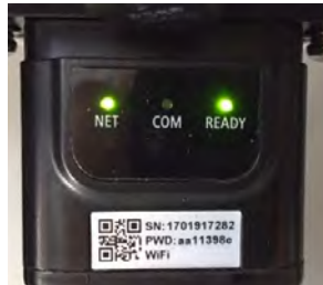
Figure 5-62 - État de communication irrégulier entre le variateur et l'adaptateur
