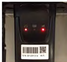
Figure 5-52 - État de communication irrégulier entre le variateur et le Wi-Fi
