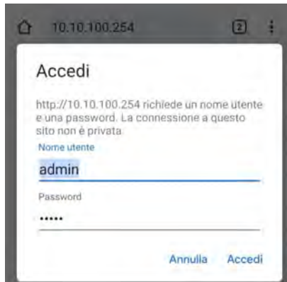
Figure 5-44 – Écran permettant d'accéder au serveur Web pour configurer l'adaptateur Wi-Fi
