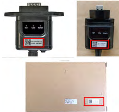
Figure 5-41 – Mot de passe de l'adaptateur Wi-Fi externe
