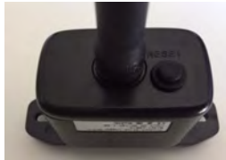
Figure 5-52 - Bouton Reset sur l'adaptateur Wi-Fi
