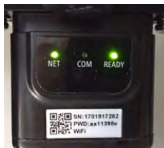
Rysunek 5-59 – Nieregularny stan komunikacji między falownikiem a adapterem
