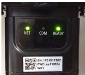
Rysunek 5-62 – Nieregularny stan komunikacji między falownikiem a adapterem
