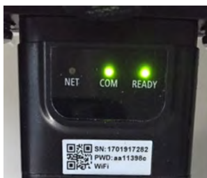
Rysunek 5-60 — Nieregularny stan komunikacji między adapterem a serwerem zdalnym
