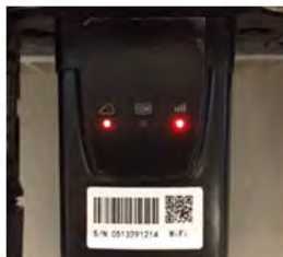
Rysunek 5-52 – Nieregularny stan komunikacji między falownikiem a siecią Wi-Fi
