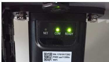
Figura 5-59: Estado inicial de los LED
