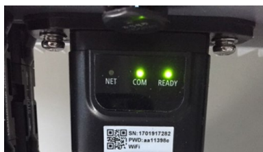
Figura 5-61: Estado inicial de los LED
