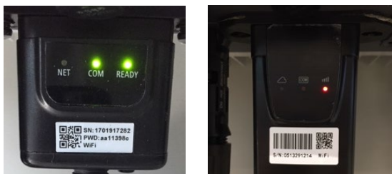
Figura 5-54 - Estado de comunicación irregular entre Wi-Fi y el servidor remoto
