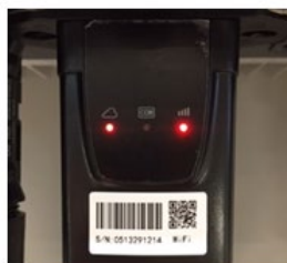
Figura 5-52 - Estado de comunicación irregular entre el inversor y la Wi-Fi
