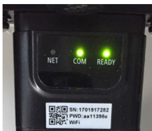
Figura 5-60 - Estado de comunicación irregular entre el adaptador y el servidor remoto
