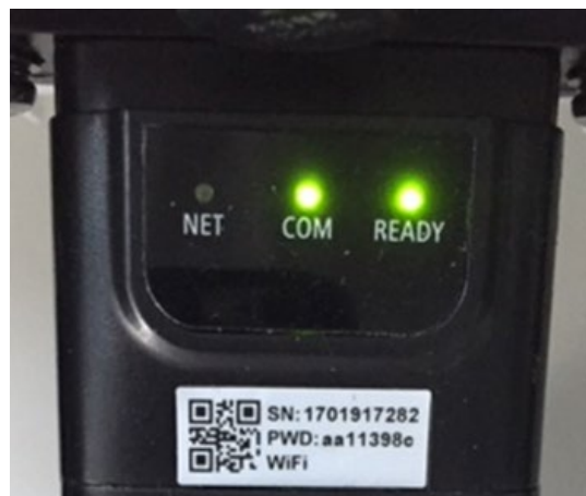
Figura 104 – Stato di comunicazione irregolare tra adattatore e server remoto
