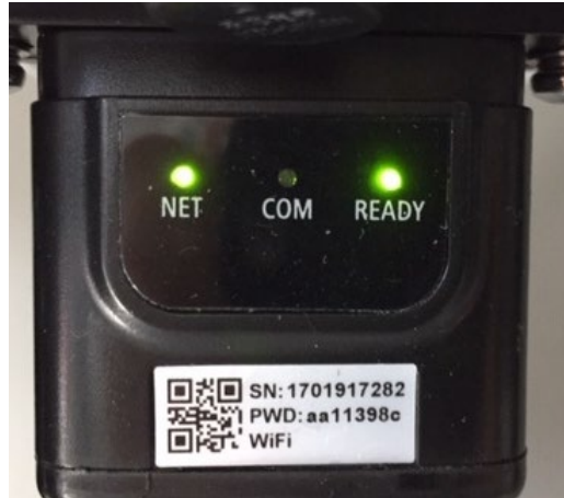
Figura 103 – Stato di comunicazione irregolare tra inverter e adattatore
