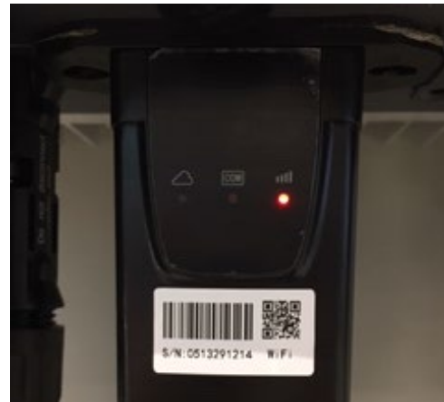
Figura 94 – Stato di comunicazione irregolare tra WiFi e server remoto
