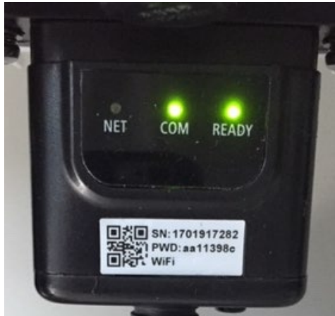
Figura 94 – Stato di comunicazione irregolare tra WiFi e server remoto
