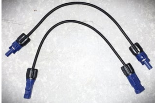
Рис. 144 - Кабелі зв'язку між BDU та першим модулем батареї
