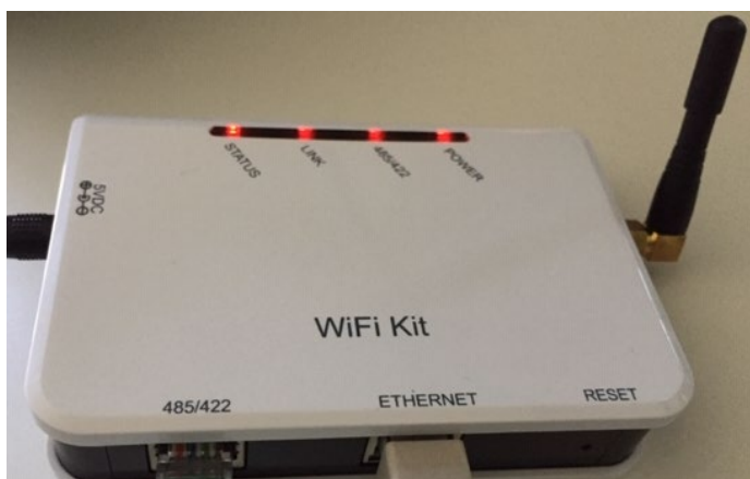
Рис. 240 – Світлодіоди, які вказують на правильну конфігурацію реєстратора даних
