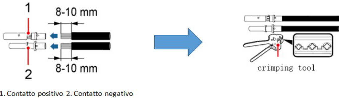
Рис. 20 - Підготовка позитивних та негативних кабелів фотоелектричної системи
