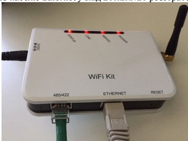
Рис. 227 – Кабель Ethernet, підключений до реєстратора даних
