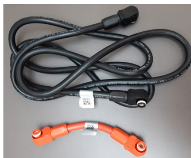
Рис. 43 - Кабелі зв'язку між BMS та модулями акумуляторів
