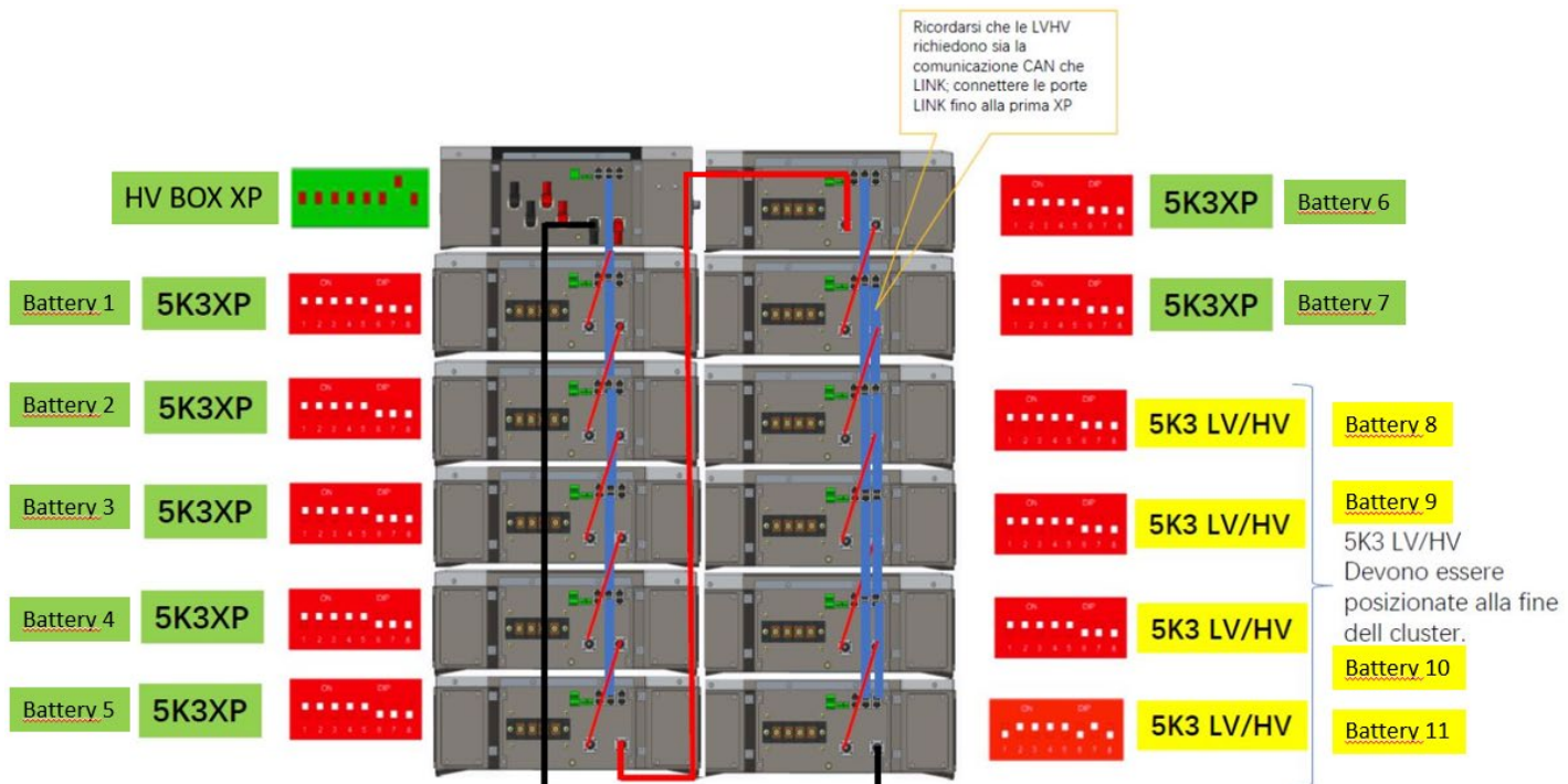
Рисунок 112 - Підключення живлення та зв'язок з акумуляторною батареєю 5K3 та 5K3XP
