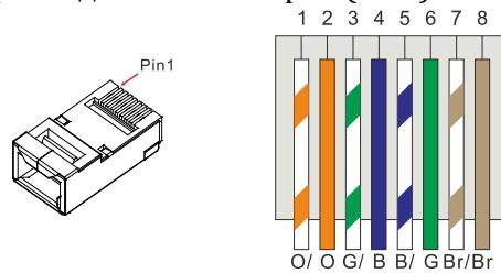
Рисунок 24 - Виводи порту COM-OUT розподільчої коробки
