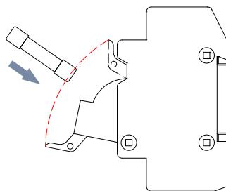
Рисунок 27 - Заміна запобіжника
