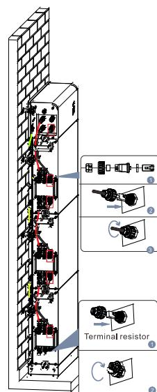
Рисунок 17 - Підключення внутрішніх сигнальних кабелів
