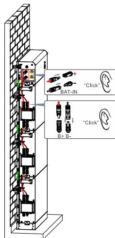
Рисунок 16 - Підключення внутрішніх кабелів живлення
