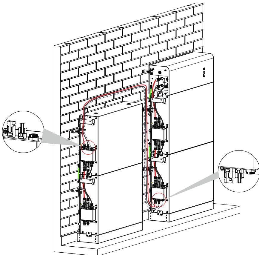
Рисунок 18 - Установка вузла акумуляторної батареї на 20 кВт·год
