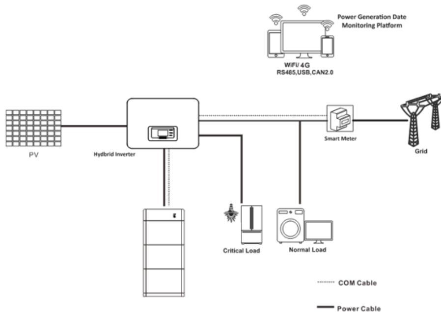
Рисунок 3 - Принципова схема BLUE ZZT-ZBT5K-ES5 ~ ES20
