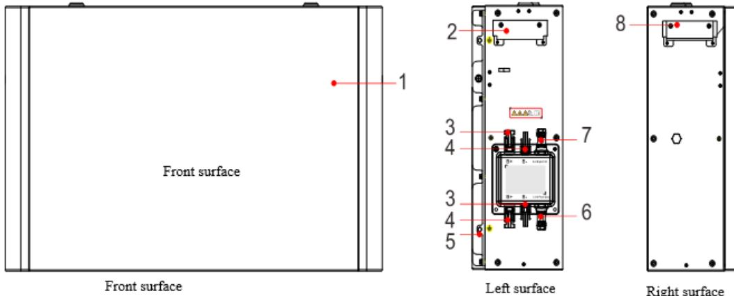
Рисунок 6 - Схема портів акумуляторного модуля
