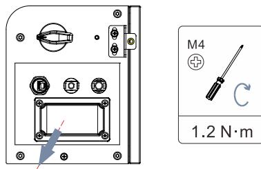
Рисунок 26 - Зняття зовнішньої кришки запобіжника
