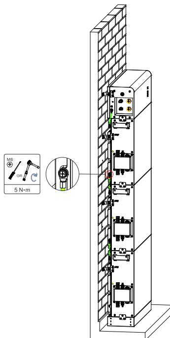
Рисунок 15 - Підключення кабелю заземлення
